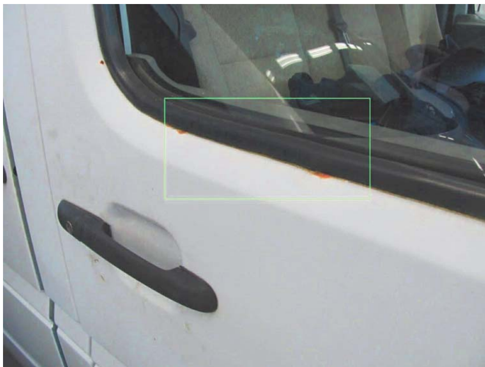
Bild 10 : Gesamtfahrzeug Diverse Korrosionen / Restpuren Nachlackierungen / Nahabdichtung gerissen
