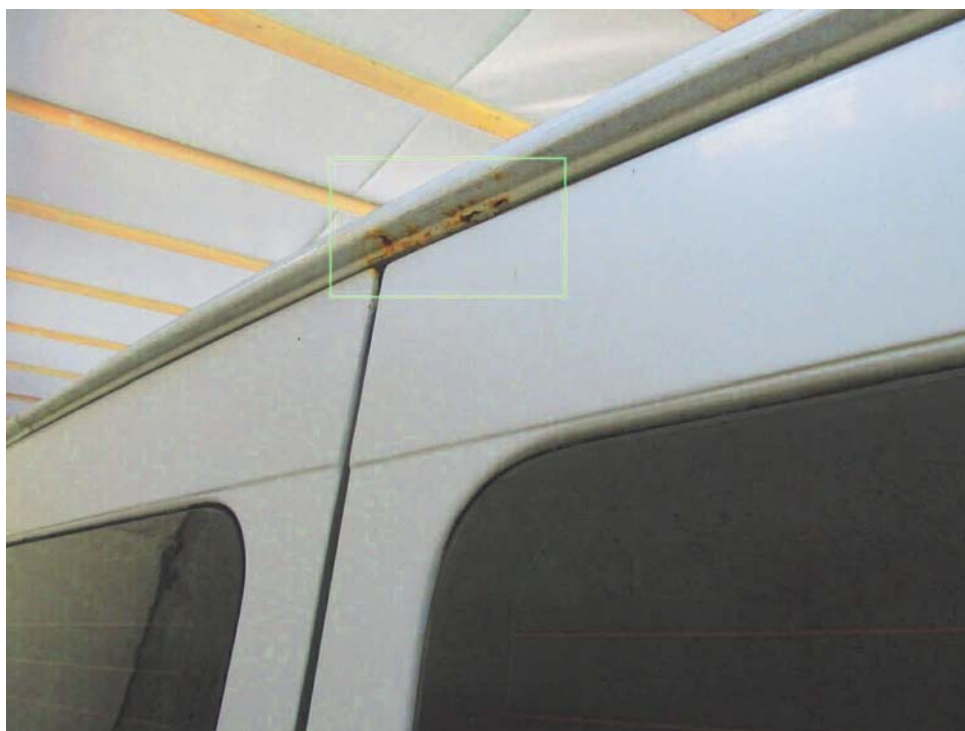
Bild 11 : Gesamtfahrzeug Diverse Korrosionen / Restpuren Nachlackierungen / Nahabdichtung gerissen
