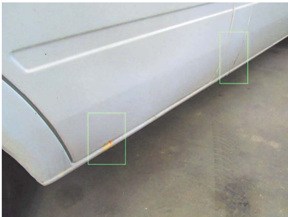
Bild 8 : Gesamtfahrzeug Diverse Korrosionen / Restpuren Nachlackierungen / Nahabdichtung gerissen
