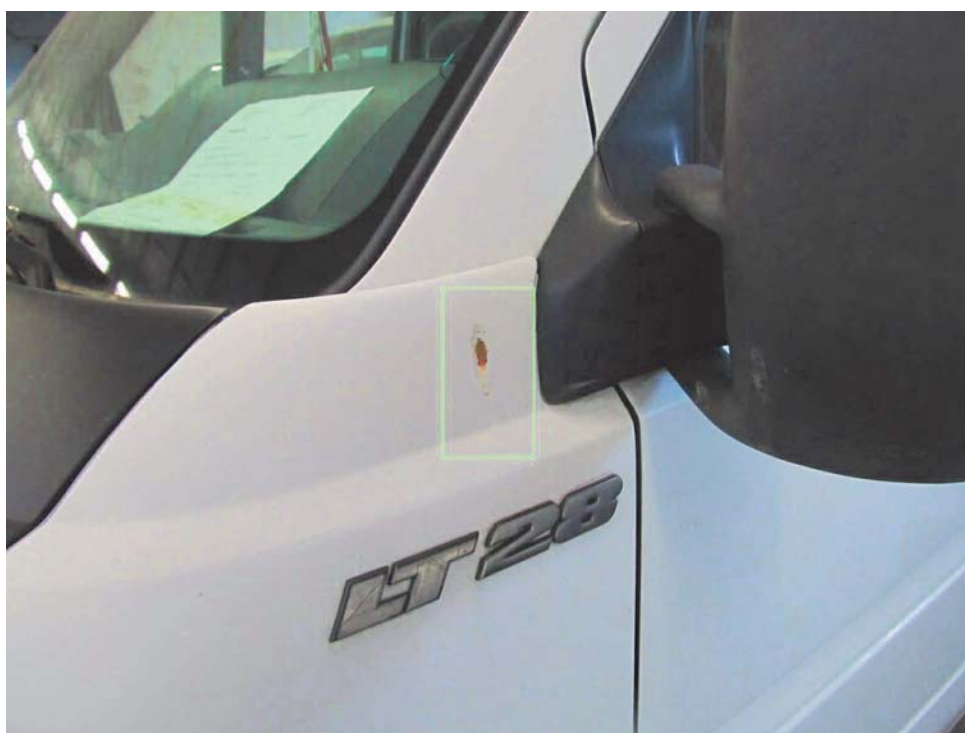
Bild 7 : Gesamtfahrzeug Diverse Korrosionen / Restpuren Nachlackierungen / Nahabdichtung gerissen
