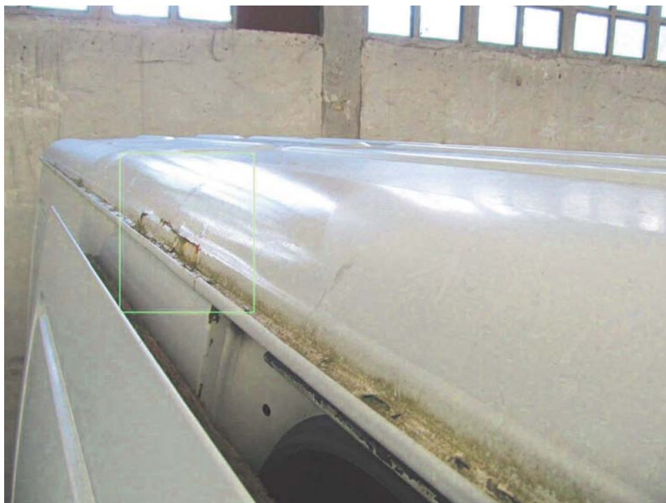
Bild 6 : Gesamtfahrzeug Diverse Korrosionen / Restpuren Nachlackierungen / Nahabdichtung gerissen
