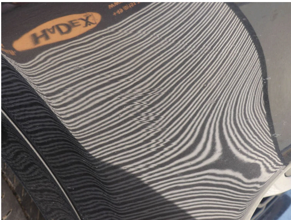
Bild: 64 Detailansicht Frontverkleidung, diese ist rechtsseitig nachlackiert.
