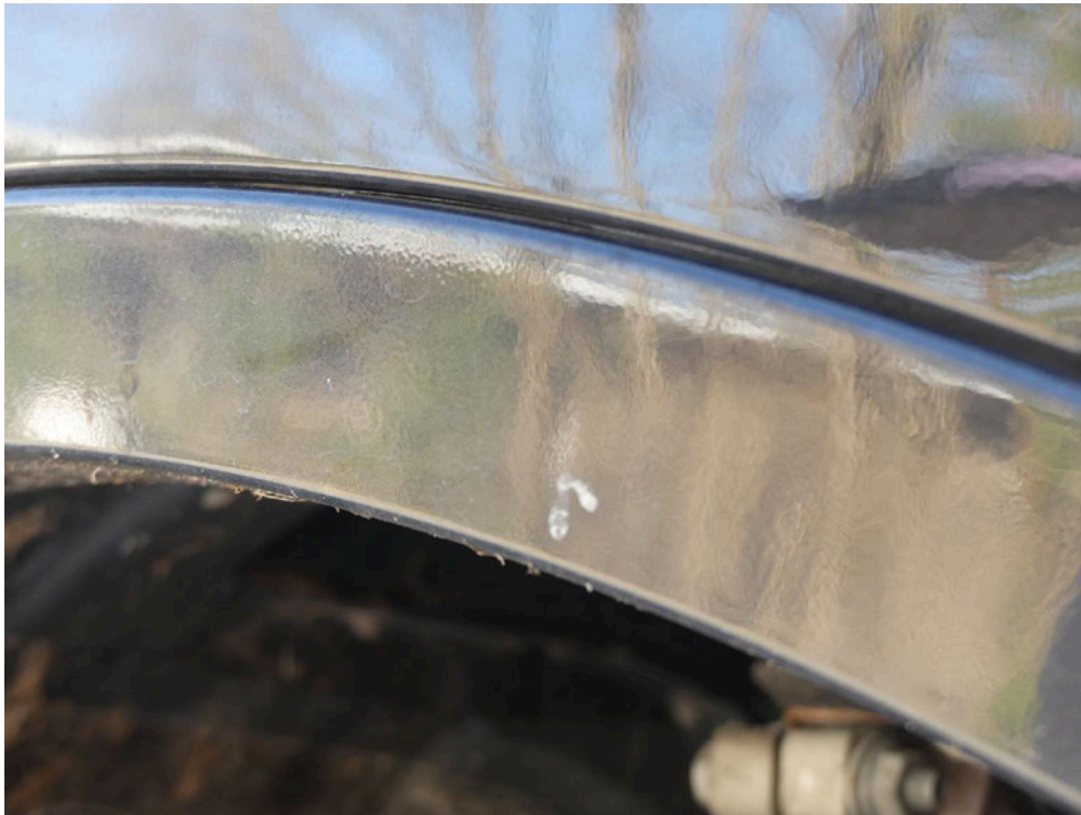
Bild: 65 Einzeldarstellung Radlauchblende vorn rechts, diese ist nachlackiert, ein Qualitätsdefizit ist erkennbar.
