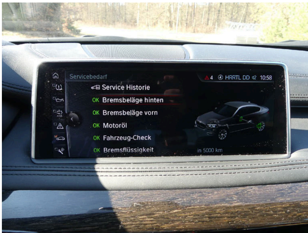
Bild: 42 Ausweisung Fahrzeugstatus Kombiinstrument
