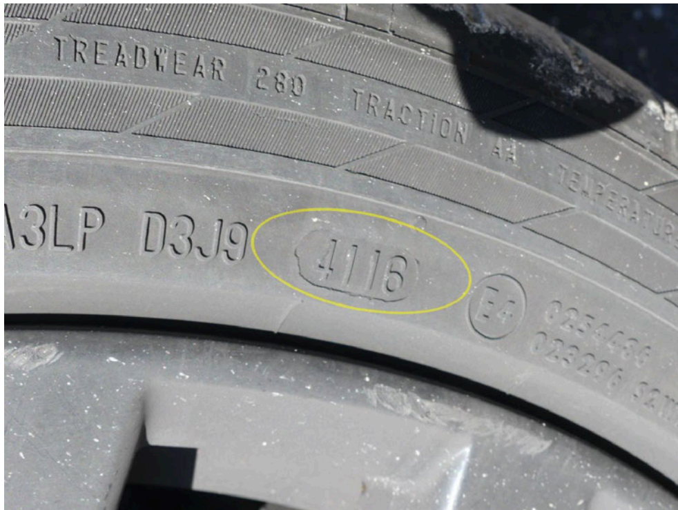
Bild: 19 Ausweisung der DOT Nummer der Radialreifen vorn
