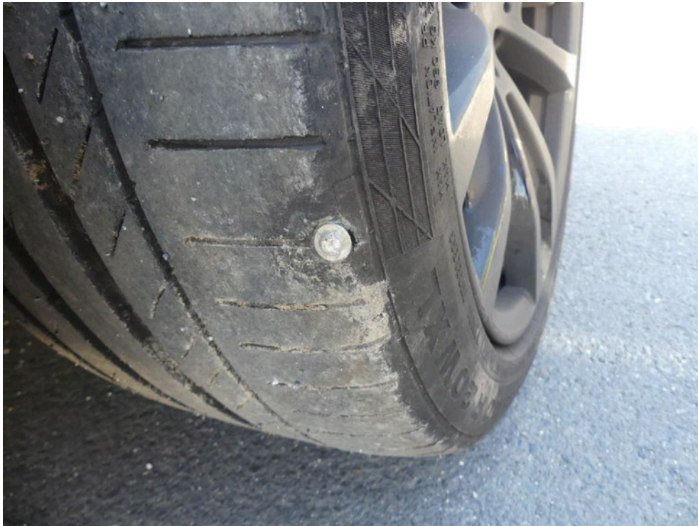
Bild: 31 Der Radialreifen vorn rechts ist durch einfahren ein Schraube beschädigt - Druckverlust wird durch das Überwachungssystem angezeigt.
