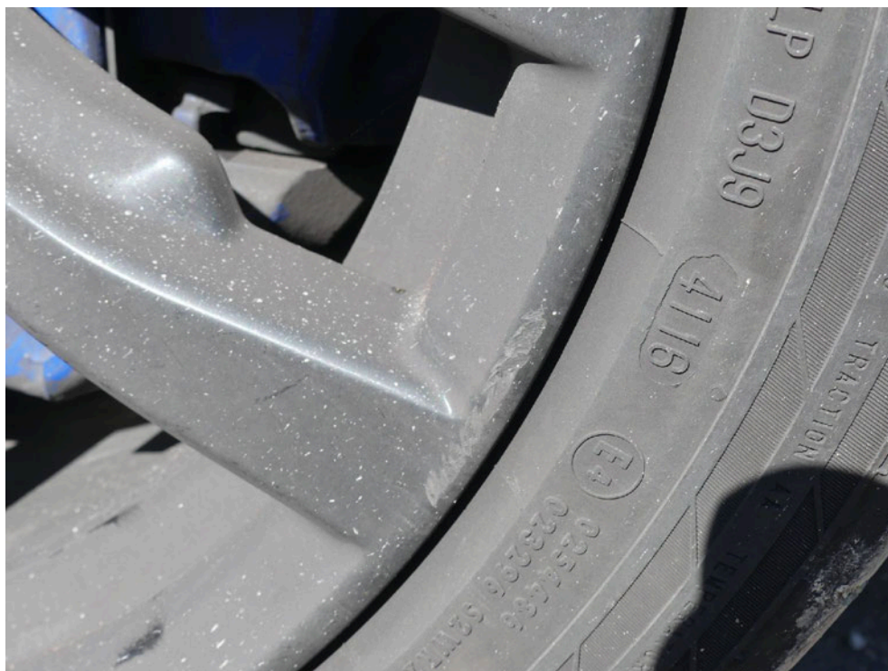
Bild: 20 LM-Felge vorn links farblich ausgebleicht.
