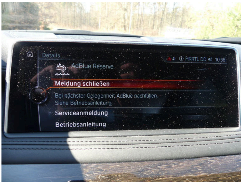
Bild: 40 Ausweisung Hinweis - Fehlermeldung Kombiinstrument
