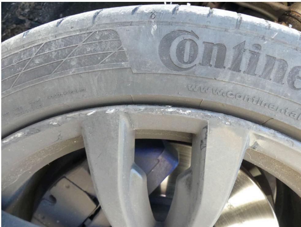
Bild: 30 ... ist ebenso mehrfach im Grundmaterial beschädigt/abgetragen.
