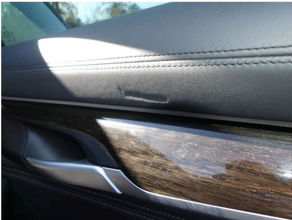
Bild: 52 Detailansicht Türverkleidung hinten rechts, diese ist partiell gestaucht/ eingedrückt.
