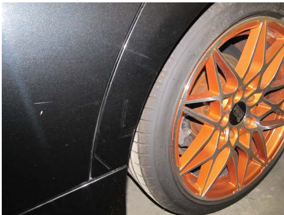
Bild 7 : Seitenteil hinten links Lackierung, zerkratzt, lackieren mit Lackaufbau
