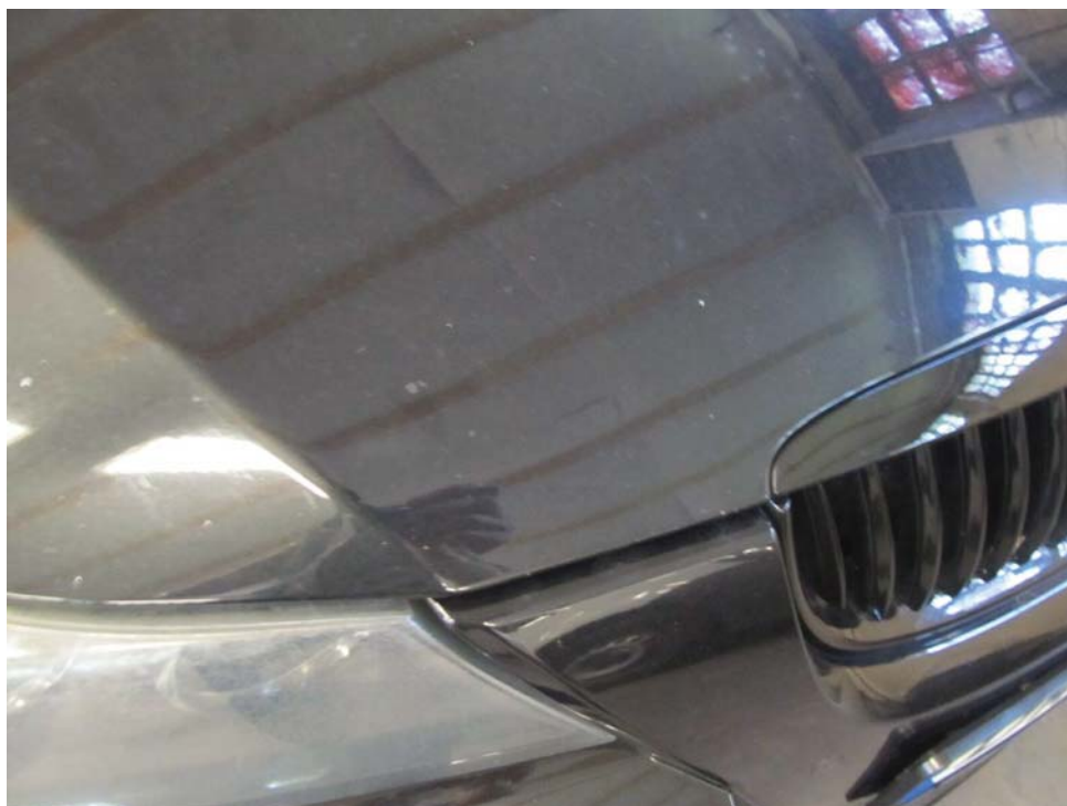
Bild 9 : Motorhaube Lackierung, viele Steinschläge, lackieren mit Lackaufbau
