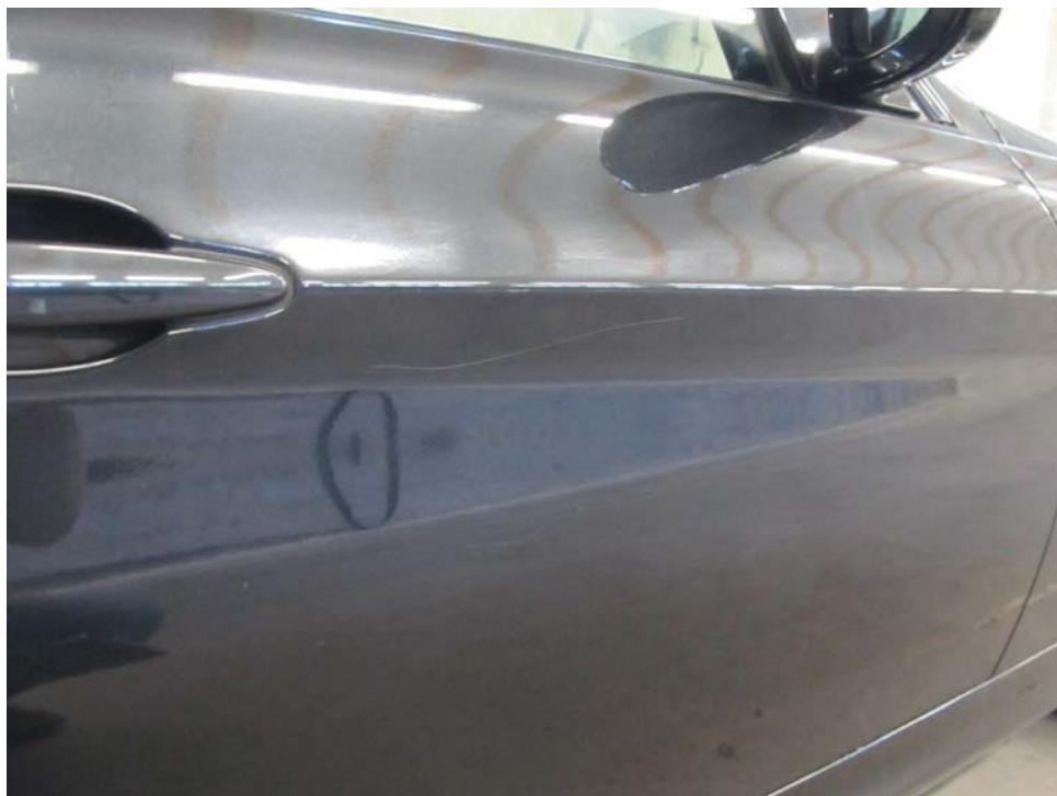
Bild 8 : Tür vorne rechts Lackierung, zerkratzt, lackieren mit Lackaufbau
