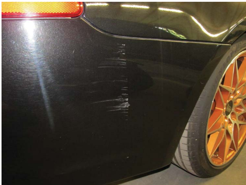
Bild 6 : Stoßfänger hinten Lackierung, zerkratzt, lackieren mit Lackaufbau
