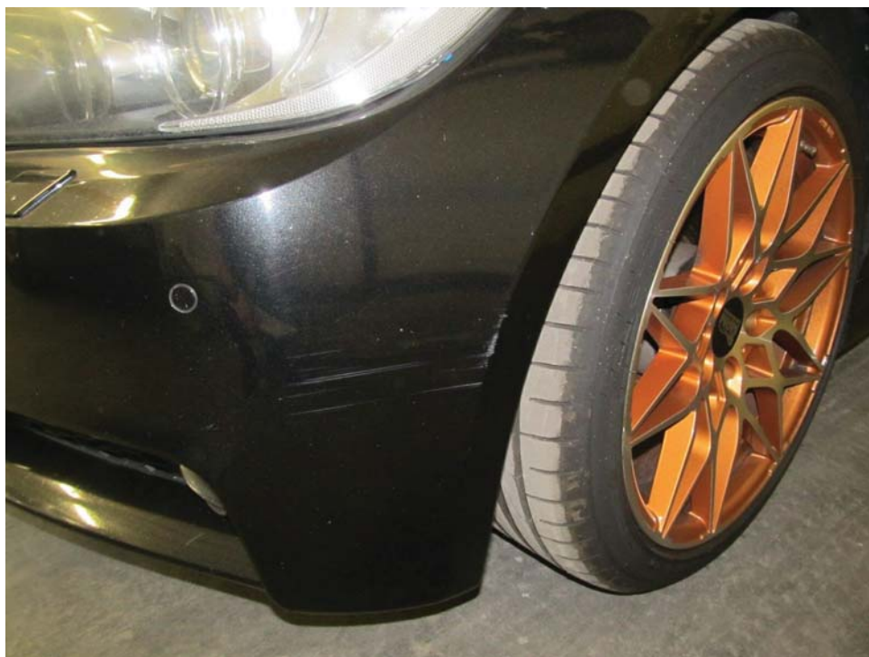
Bild 5 : Stoßfänger vorne Lackierung, zerkratzt, lackieren mit Lackaufbau
