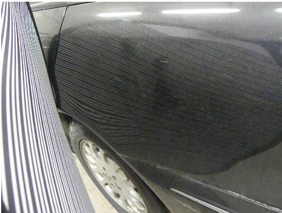
Bild: 60 Oberflächenverlauf unruhig
