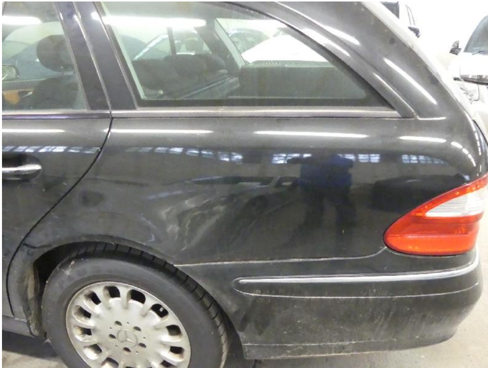
Bild: 59 Seitenwand links instandgesetzt und lackiert.
