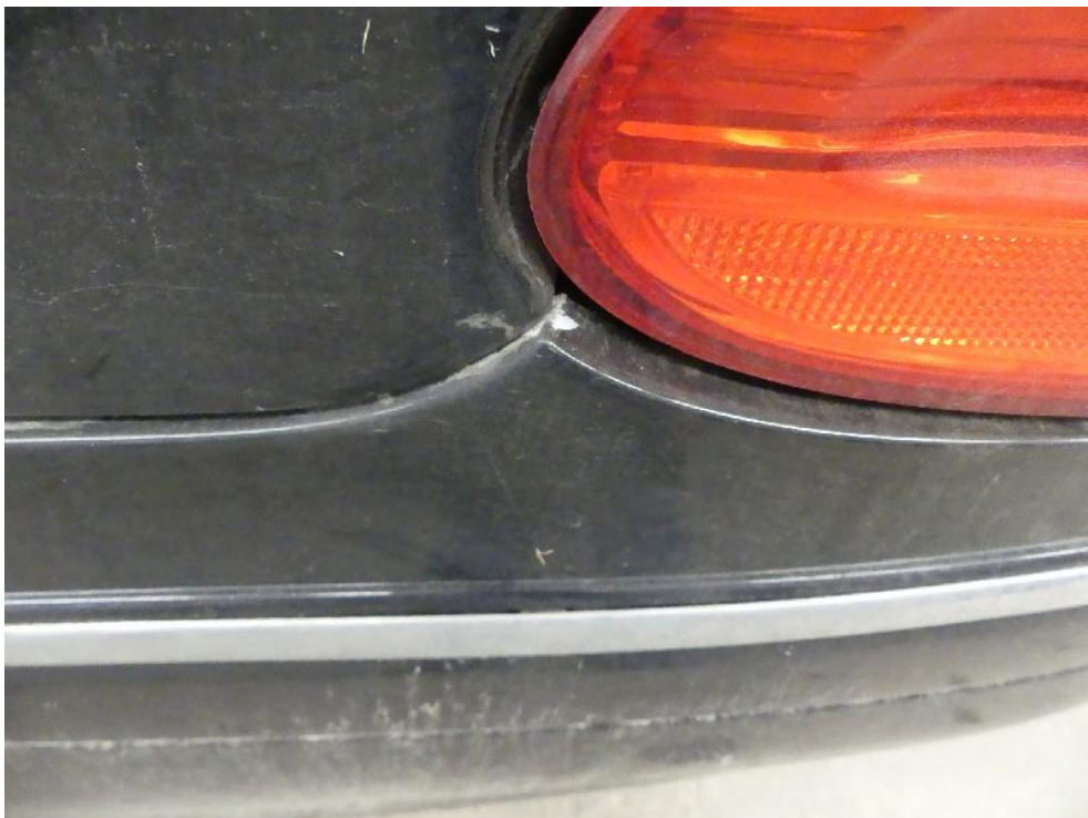
Bild: 44 Versatz der Einbaulage Heckverkleidung rechts zur Seitenwand.
