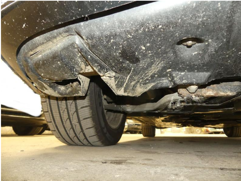
Bild: 41 Unterfahrschutz gebrochen
