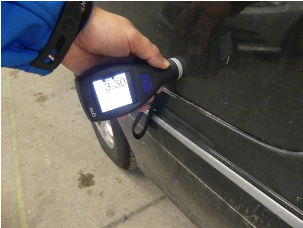
Bild: 45 Lackschichtdickenmessung der Seitenwand links 3,3mm festgestellt.
