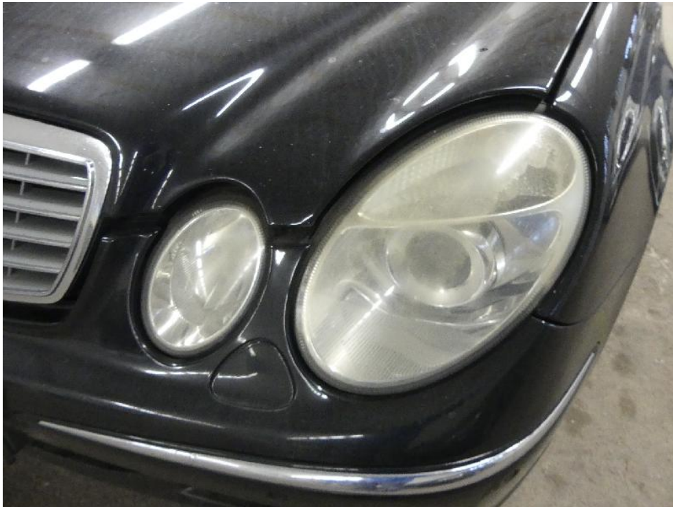
Bild: 69 Hauptscheinwerfer links blind ....
