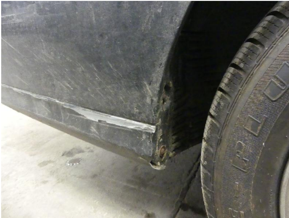
Bild: 55 Ansicht Heckverkleidung, der Lackaufbau ist sichtbar abgetragen.
