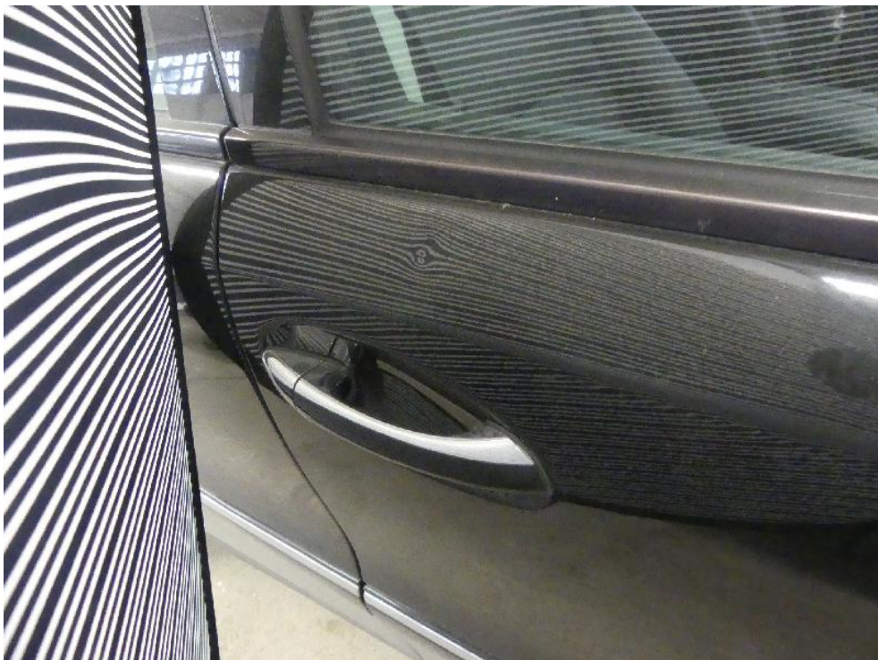
Bild: 58 Ansicht Beifahrertür, diese ist punktuell gestaucht.
