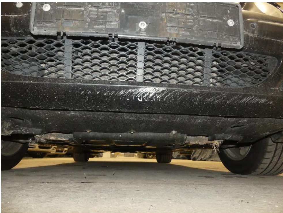
Bild: 40 Frontverkleidung unterhalb verkratzt
