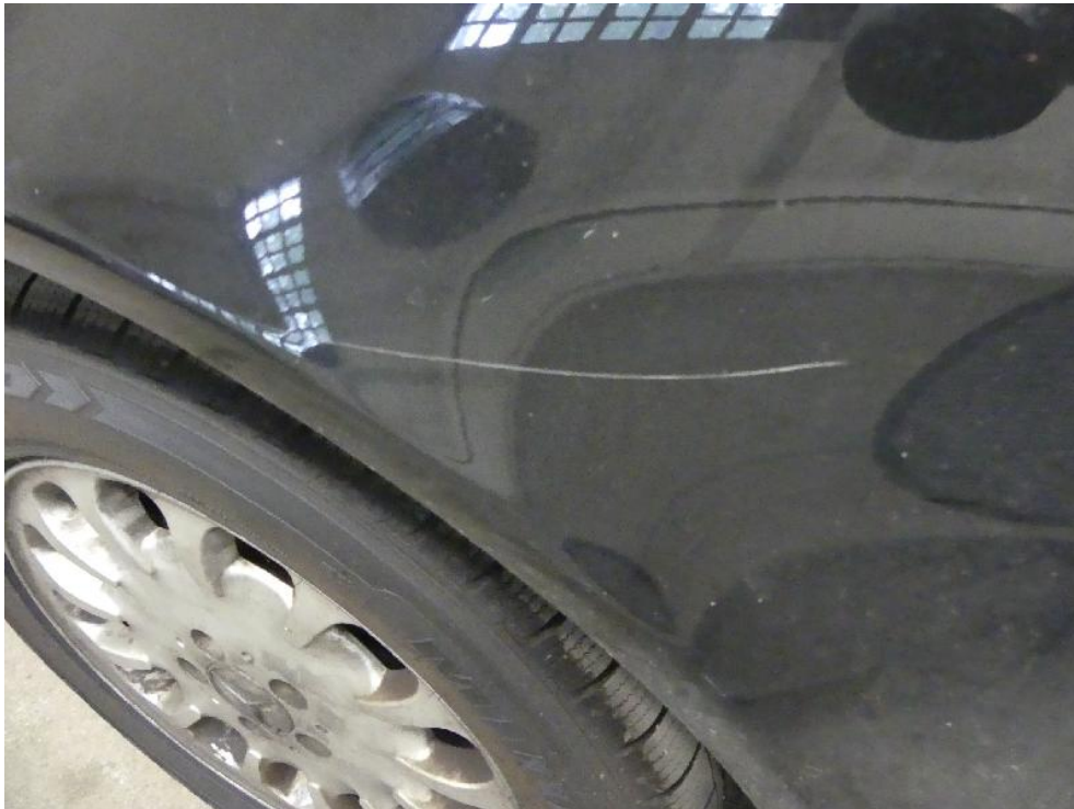
Bild: 63 ... Lackaufbau ist streifend beschädigt.
