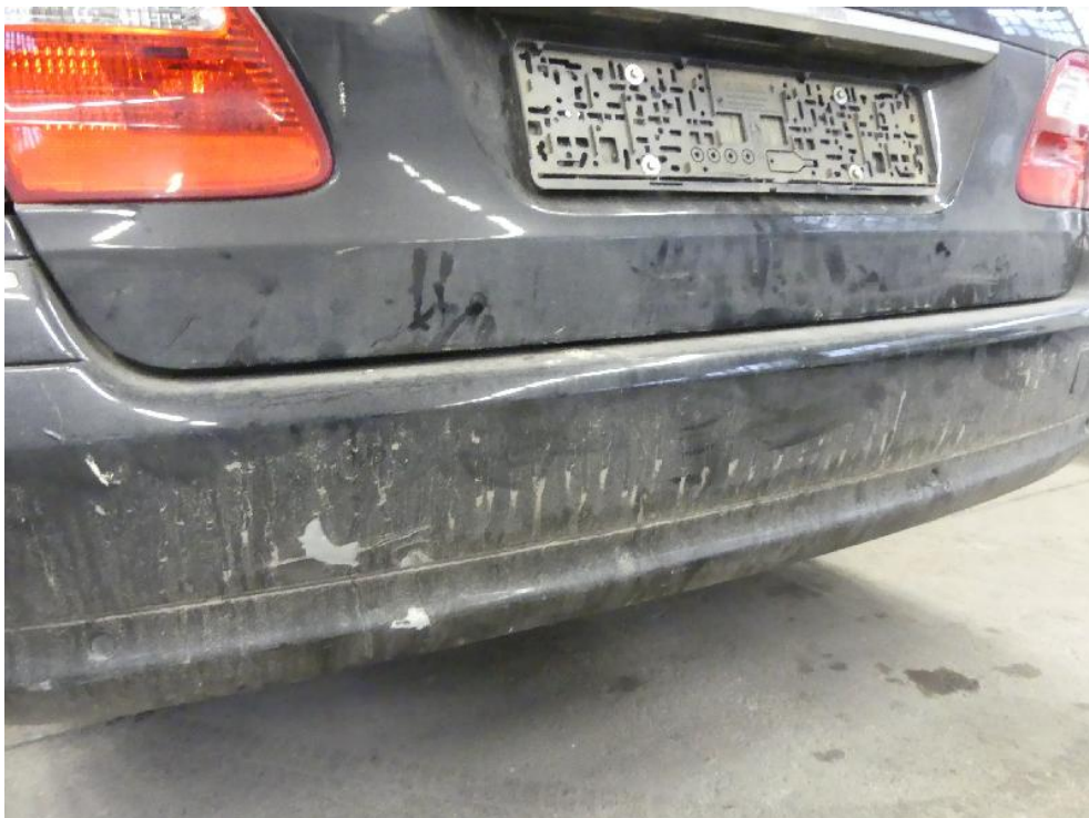
Bild: 52 Heckverkleidung linksseitig im Grundmaterial gestaut.
