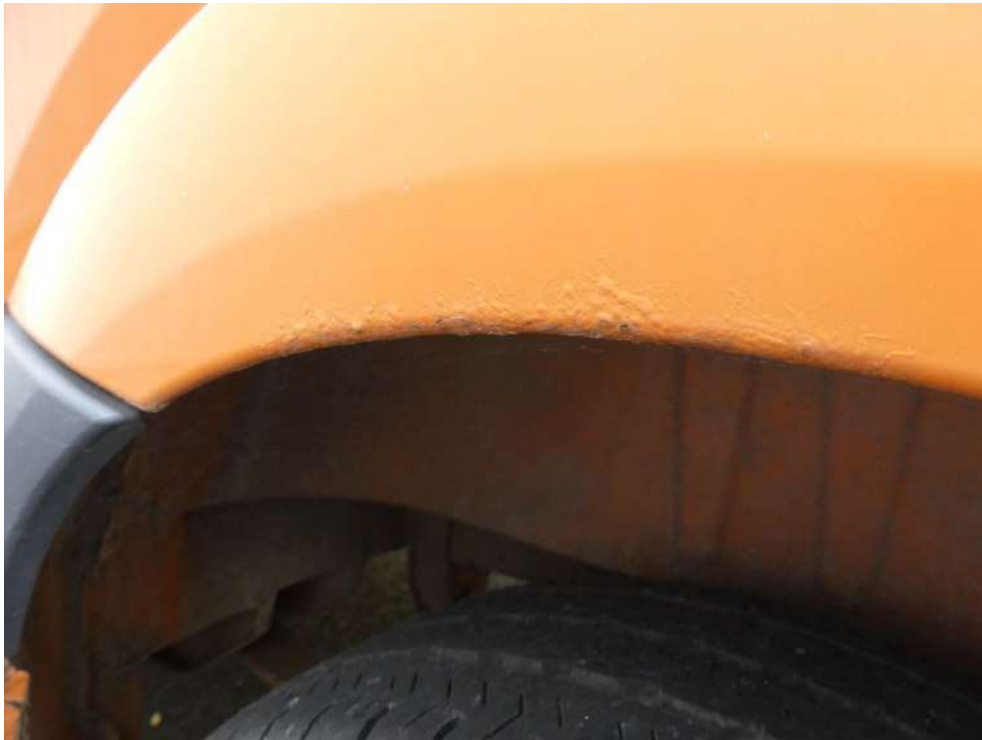
Bild: 45 ... und Rostansatz Radlauf Seitenwand links
