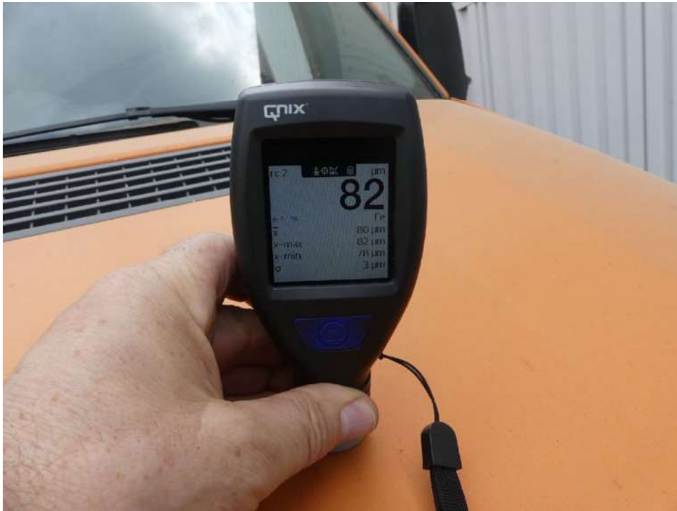
Bild: 9 Ausweisung Lackschichtdickenmessung vorgenommen, Messwerte dem beiliegenden Protokoll entnehmen.
