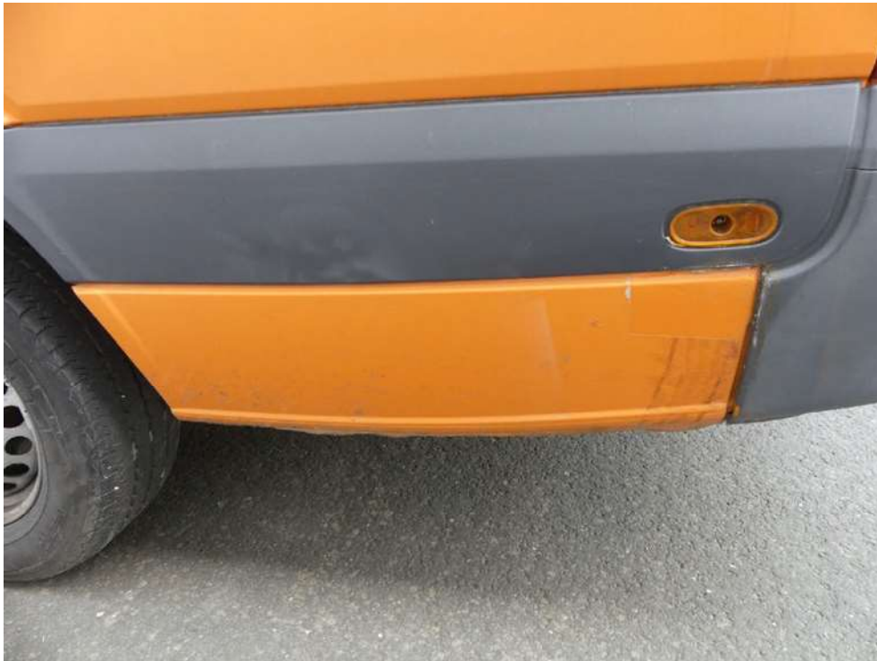
Bild: 43 Ansicht Seitenwand hinten links unterhalb nicht fachgerecht instandgesetzt
