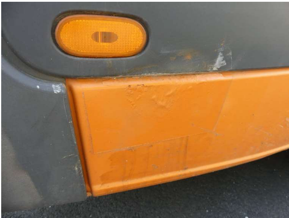
Bild: 38 Seitenwand hinten rechts unterhalb nicht fachgerecht instandgesetzt.
