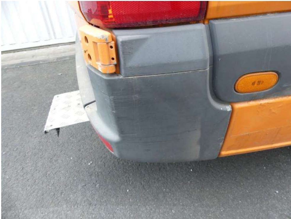
Bild: 39 Ausweisung Beschädigung Eckblende Heckverkleidung
