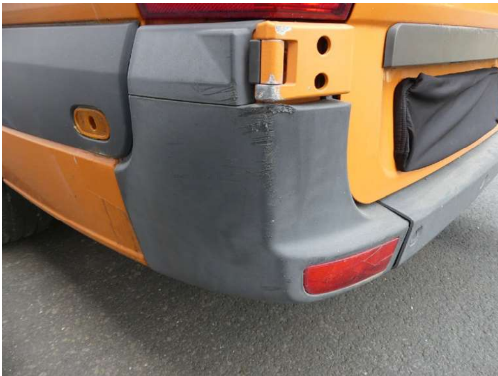
Bild: 42 Ausweisung Beschädigung Eckblende Heckverkleidung links
