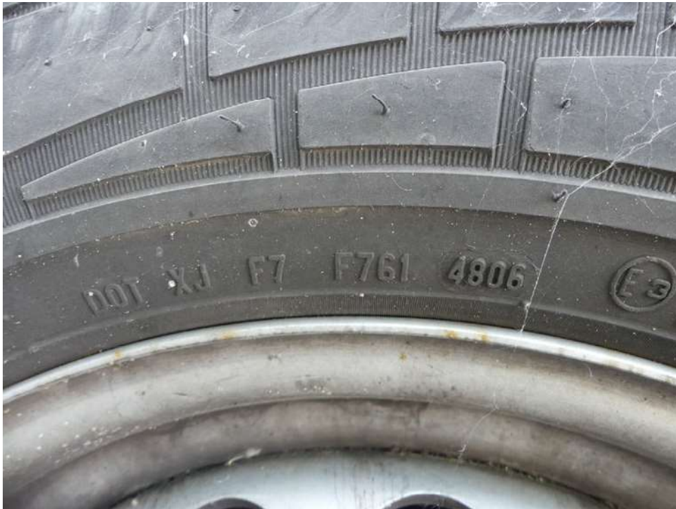
Bild: 29 Ausweisung der DOT Nummer der Radialreifen
