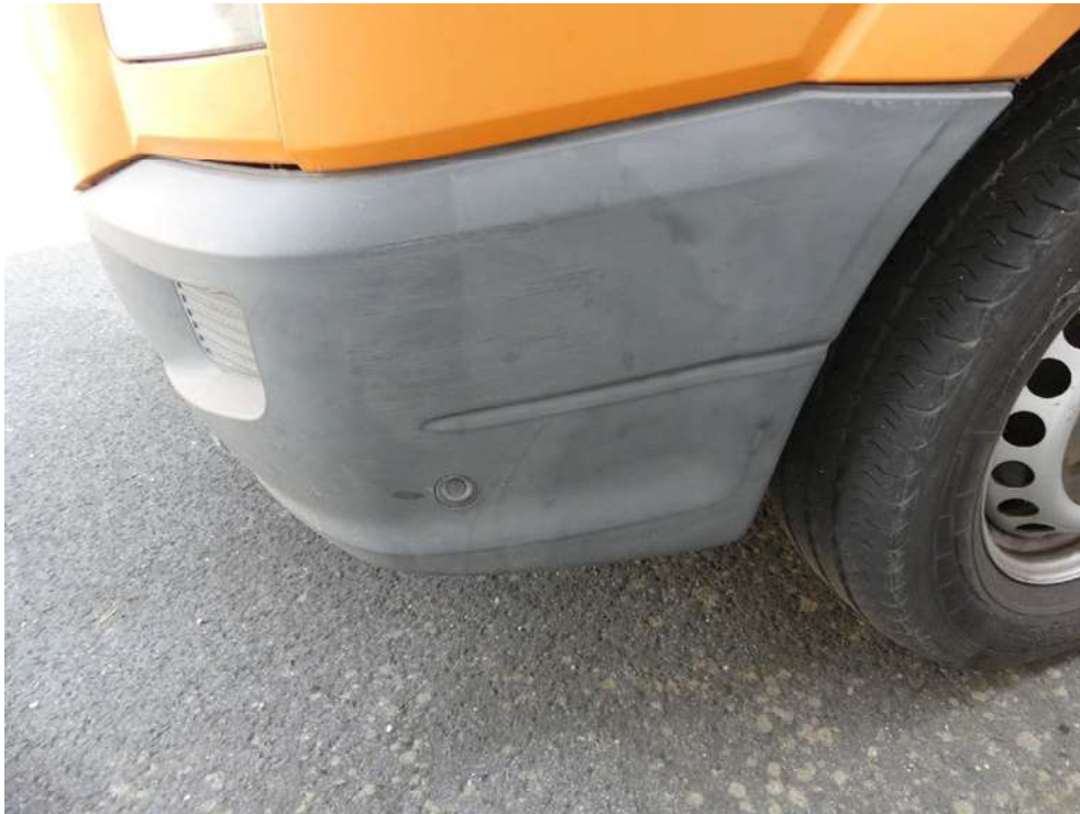
Bild: 31 Ausweisung Beschädigung Frontverkleisung
