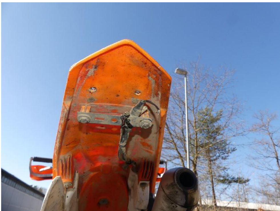
Bild: 32 Detailansicht Heck, Bremslicht / Rücklicht fehlt.
