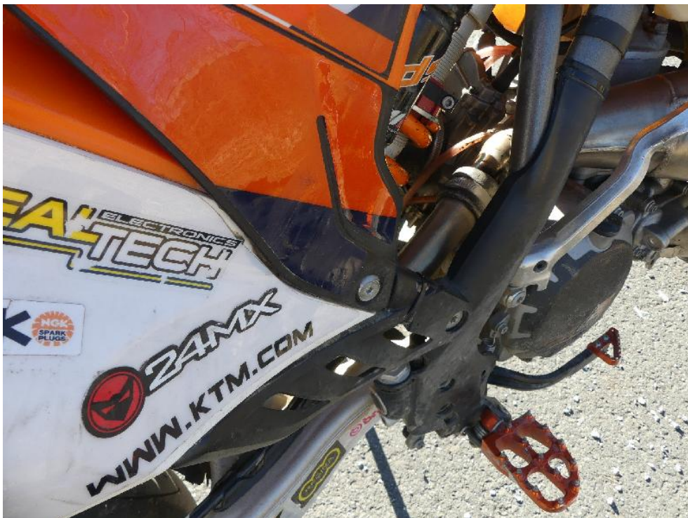
Bild: 36 Detailansicht Seitenverkleidung rechtes, die ist im Farbaufbau sowie in der Dekorfolierung beschädigt/ markiert.
