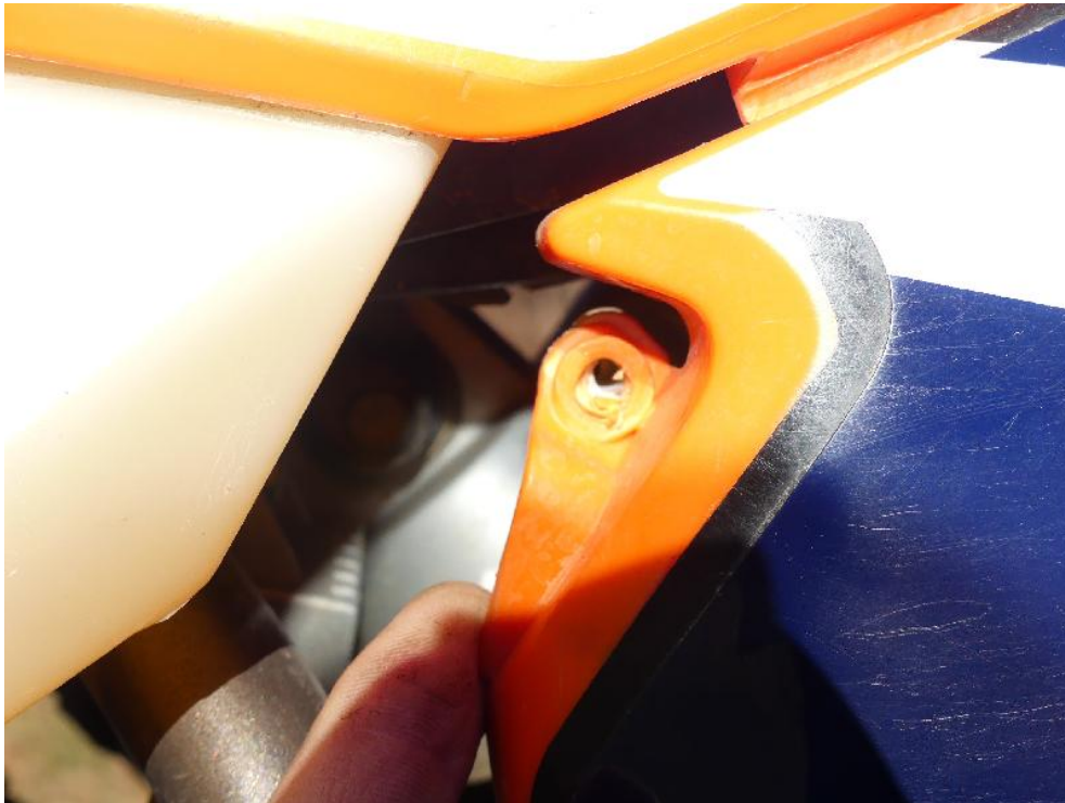
Bild: 23 Befestigungspunkt Seitenverkleidung fehlt
