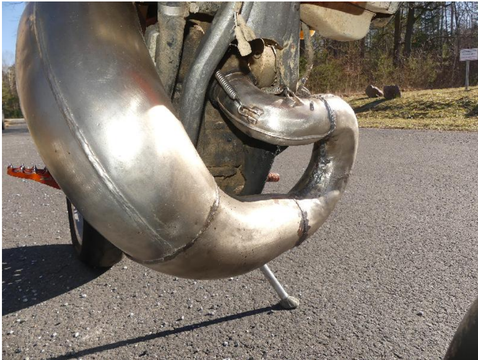
Bild: 27 Detailansicht Abgaskrümmung
