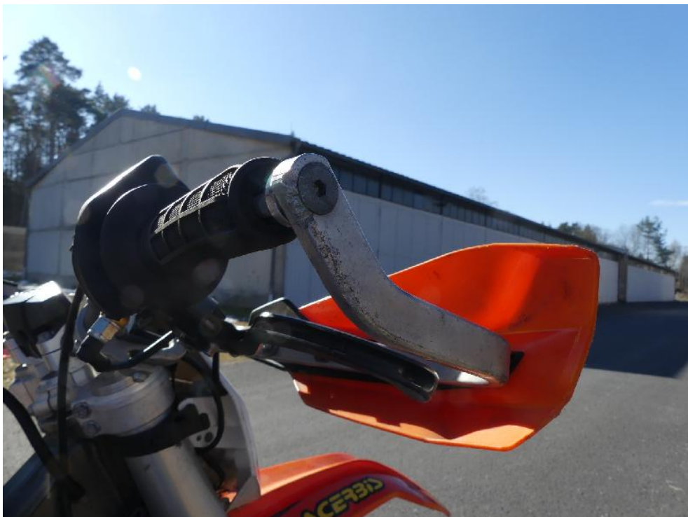
Bild: 22 Griffschutz rechts ist beschädigt.
