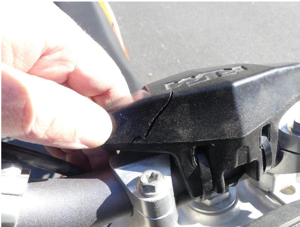
Bild: 37 Abdeckung Lenkervorbau gebrochen
