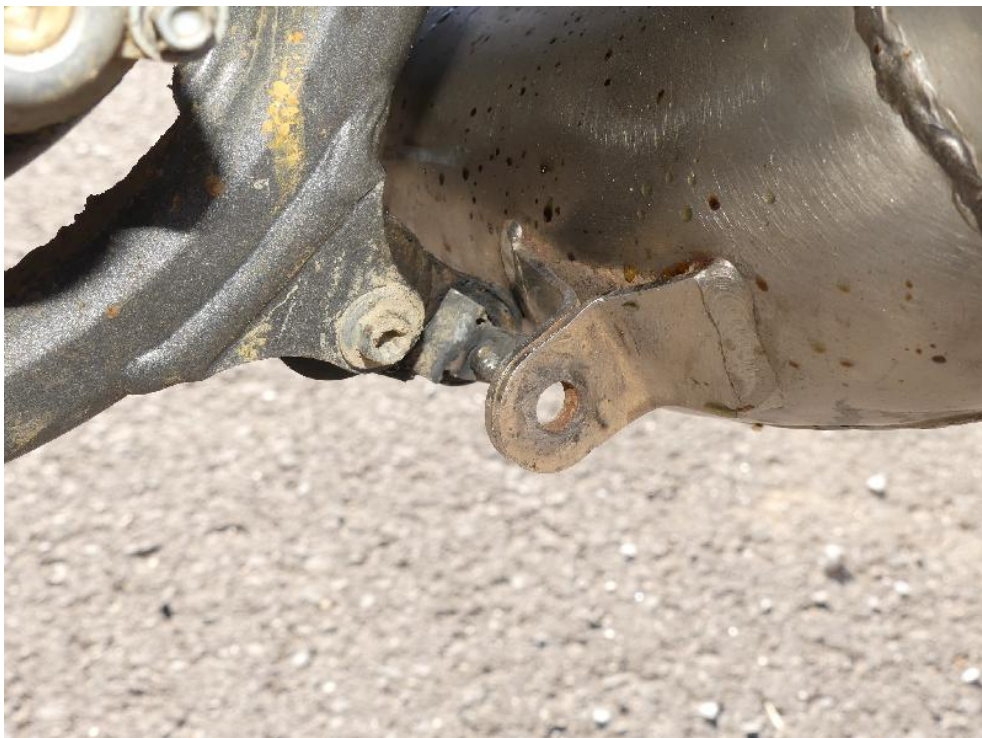
Bild: 40 Abgaskrümmer ohne Befestigung
