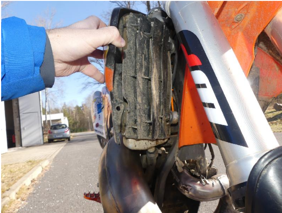
Bild: 25 Abdeckung Kühler verbogen.
