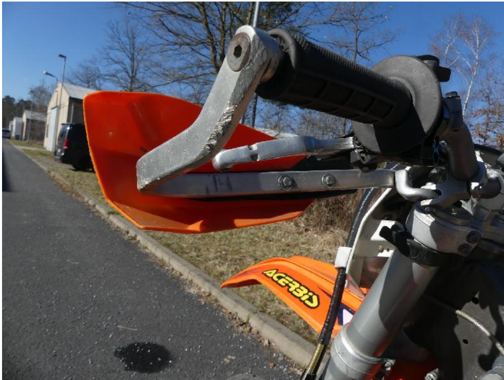
Bild: 21 Detailansicht Griffschutz beschädigt.
