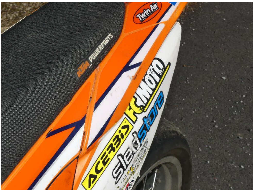
Bild: 24 Seitenverkleidung links beschädigt / verkratzt
