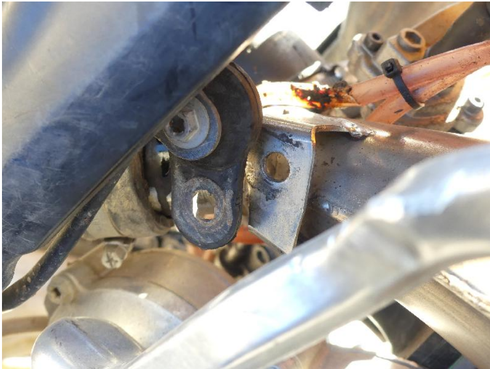
Bild: 41 Weiter Detailansicht, Abgasanlage ohne Befestigung
