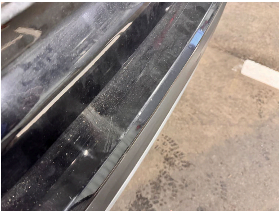
Bild: 54 ...der Heckverkleidung im Lackaufbau beschädigt.
