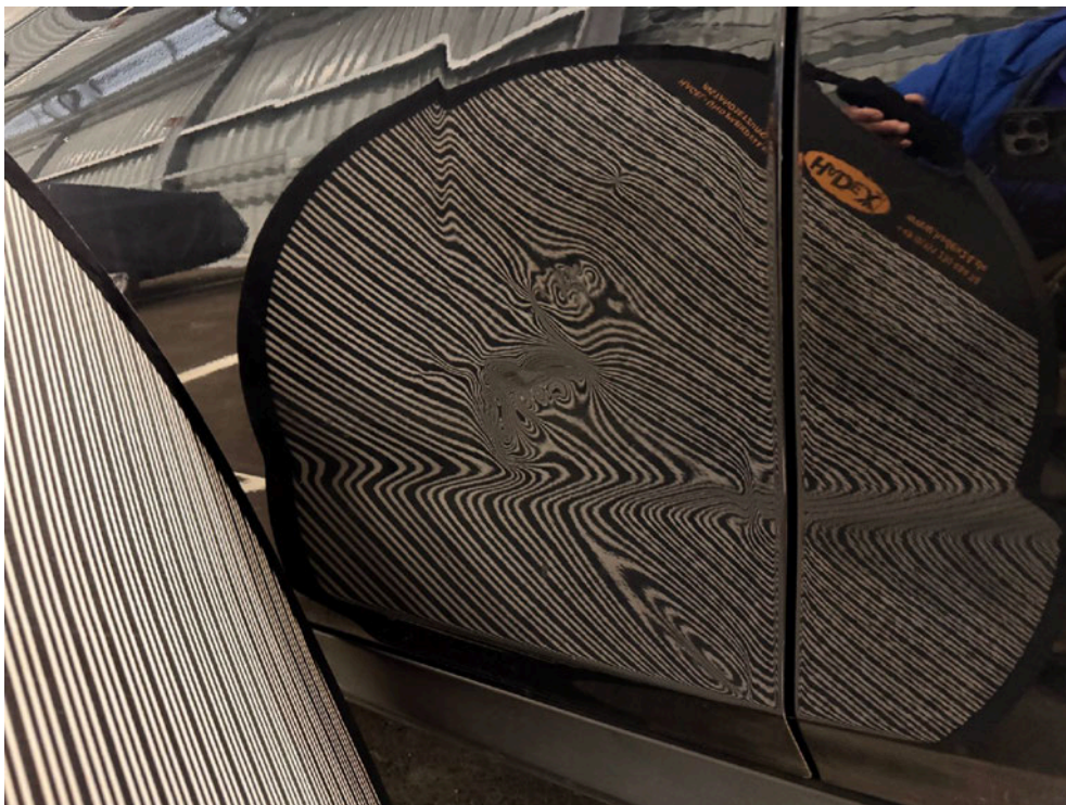
Bild: 48 ... diese ist großflächig in der Türaußenhaut deformiert.
