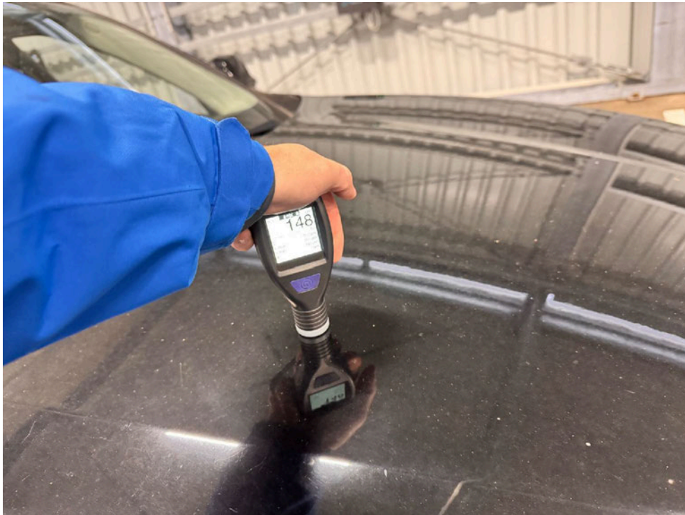
Bild: 17 Ausweisung Lackschichtdickenmessung vorgenommen, Messwerte dem beiliegenden Protokoll entnehmen.
