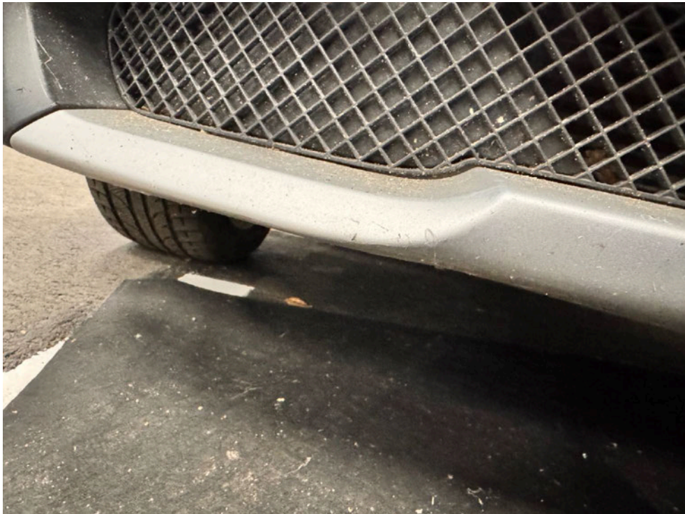
Bild: 59 Dekorleiste in der Frontverkleidung ist partiell markiert.
