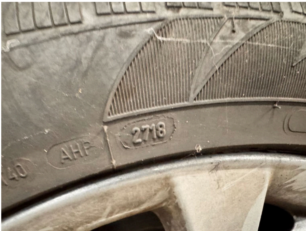
Bild: 16 Ausweisung der DOT Nummer der Radialreifen
