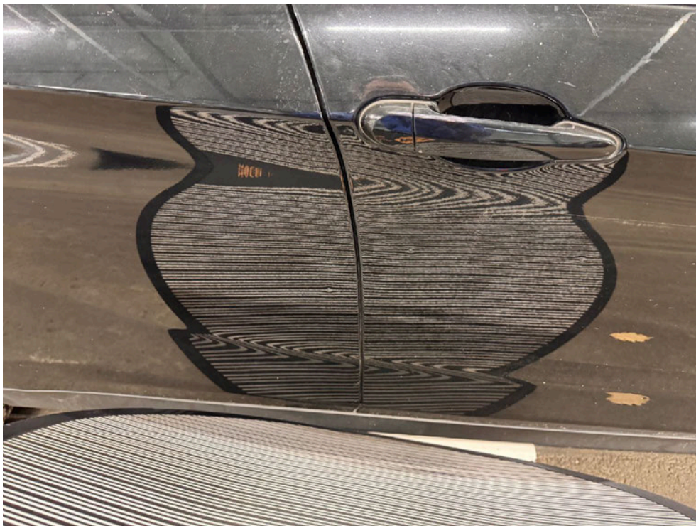
Bild: 57 Beide rechten Fahrzeugtüren sind in der Türaußenhaut punktuell beschädigt.
