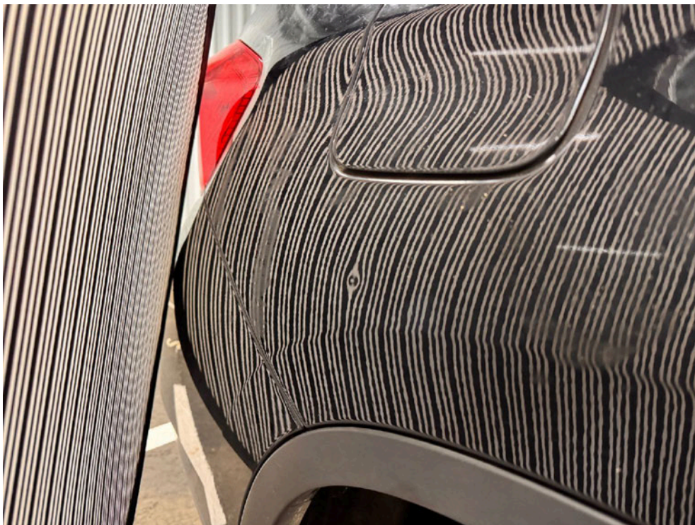
Bild: 56 Seitenwand rechts punktuelle Eindellung vorhanden.
