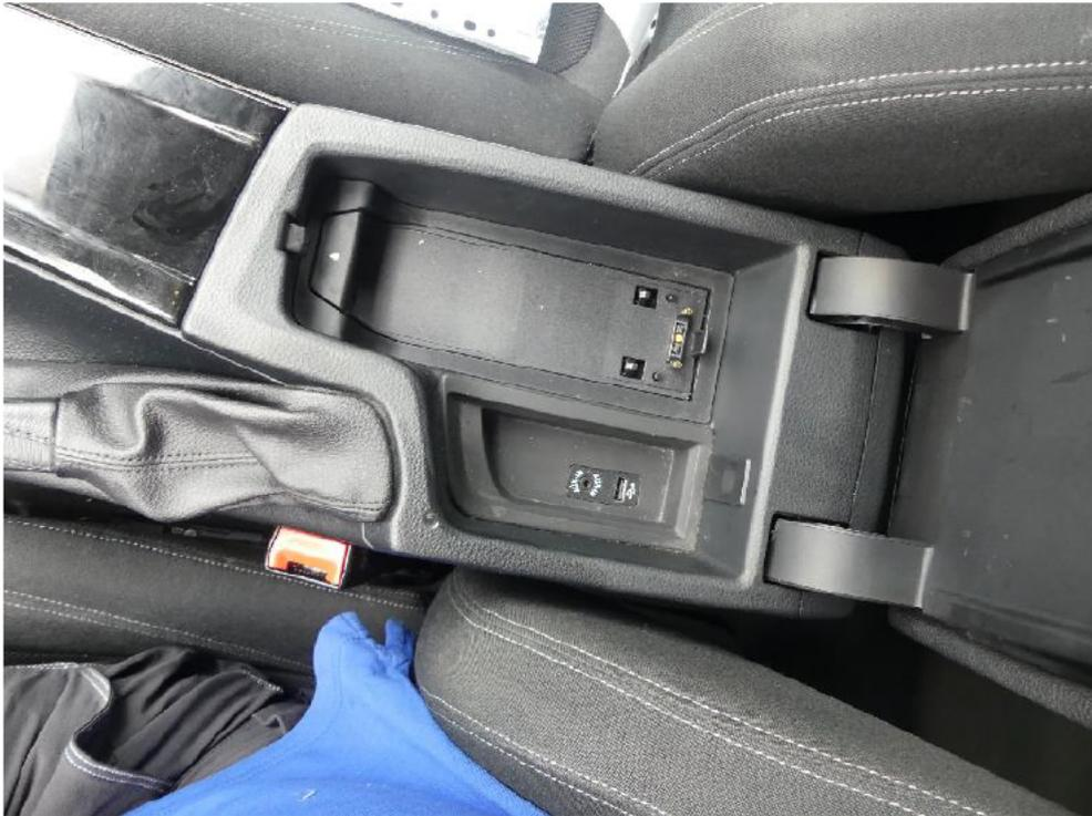
Bild: 15 Detailansicht Mittelkonsole im geöffneten Zustand
