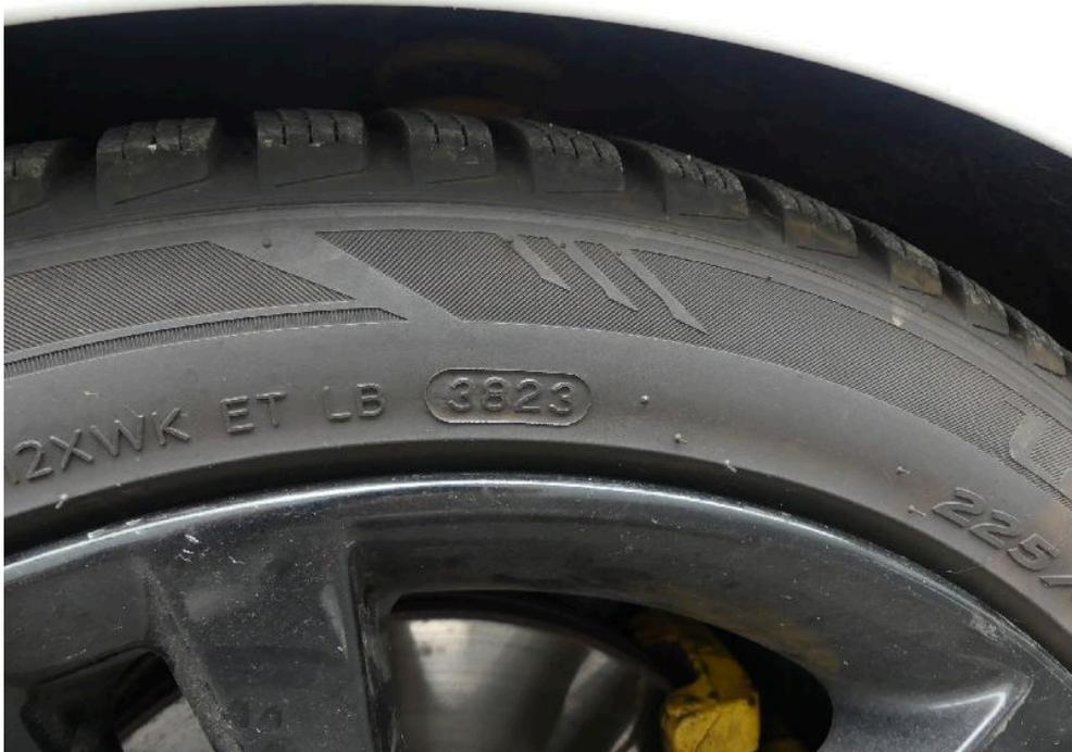
Bild: 40 Ausweisung der DOT Nummer der Radialreifen
