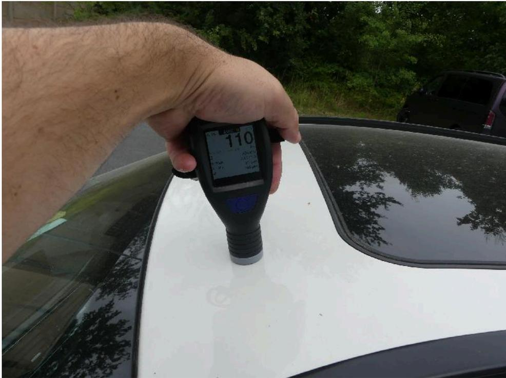
Bild: 65 Ausweisung Lackschichtdickenmessung vorgenommen, Messwerte dem beiliegenden Protokoll entnehmen.
