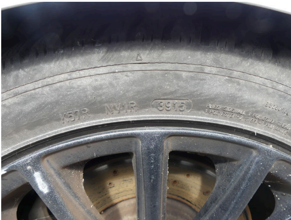
Bild: 49 Ausweisung der DOT Nummer der Radialreifen
