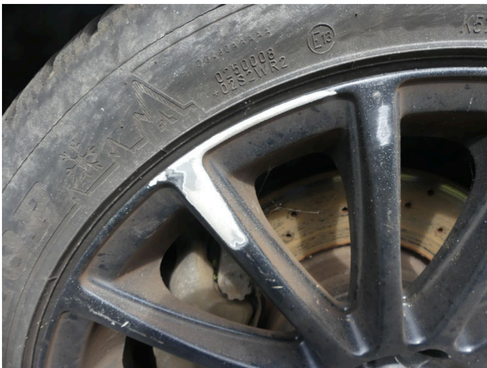
Bild: 47 Detailansicht, die LM-Felge ist beschädigt.
