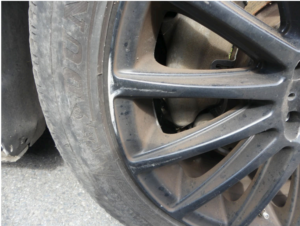
Bild: 48 Detailansicht, die LM-Felge ist streifend beschädigt.
