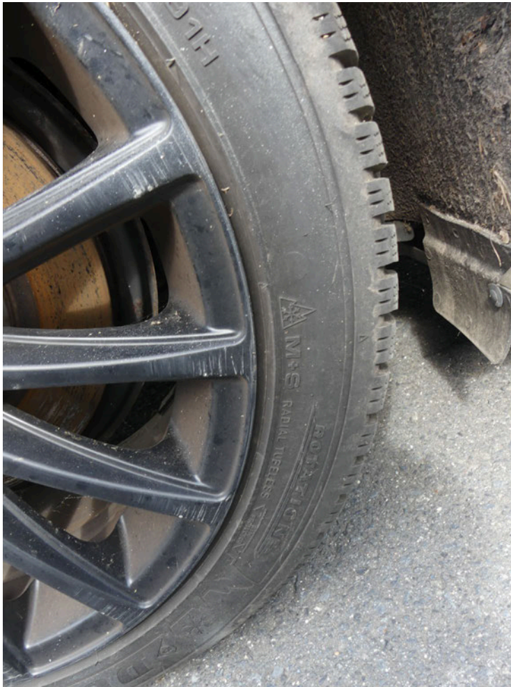
Bild: 43 LM-Felge streifend in der Farbgebung markiert.
