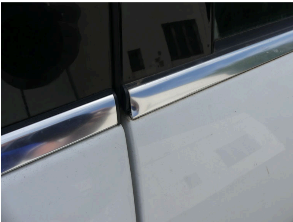
Bild: 63 Fensterschachtleiste Tür hinten links partiell gestaucht.
