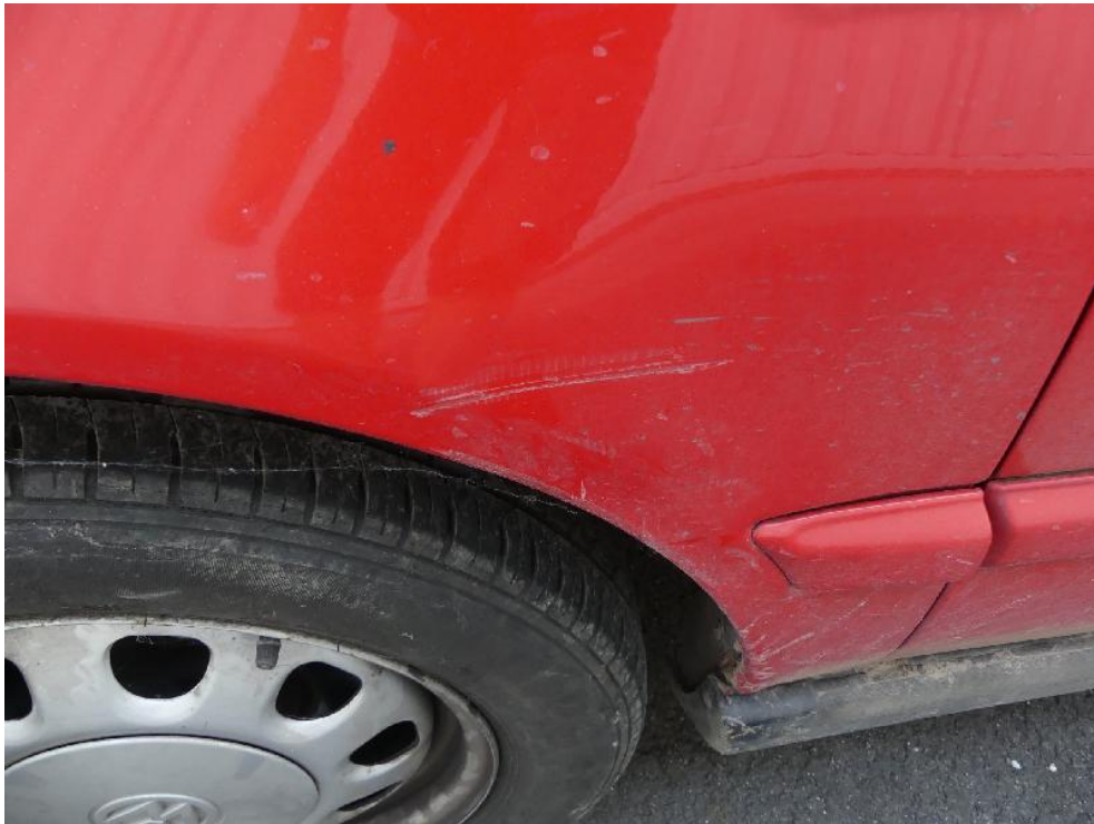
Bild: 51 Kotflügel vorn links im Lackaufbau beschädigt.
