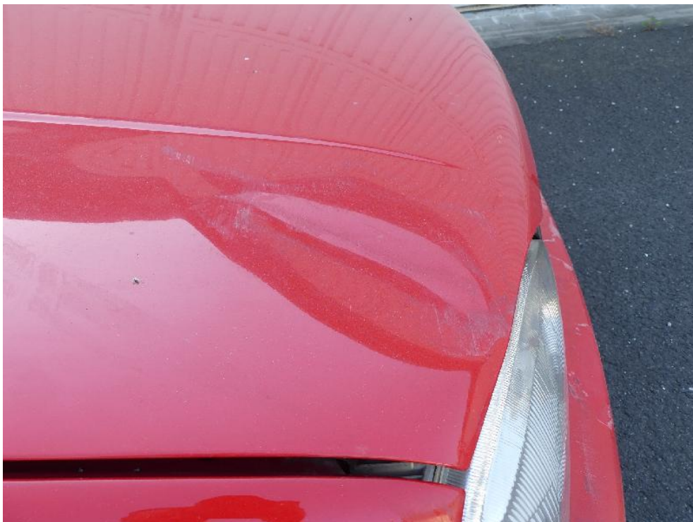
Bild: 54 Motorhaube großflächig gestaucht.
