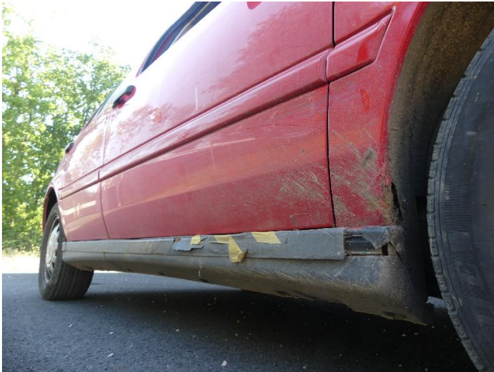
Bild: 37 Abdeckung Seitenschweller sporadisch befestigt.
