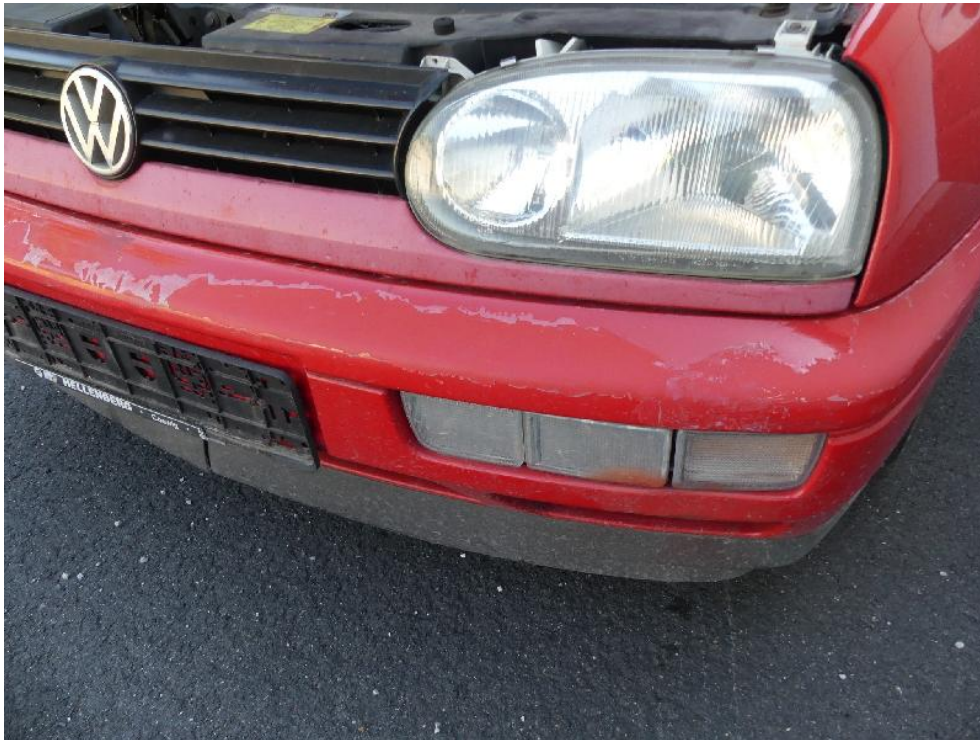
Bild: 33 Klarlackablösung Frontverkleidung
