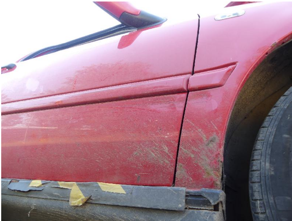
Bild: 39 Kotflügel + Beifahrertür gestaucht.
