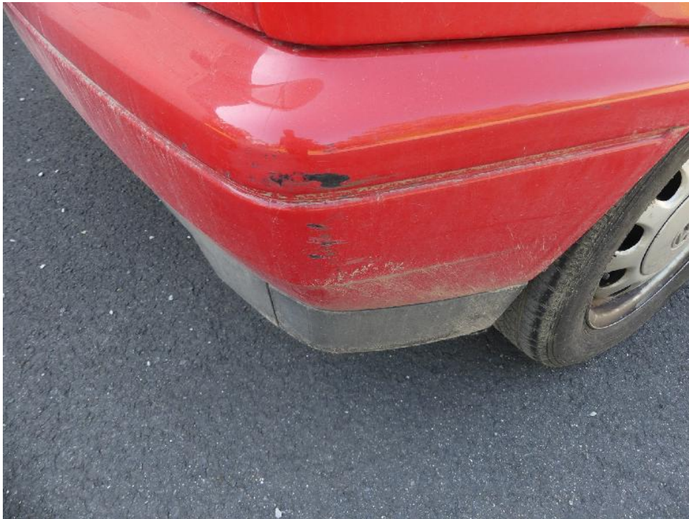
Bild: 43 Heckverkleidung rechts im Lackaufbau abgetragen.
