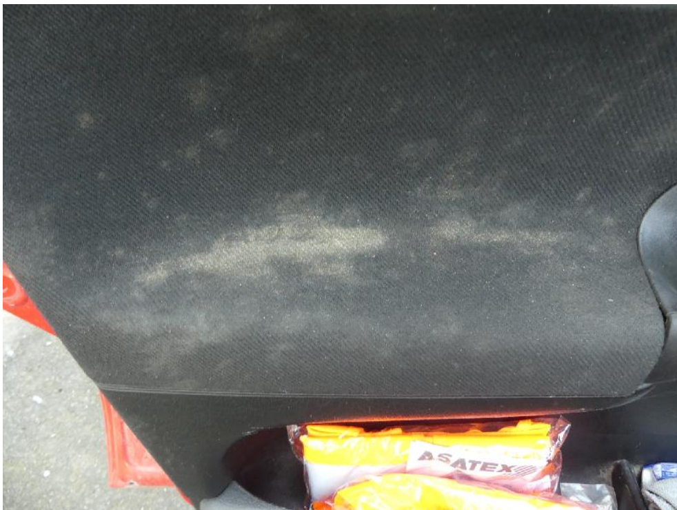
Bild: 10 Detailansicht, Schimmelbildung Türverkleidung
