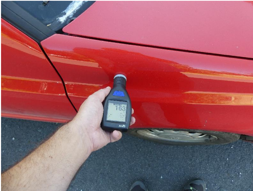
Bild: 55 Ausweisung Lackschichtdickenmessung vorgenommen, Messwerte dem beiliegenden Protokoll entnehmen.
