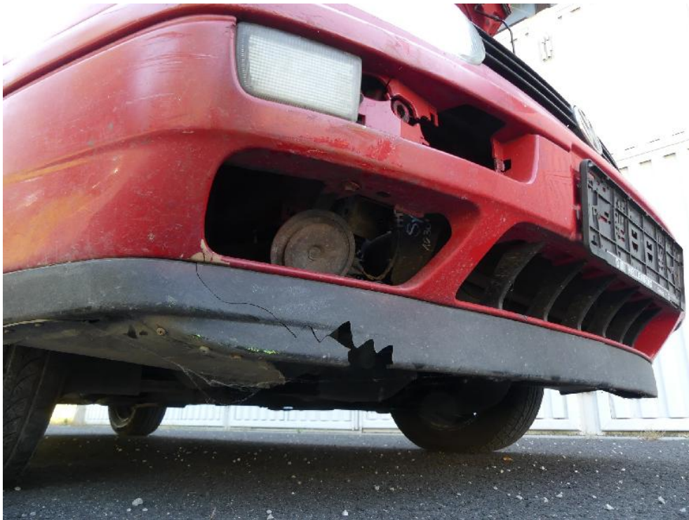
Bild: 35 Spoileransatz partiell ausgebrochen.
