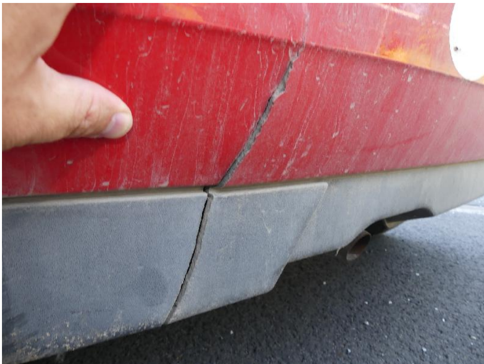
Bild: 46 Heckverkleidung unterhalb gebrochen.
