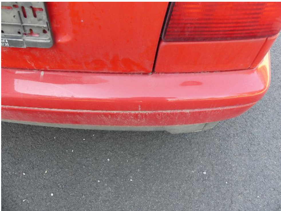
Bild: 44 Weiterführend ist die Heckverkleidung gestaucht.
