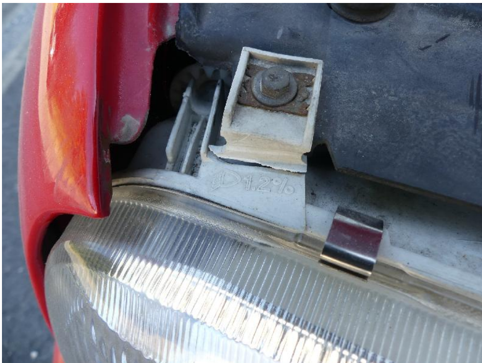
Bild: 30 Hauptscheinwerfer im Befestigungspunkt gebrochen.
