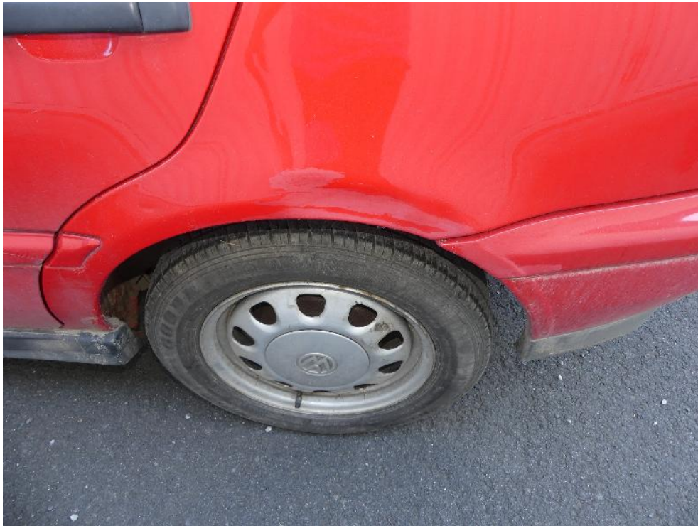
Bild: 49 Seitenwand links gestaucht.
