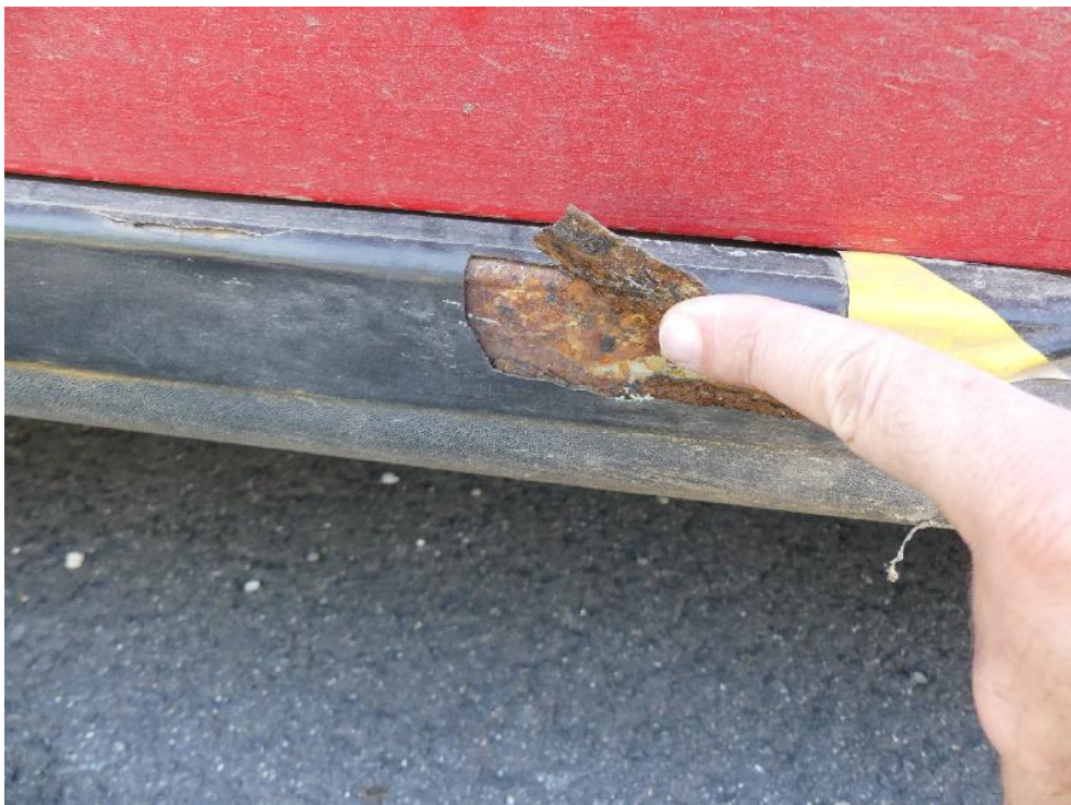
Bild: 38 Korrosionsansatz Einstiegsschweller rechts
