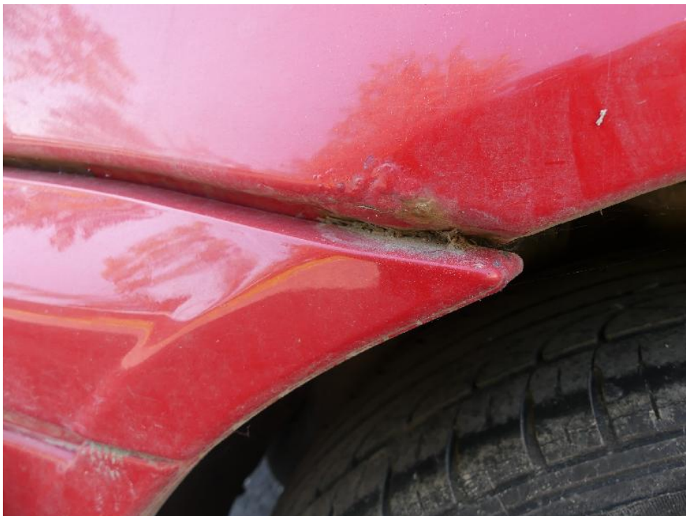
Bild: 42 ... hierbei ist ein Korrosionsansatz vorhanden.
