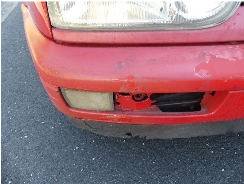
Bild: 34 Deformation Frontverkleidung
