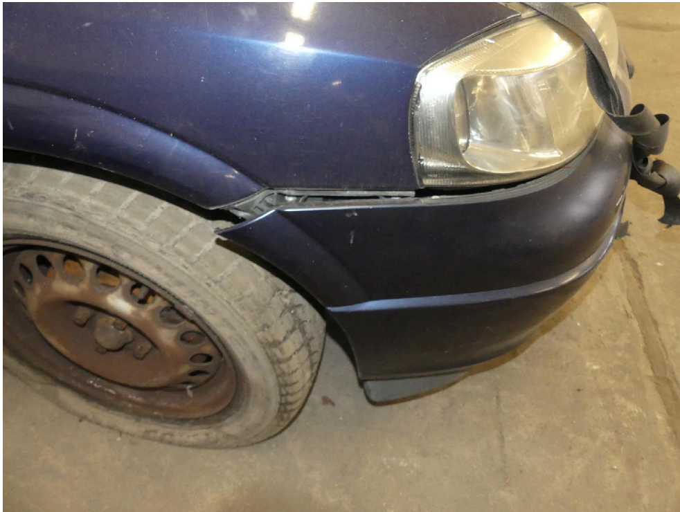
Bild: 35 Frontverkleidung rechtsseitig lose.
