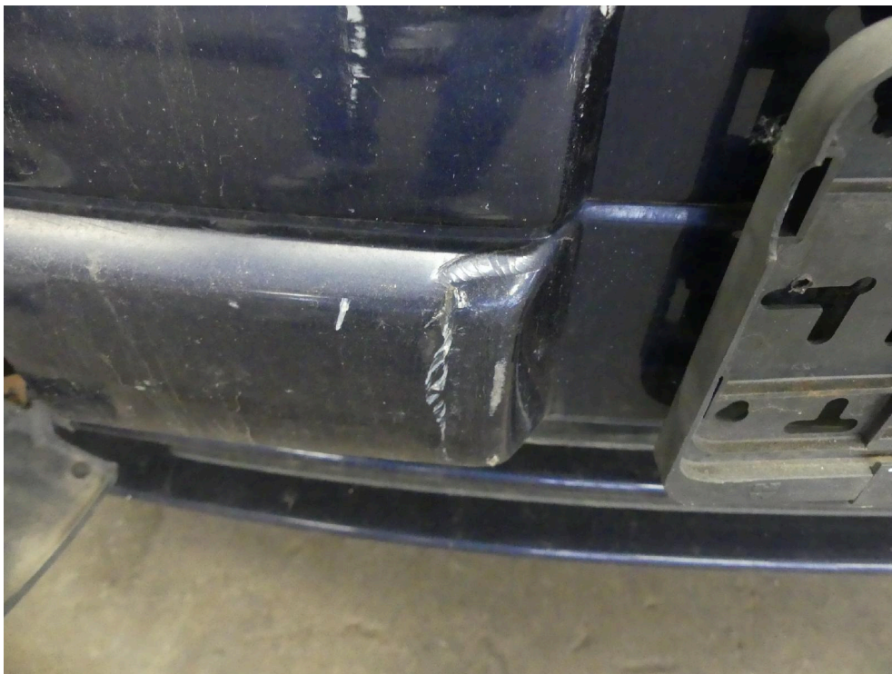
Bild: 36 Frontverkleidung deformiert im Bereich Kennzeichen.
