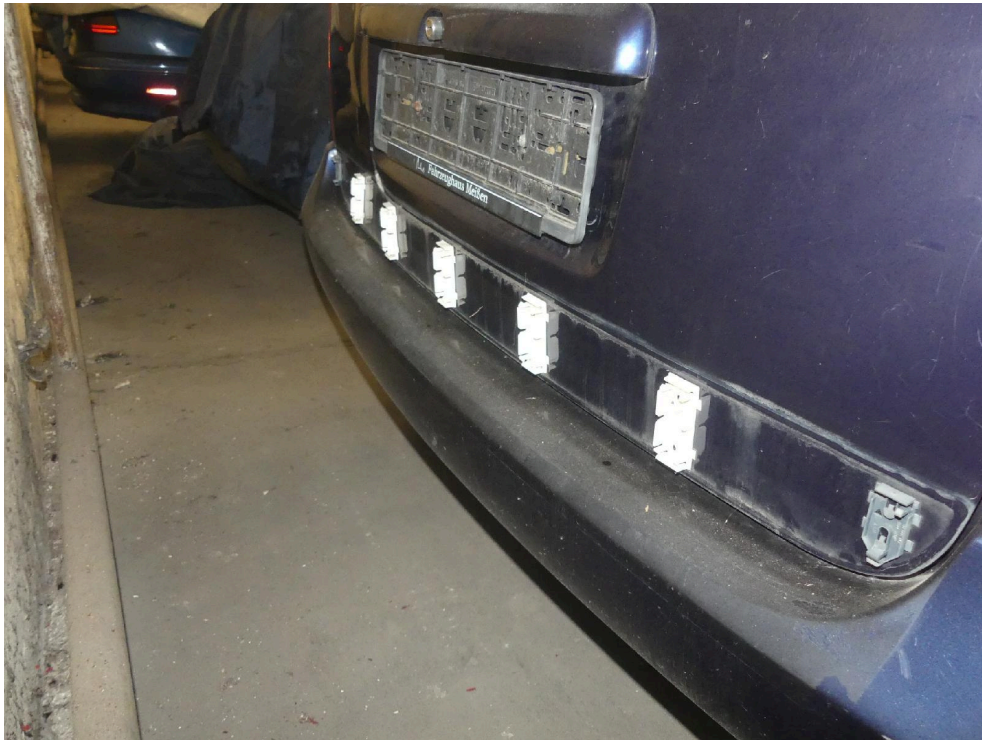
Bild: 31 Detailansicht Heckklappe, Abdeckblende fehlt.
