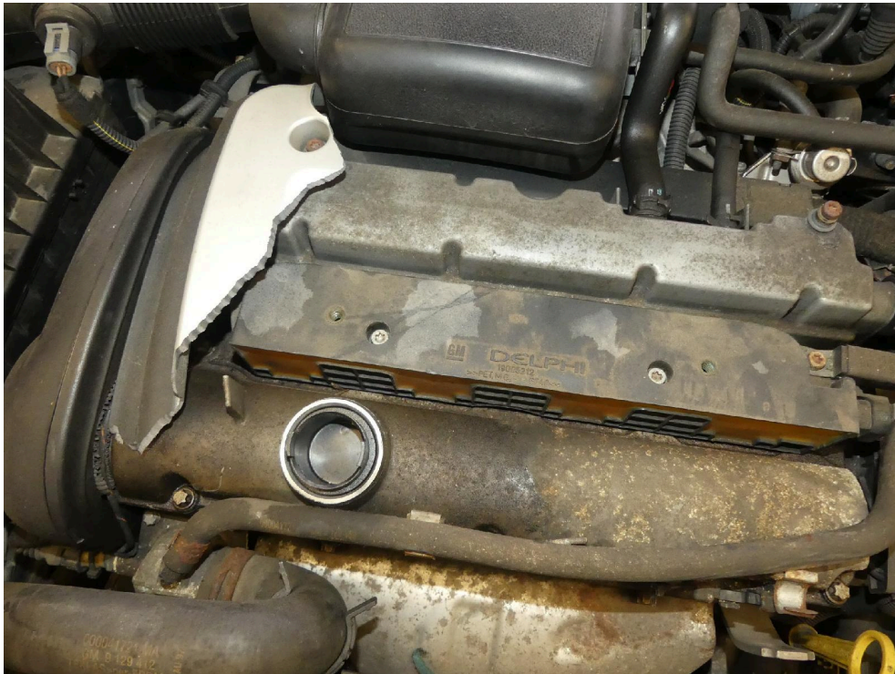
Bild: 29 Anbauteile Motor fehlen
