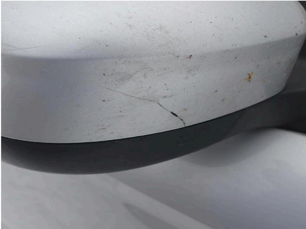
Bild: 85 Abdeckung Außenspiegel rechts gebrochen.
