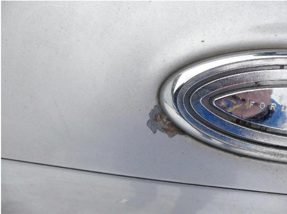
Bild: 69 ... punktuelle Ablösung Farbaufbau im Bereich Firmenemblem.
