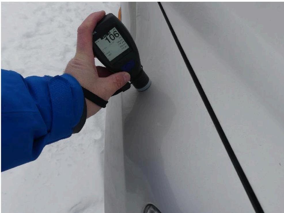
Bild: 88 Ausweisung Lackschichtdickenmessung vorgenommen, Messwerte dem beiliegenden Protokoll entnehmen.
