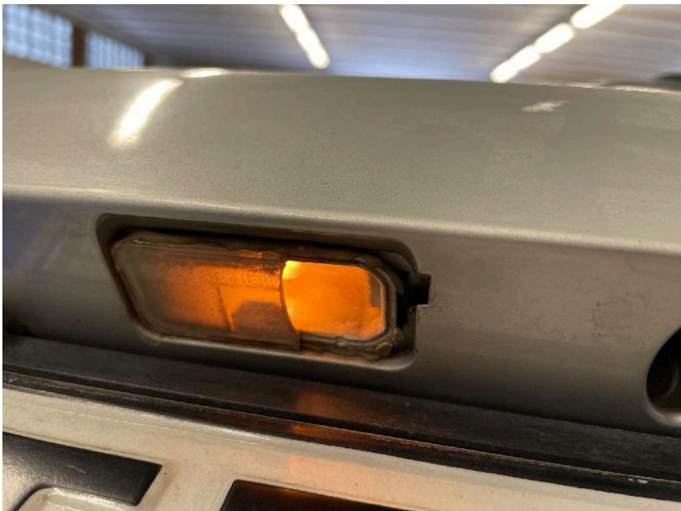
Bild: 70 Kennzeichenleuchte links partiell ausgebrochen.
