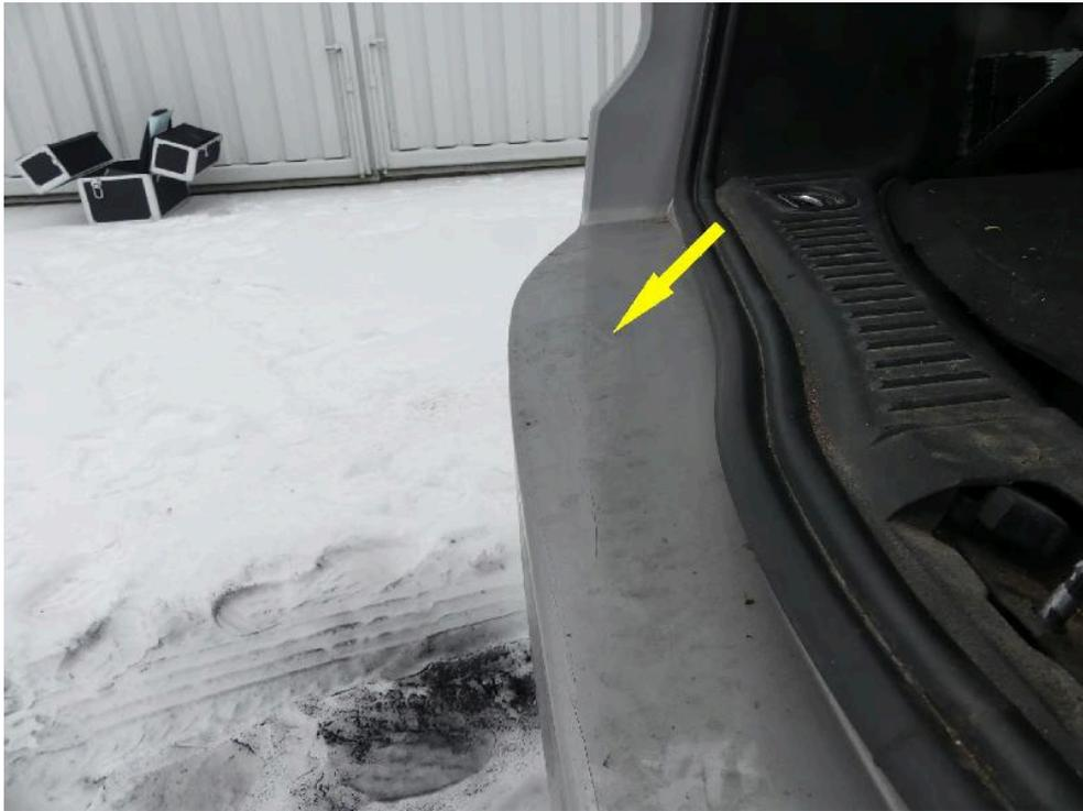
Bild: 67 Ausweisung signifikante Knickbildung im Bereich Ladekante.
