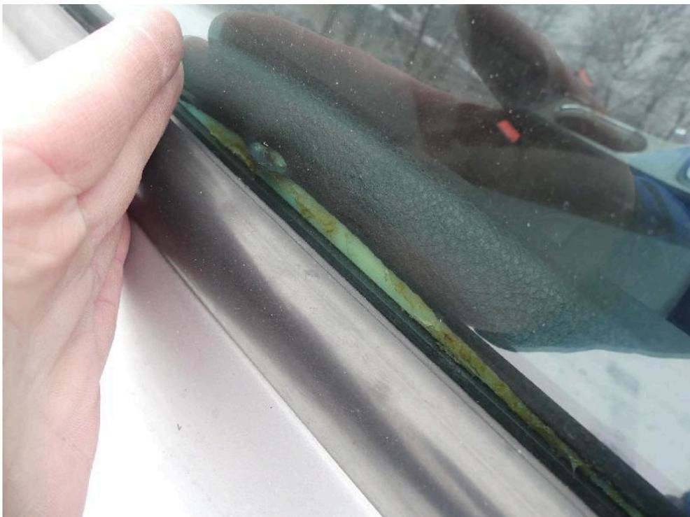
Bild: 48 Einzeldarstellung Türverkleidung vorn rechts, diese ist partiell abgelöst und bleibend aufgestellt.
