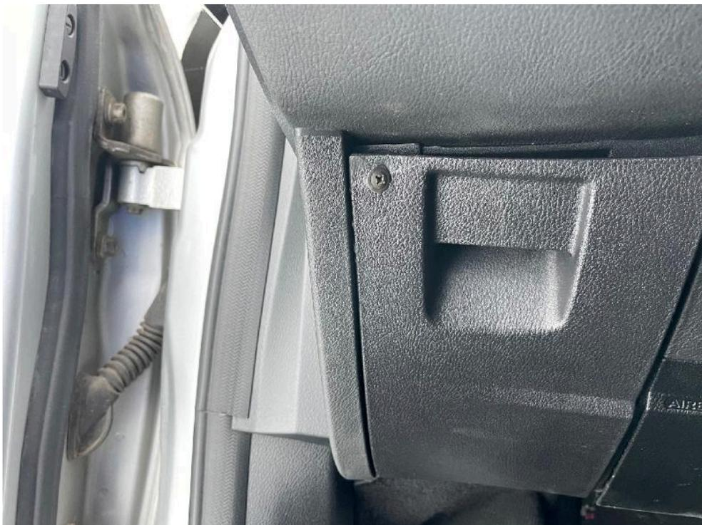
Bild: 26 Ablagefach links mit Schraube befestigt - ansonsten nicht verschließbar.
