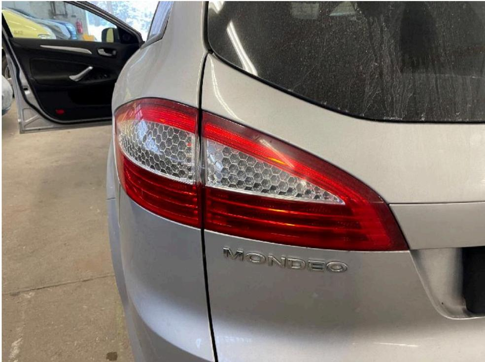
Bild: 71 Rückleuchte links ohne Funktion.
