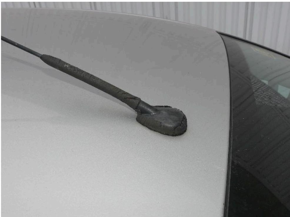
Bild: 86 Ansicht Antenne, der Antennenfuß ist beschädigt ...
