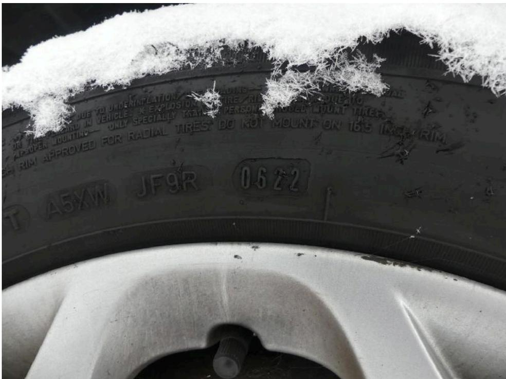
Bild: 10 Ausweisung der DOT Nummer der Radialreifen
