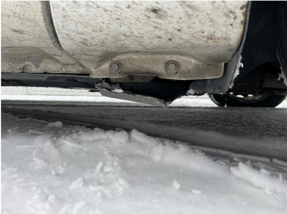
Bild: 75 Abdeckung Unterboden rechts partiell lose
