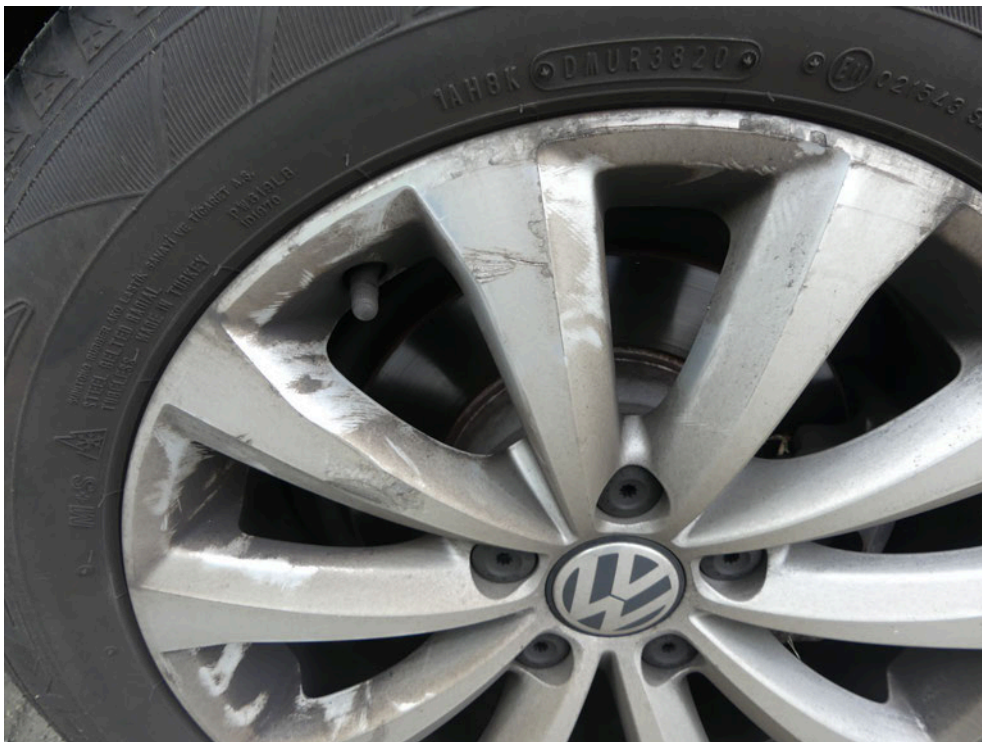
Bild: 30 Ausweisung Beschädigung LM-Felge hinten rechts.
