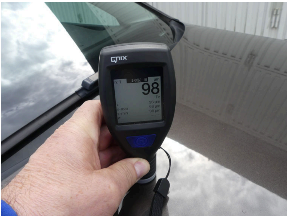
Bild: 36 Ausweisung Lackschichtdickenmessung vorgenommen, Messwerte dem beiliegenden Protokoll entnehmen.
