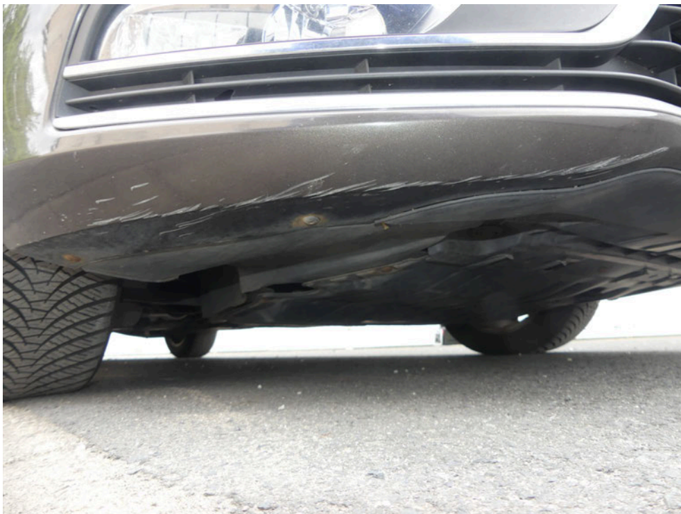
Bild: 32 Ausweisung Beschädigung Frontverkleidung unterhalb.
