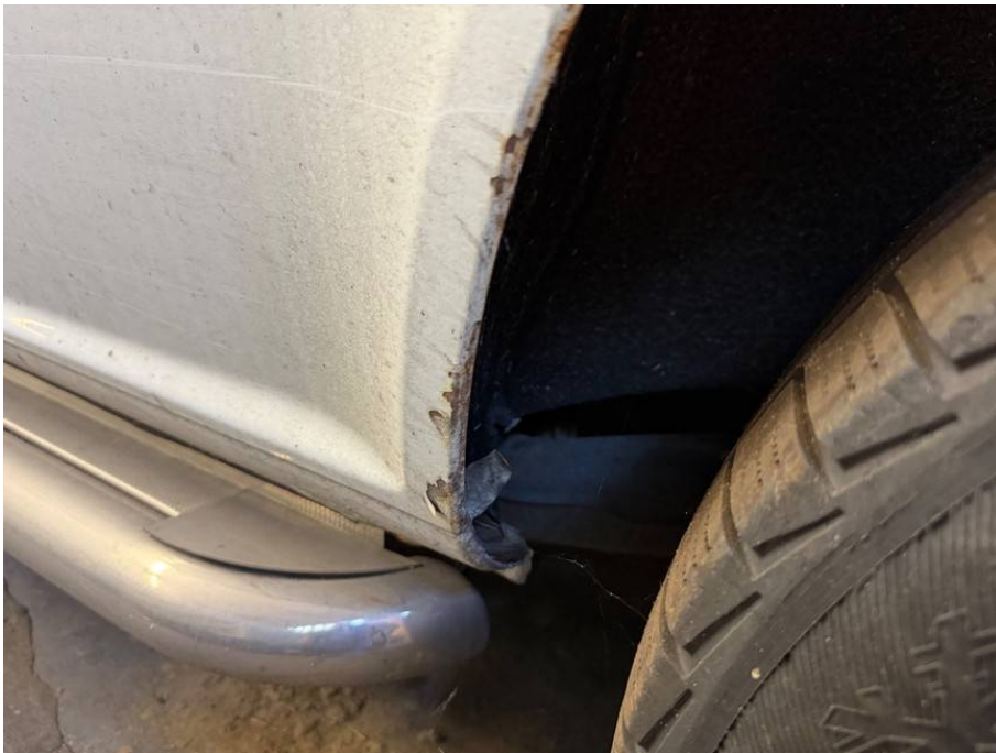
Korrosion linke Seitenwand
