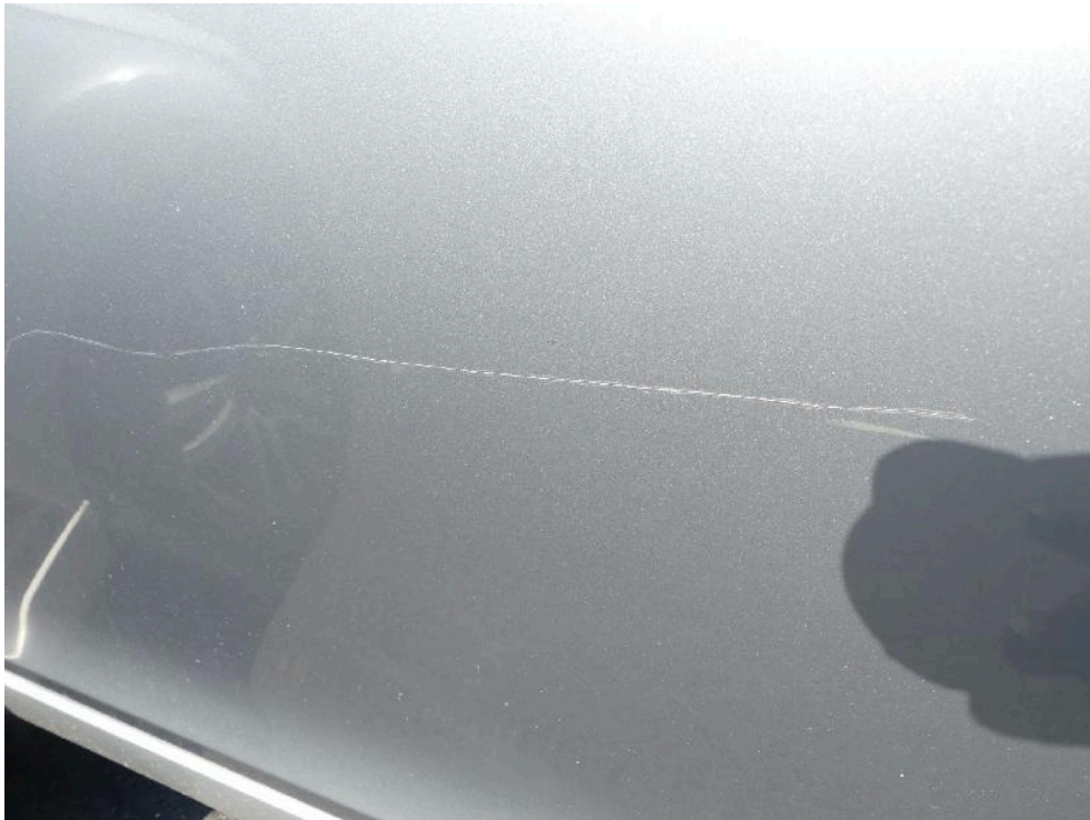
Bild: 66 .... diese ist streifend im Lackaufbau markiert.
