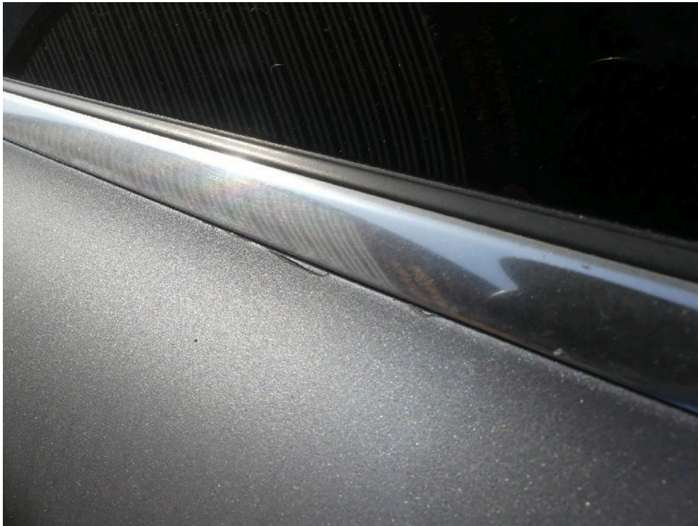
Bild: 73 Ansicht wie vor, im Übergang zur Fensterschachtleiste löst sich partiell das Lackmaterial.
