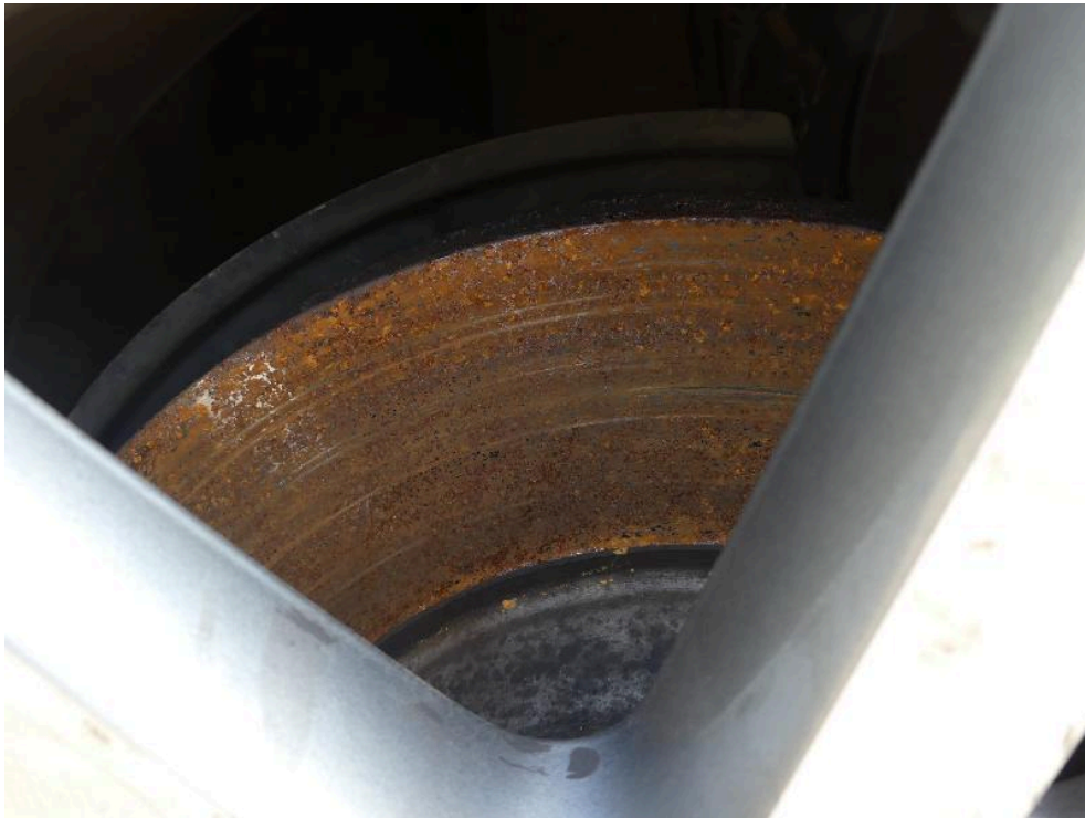
Bild: 51 Bremsanlage erhebliche Standschäden
