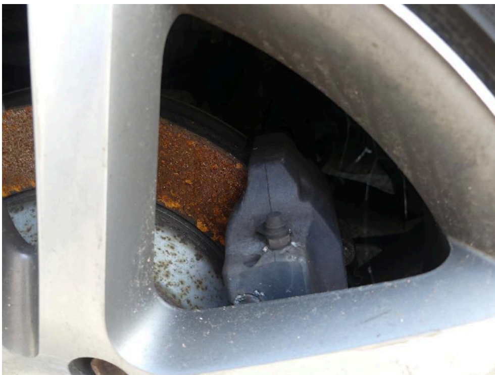
Bild: 55 Bremsscheiben massiv korrodiert.
