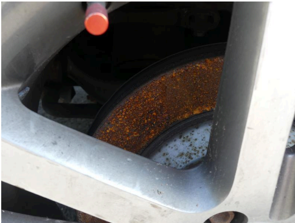
Bild: 54 Hinterachse rechts Bremsanlage -- FEST !!!! --
