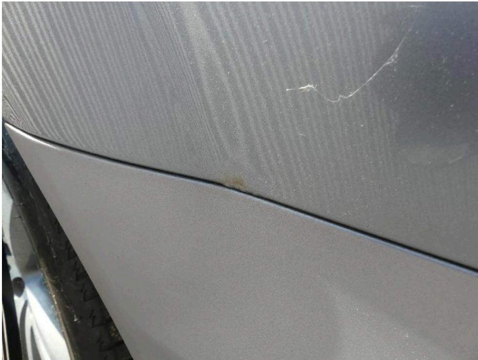
Bild: 75 .... diese ist mehrfach korrodiert.
