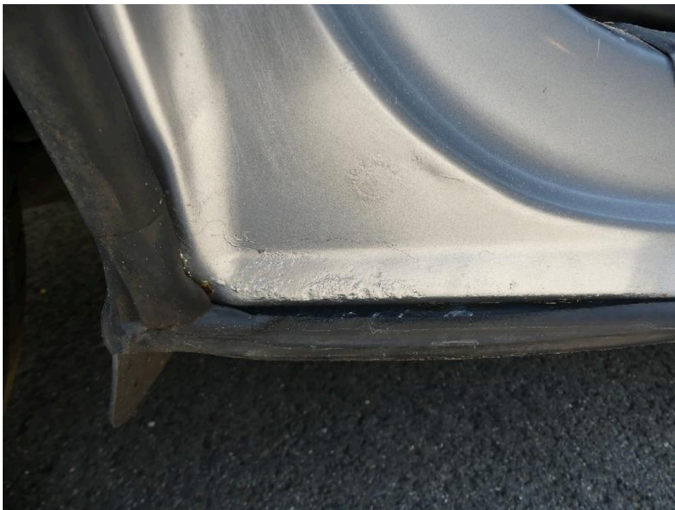
Bild: 88 .... dieser ist sichtbar im Grundmaterial beschädigt.
