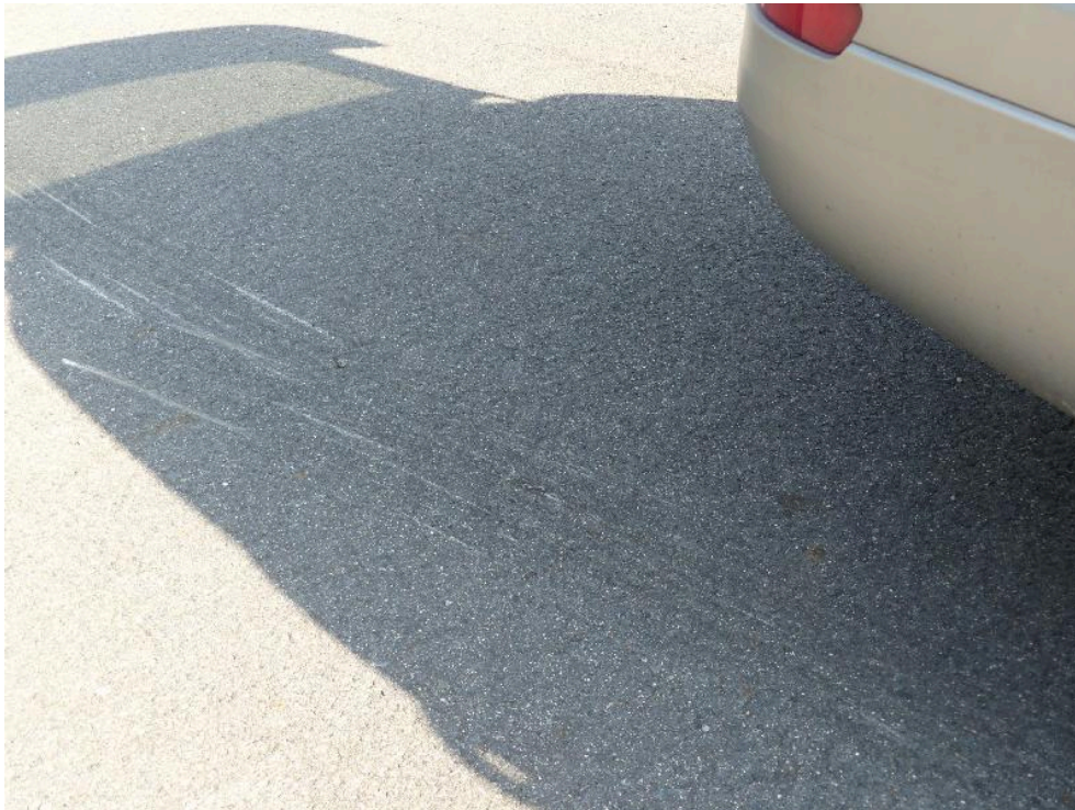
Bild: 56 Laufrad hinten rechtes fest - Standschaden Bremsanlage. Versuch die Bremsanlage hinten rechts durch Fahrtbewegung zu lösen, ist gescheitert.
