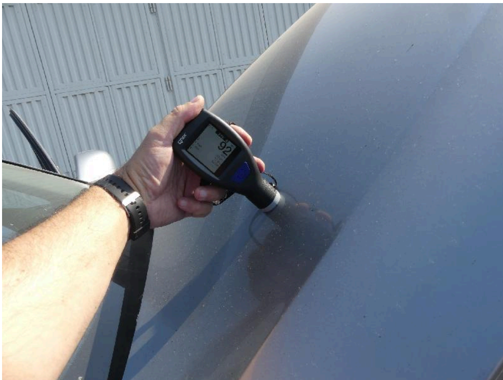
Bild: 67 Ausweisung Lackschichtdickenmessung vorgenommen, Messwerte dem beiliegenden Protokoll entnehmen.
