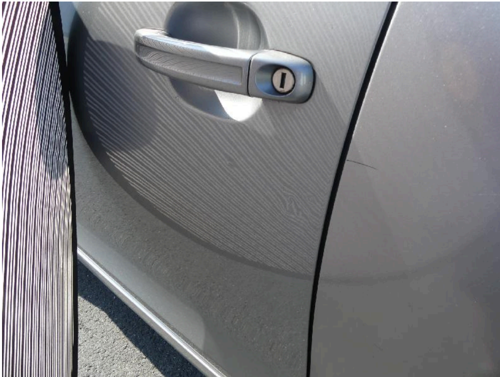
Bild: 71 Ansicht Fahrertür, diese ist im hinteren Segment gestaucht.
