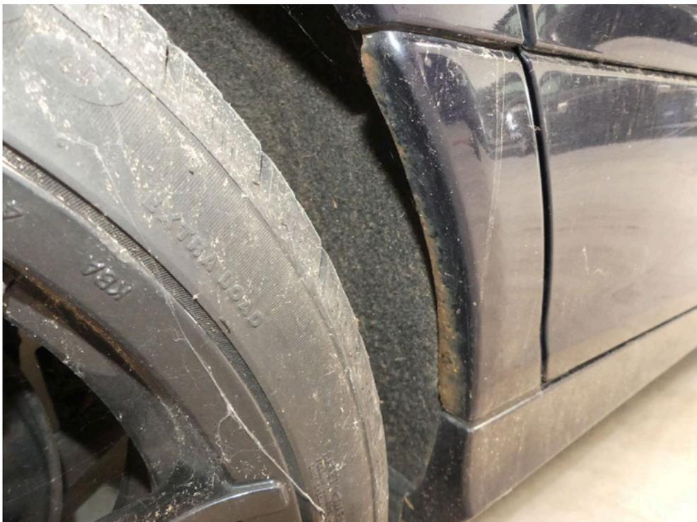
Bild: 40 Korrosionsanatz Seitenwand hinten rechts.
