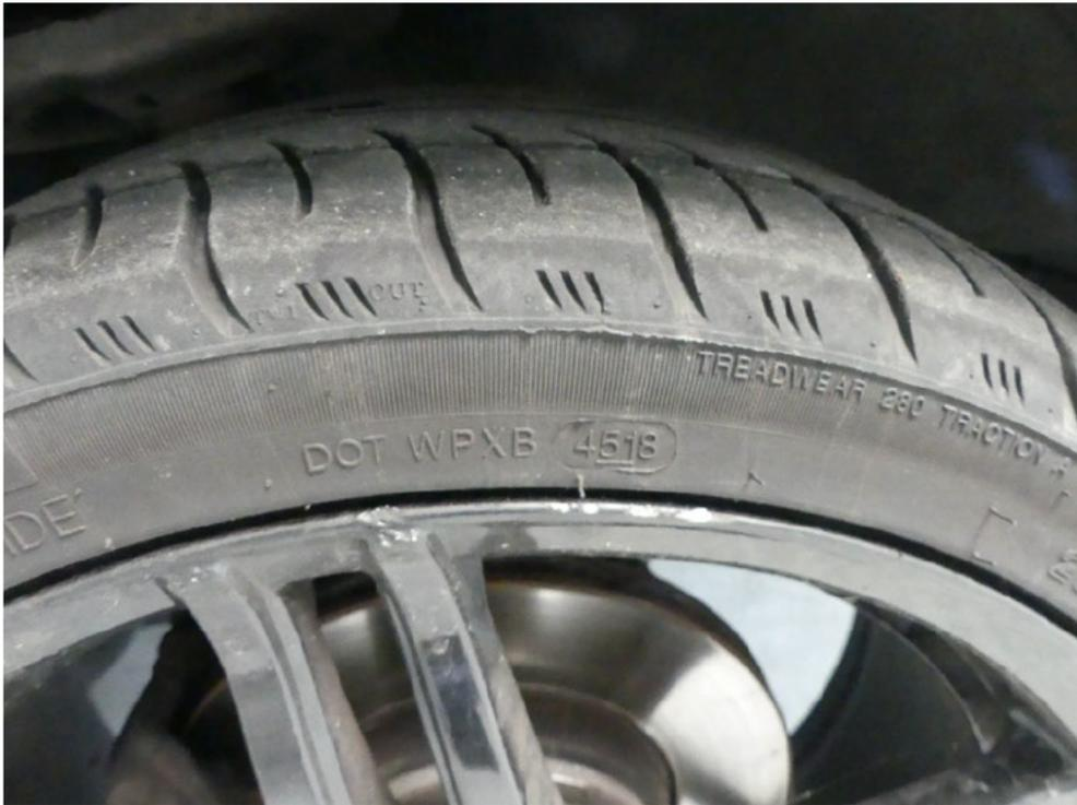
Bild: 33 Ausweisung der DOT Nummer der Radialreifen
