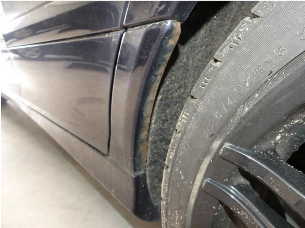
Bild: 37 Korrosionsanatz Seitenwand hinten links.
