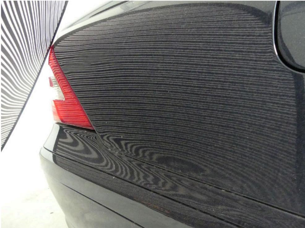
Bild: 39 Detailansicht Seitenwand rechts deformiert. Seitenwand rechts partiell deformiert.
