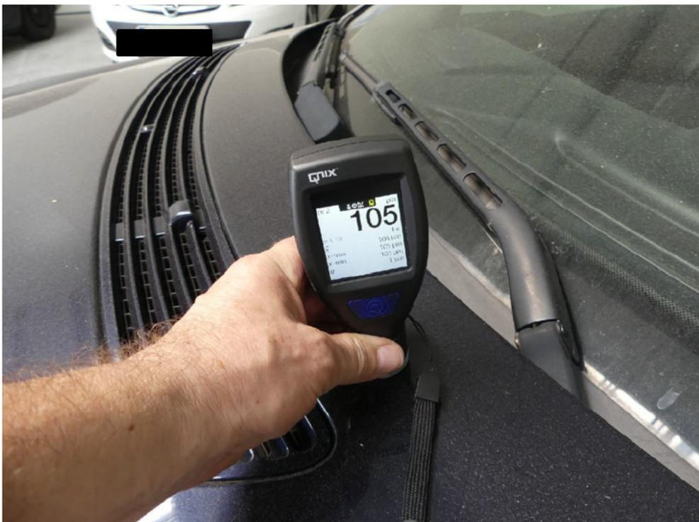
Bild: 34 Ausweisung Lackschichtdickenmessung vorgenommen, Messwerte dem beiliegenden Protokoll entnehmen.
