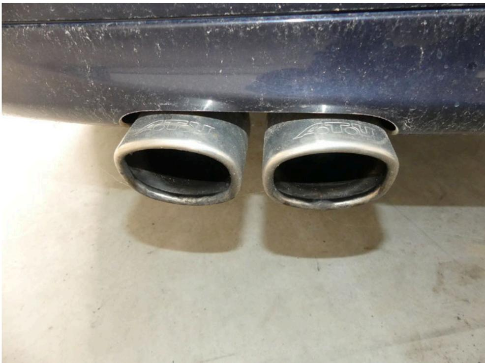
Bild: 26 Detailansicht Endschalldämpfer
