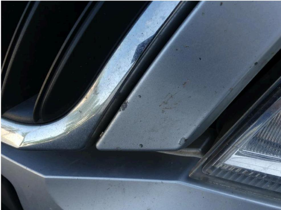
Bild: 53 ... diese weist punktuelle Steinschläge auf. Der Lackaufbau ist sichtbar abgetragen.
