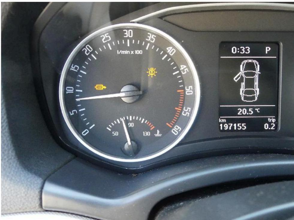
Bild: 15 Hinweisleuchte Dieselpartikelfilter aktiv
