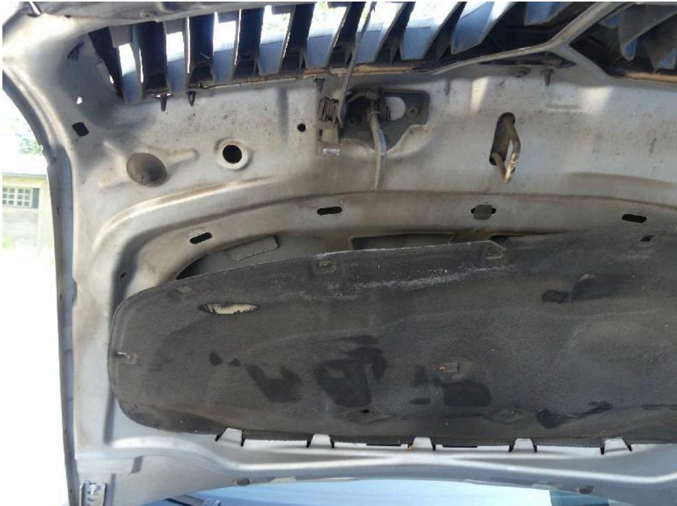
Bild: 45 Detailansicht Geräuschdämpfung Motorhaube
