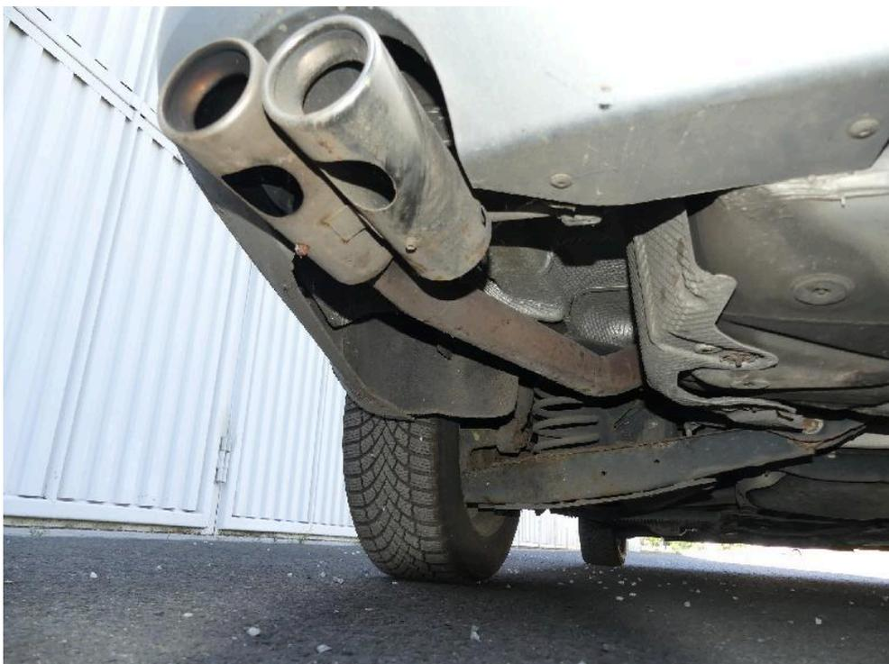
Bild: 50 Detailansicht Abgasrohr, Endrohr A.T.U. verbaut
