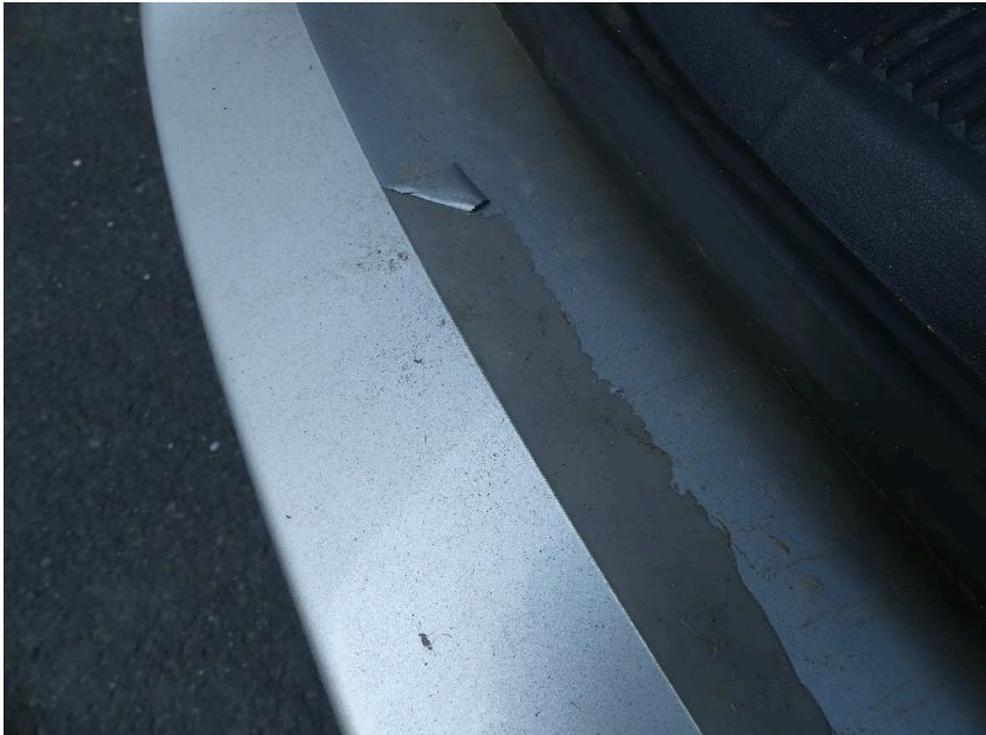
Bild: 49 ... der Lackaufbau ist partiell abgelöst.
