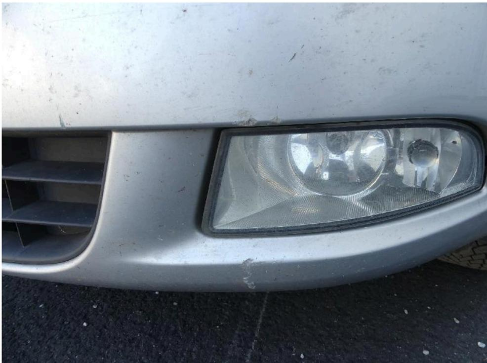
Bild: 44 ... diese ist partiell gestaucht und im Lackaufbau abgetragen.
