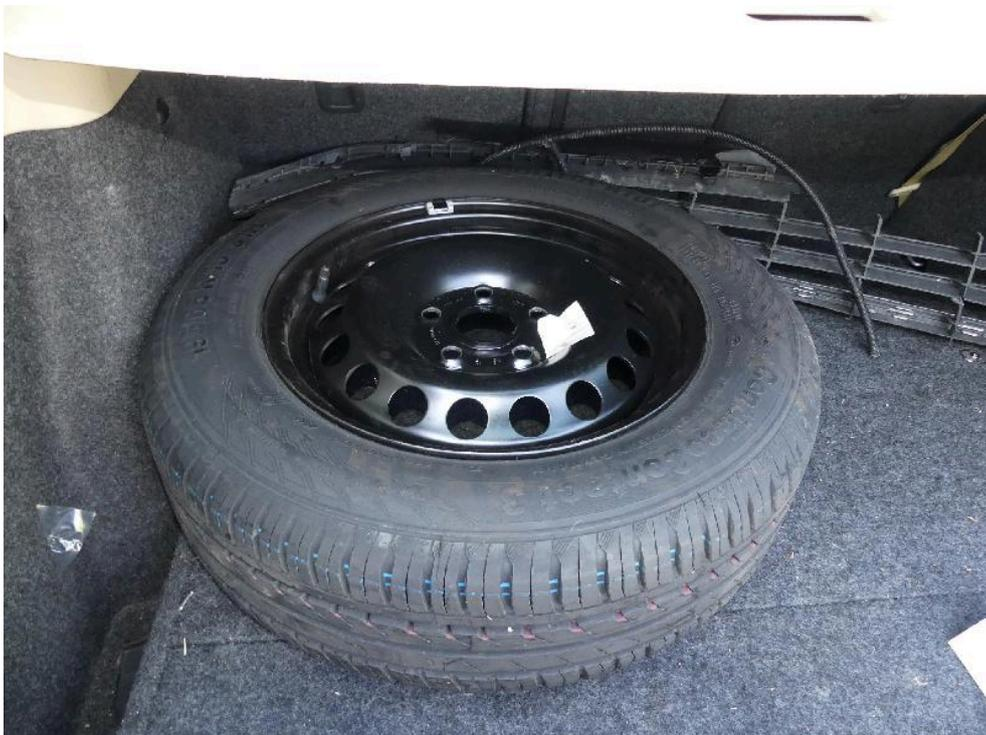
Bild: 30 Laufrad 16 Zoll Stahlfelge im Kofferraum
