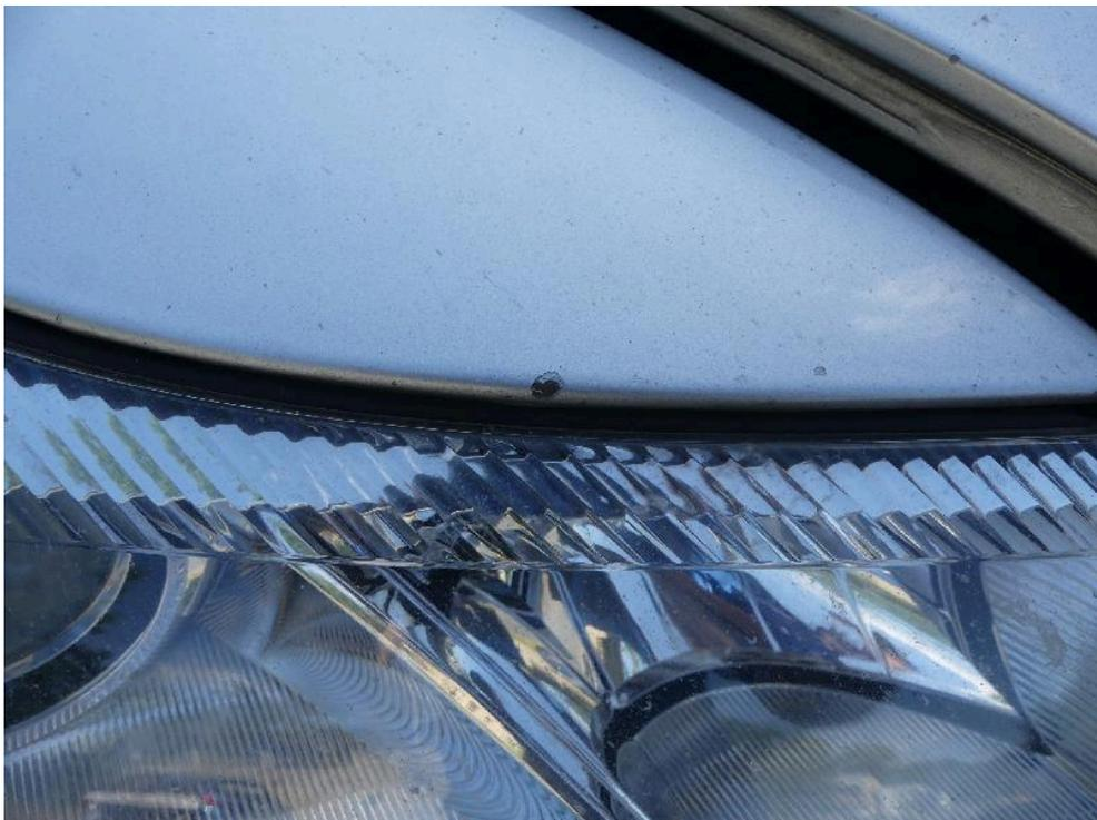
Bild: 54 Kotflügel vorn rechts punktuell im Lackaufbau beschädigt.
