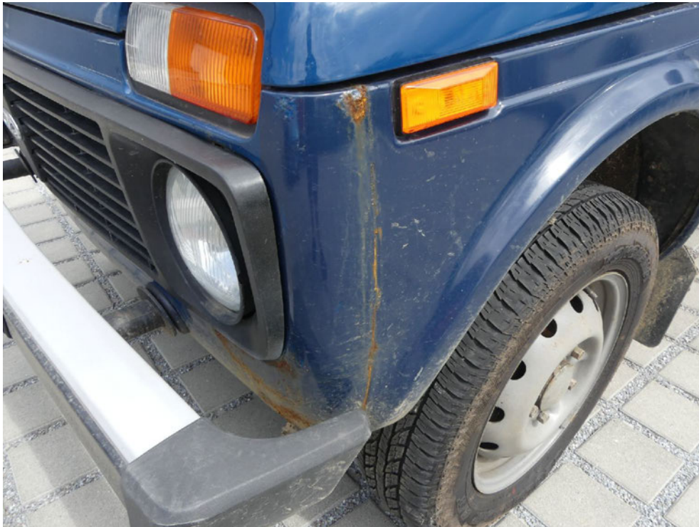
Bild: 25 Detailansicht Kotflügel vorn links
