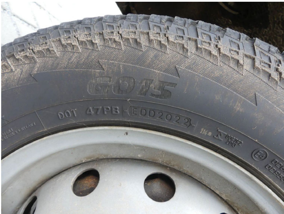
Bild: 22 Ausweisung der DOT Nummer der Radialreifen
