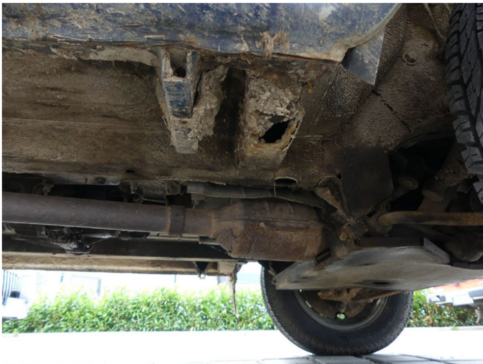
Bild: 36 Durchrostung Unterboden
