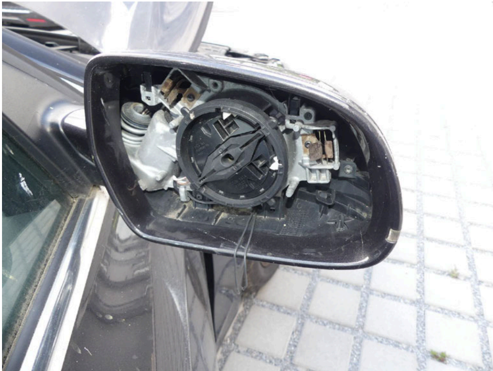
Bild: 49 Spiegelglas rechts fehlt
