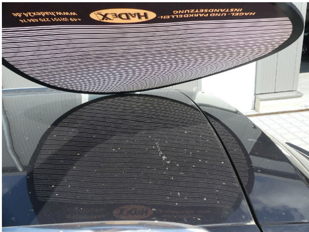
Bild: 63 Dachaußenhaut im hinteren Segment gestaucht.
