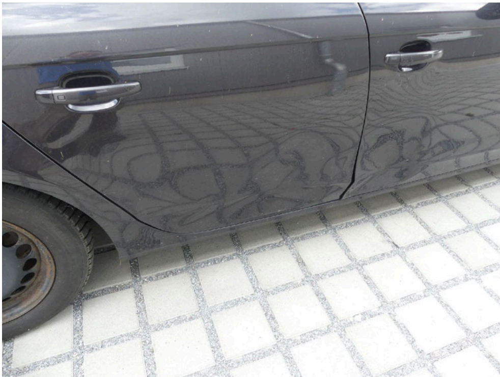
Bild: 53 Ausweisung Unfallschaden rechte Fahrzeugflanke.
