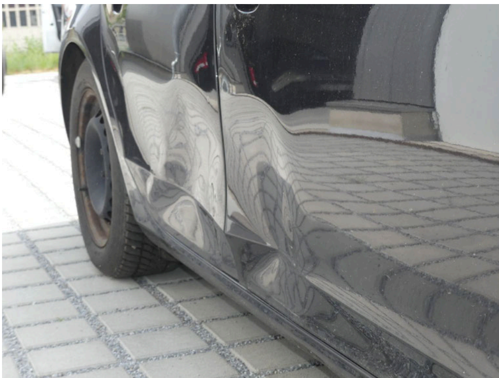
Bild: 54 Ausweisung der Deformationstiefe
