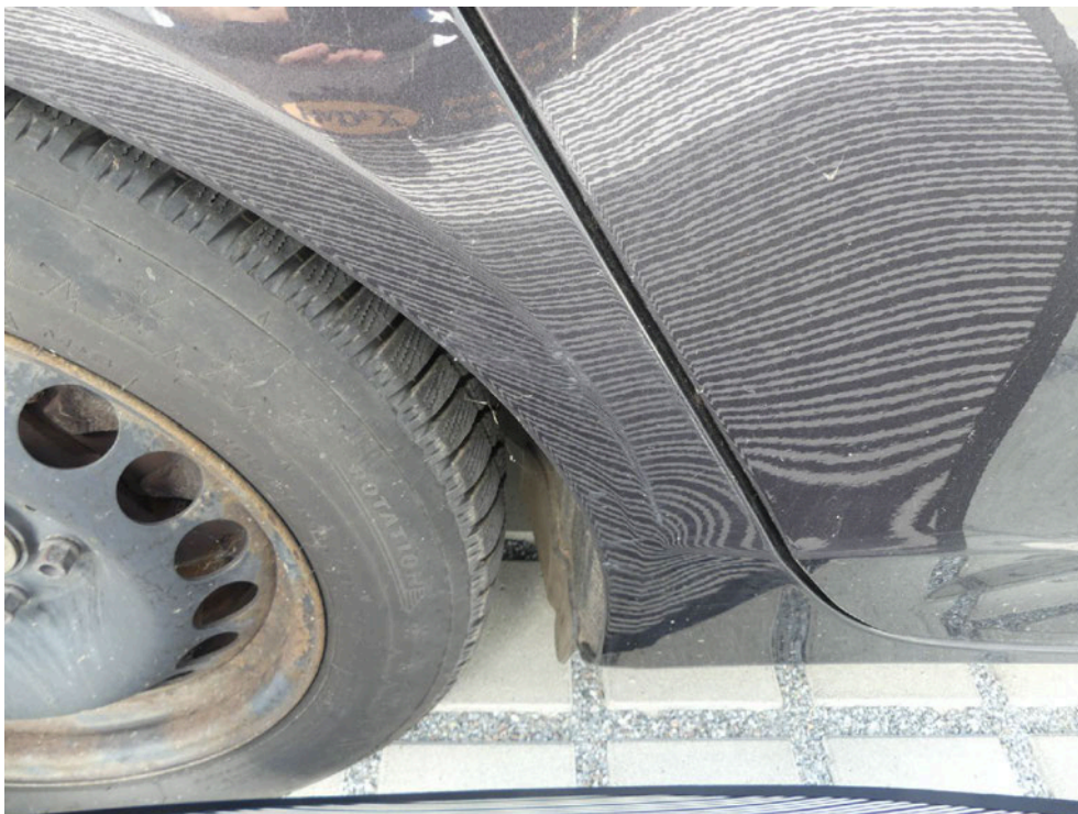
Bild: 58 Radlaufbogen Seitenwand rechts beschädigt
