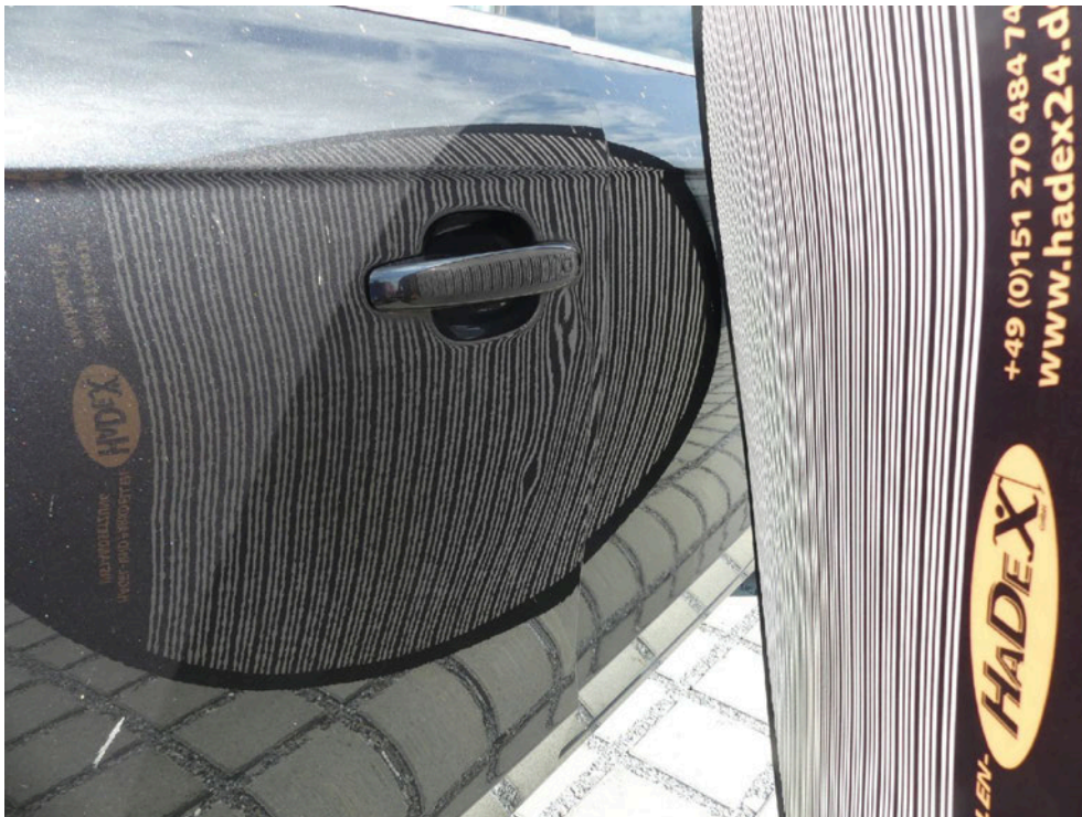
Bild: 67 Fahrertür punktuell deformiert.
