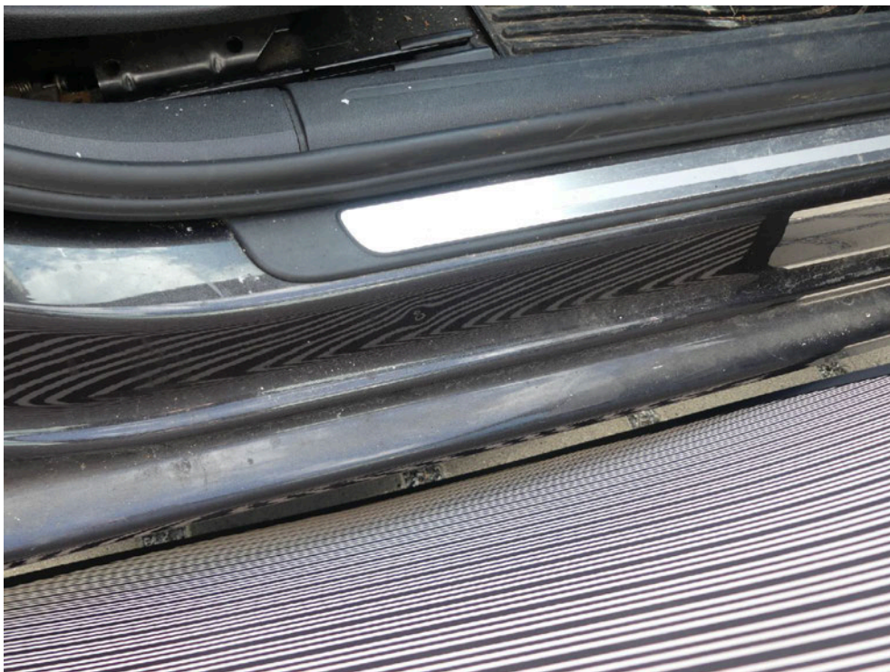
Bild: 60 Weitere Ausweisung Deformation Türeinstiegsschweller.
