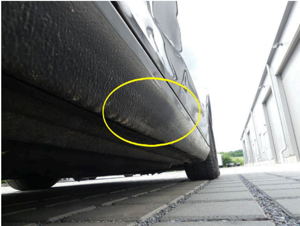
Bild: 61 Einstiegsschweller rechts mittig deformiert.
