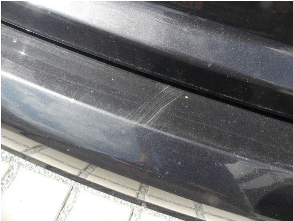
Bild: 65 Ladekante Heckverkleidung im Lackaufbau markiert.
