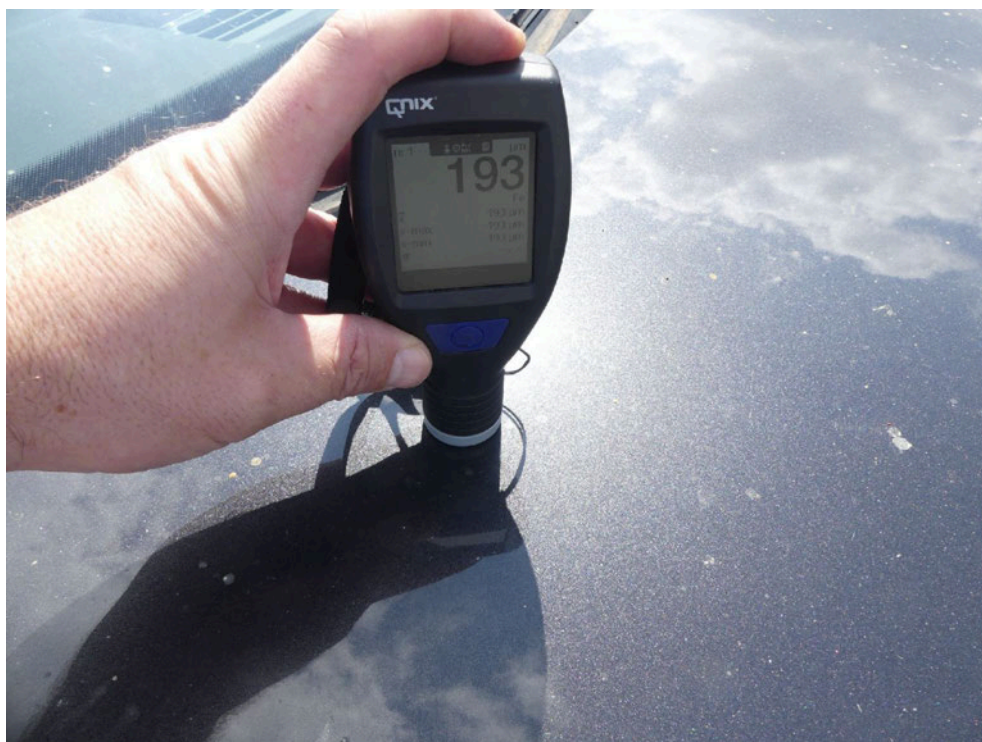
Bild: 48 Ausweisung Lackschichtdickenmessung vorgenommen, Messwerte dem beiliegenden Protokoll entnehmen.
