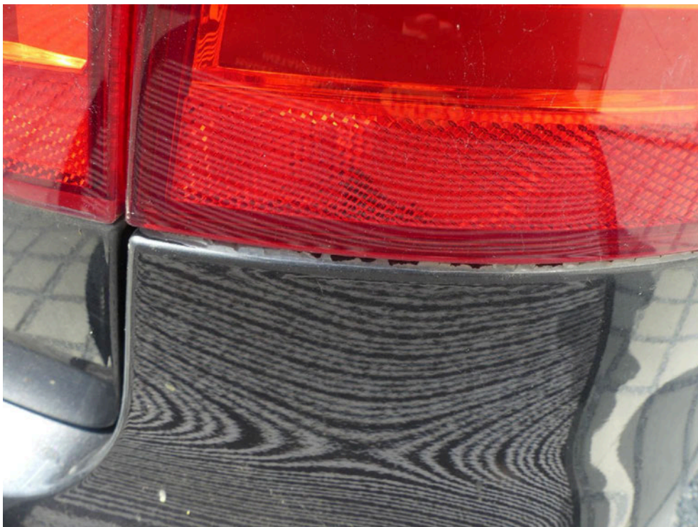
Bild: 66 Klarlackablösung Heckverkleidung unterhalb der Rückleuchteneinheit.
