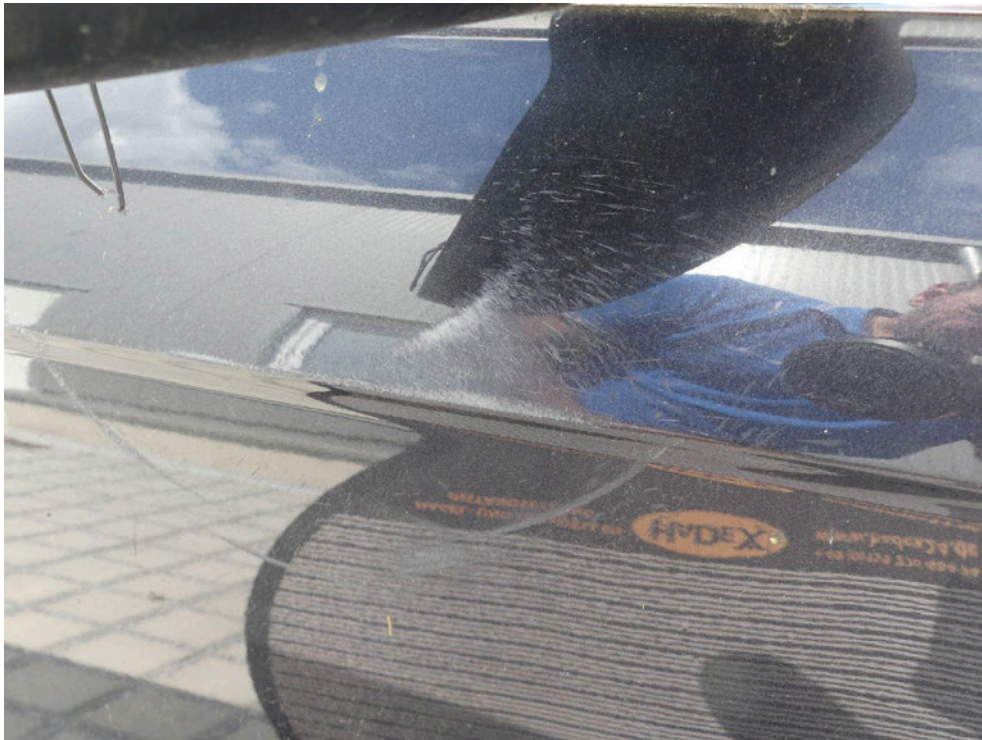
Bild: 51 Explizite Detailansicht Beschädigung Lackaufbau.
