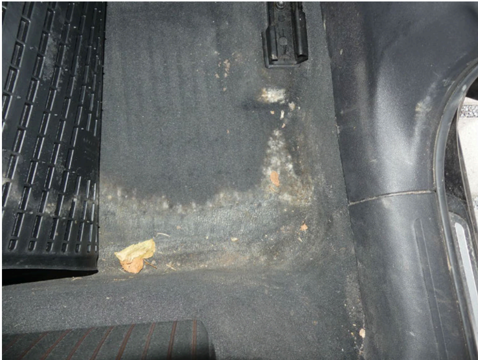
Bild: 33 Detailansicht Fondbereich hinten rechts, Schimmelbildung - Standzeit
