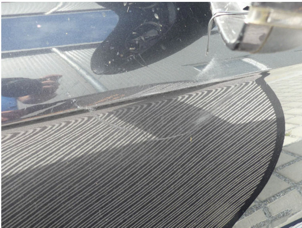
Bild: 50 Türaußenhaut rechts durch auflaufen Spiegelglas im Lackaufbau beschädigt.
