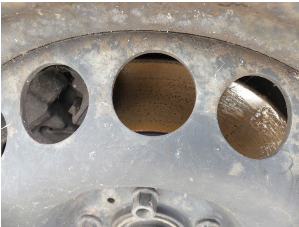
Bild: 14 Ansicht Bremsanlage, signifikante Standschäden vorhanden.
