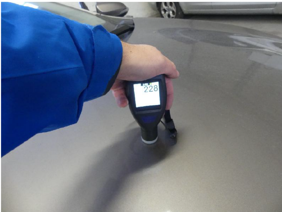
Bild: 10 Ausweisung Lackschichtdickenmessung vorgenommen, Messwerte dem beiliegenden Protokoll entnehmen.
