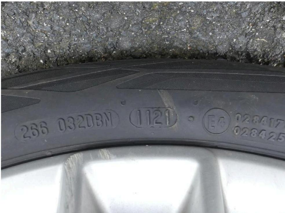
Bild: 28 Ausweisung der DOT Nummer der Radialreifen
