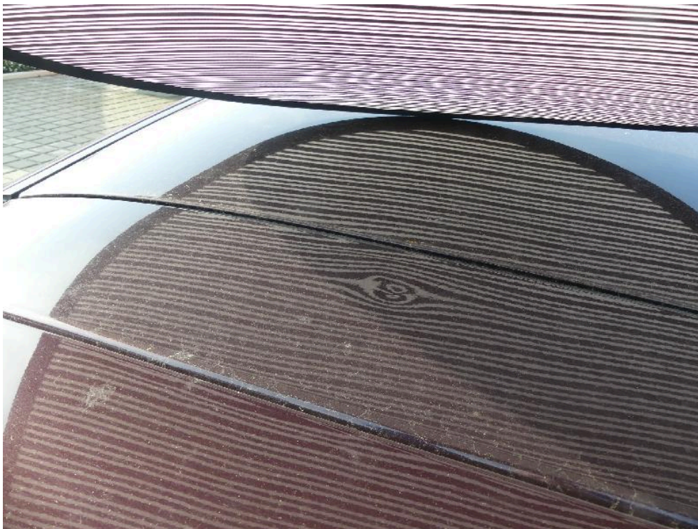
Bild: 44 Ansicht Heckklappe, punktuelle Deformation vorhanden.
