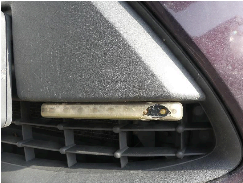
Bild: 51 Linksseitig ist die Tagesfahrleuchte sichtbar durchstoßen.
