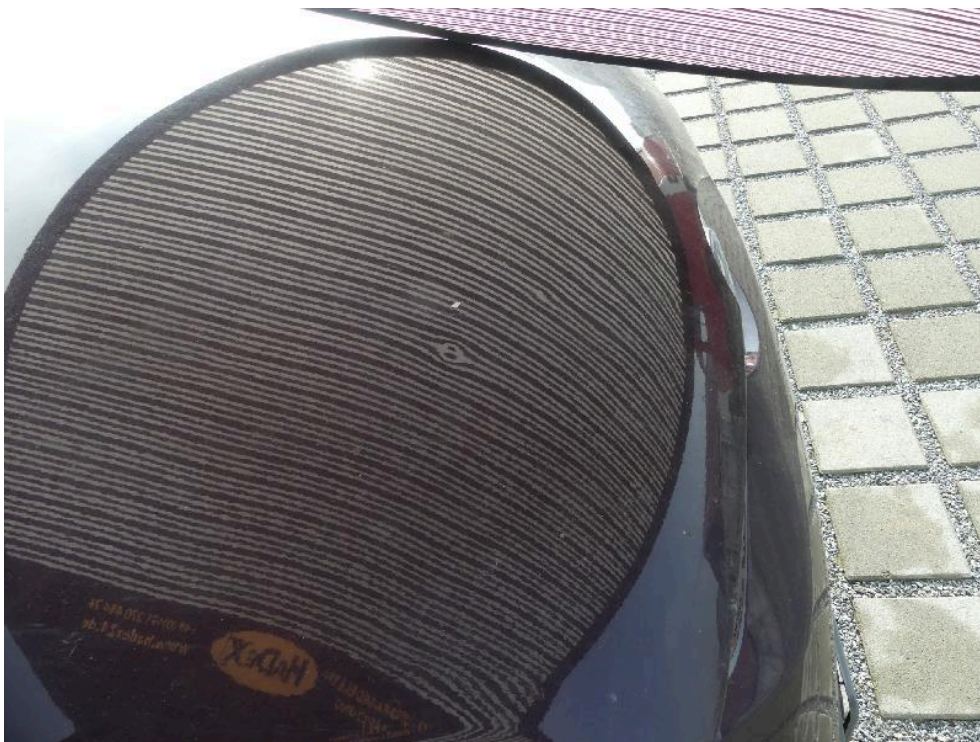
Bild: 52 Punktuelle Eindellung Motorhaube
