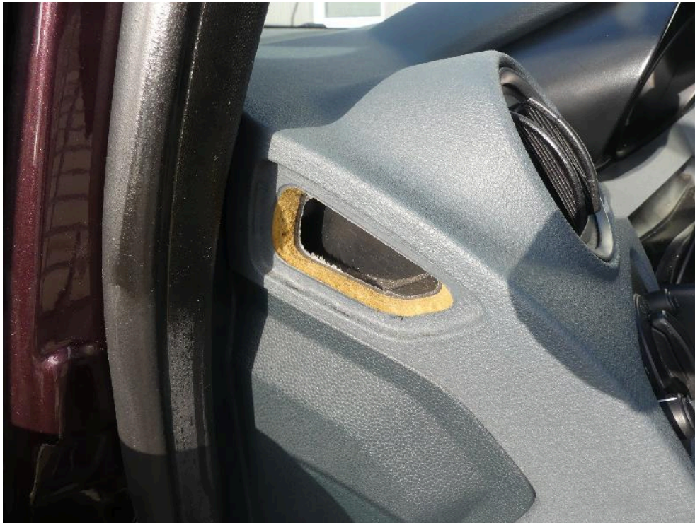
Bild: 41 Luftaustrittsdüse Schalttafel links fehlt
