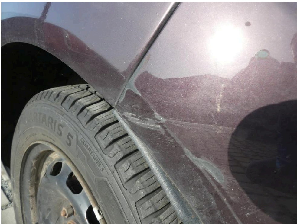
Bild: 40 ... diese ist streifend im Lackaufbau abgetragen.
