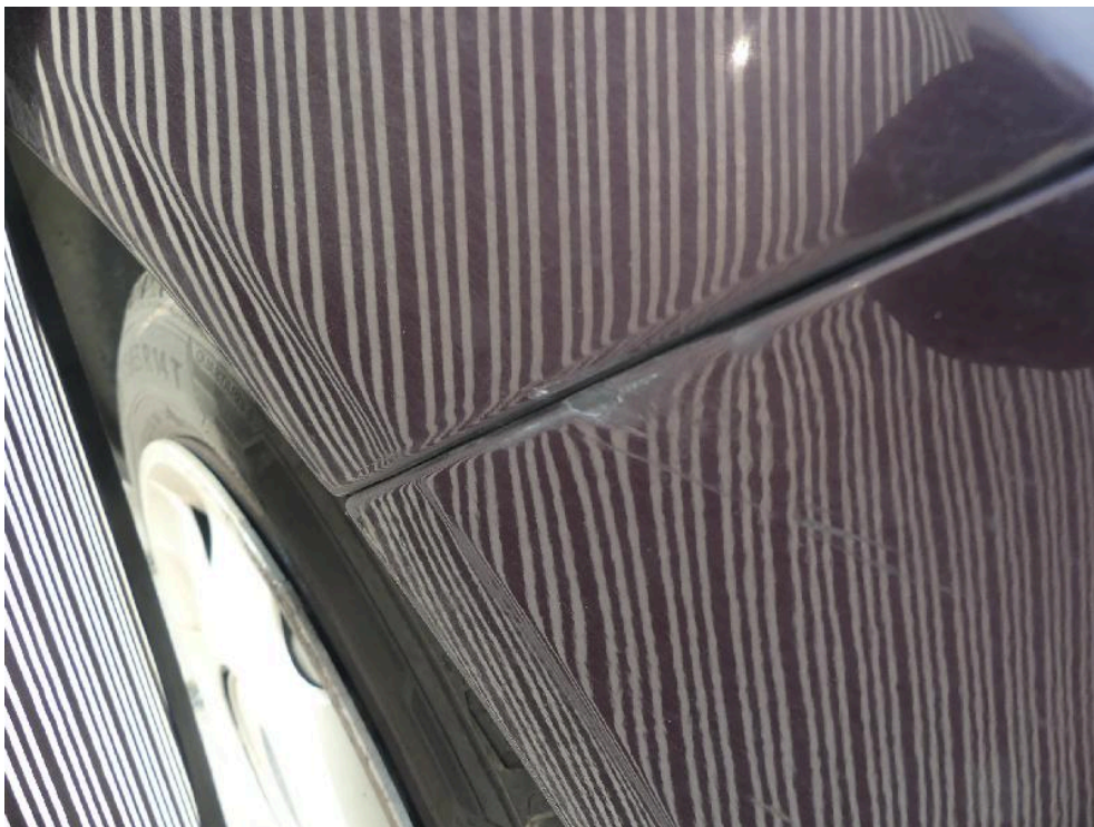
Bild: 48 Weiterführend ist der Kotflügel sowie Frontverkleidung im Lackaufbau markiert.
