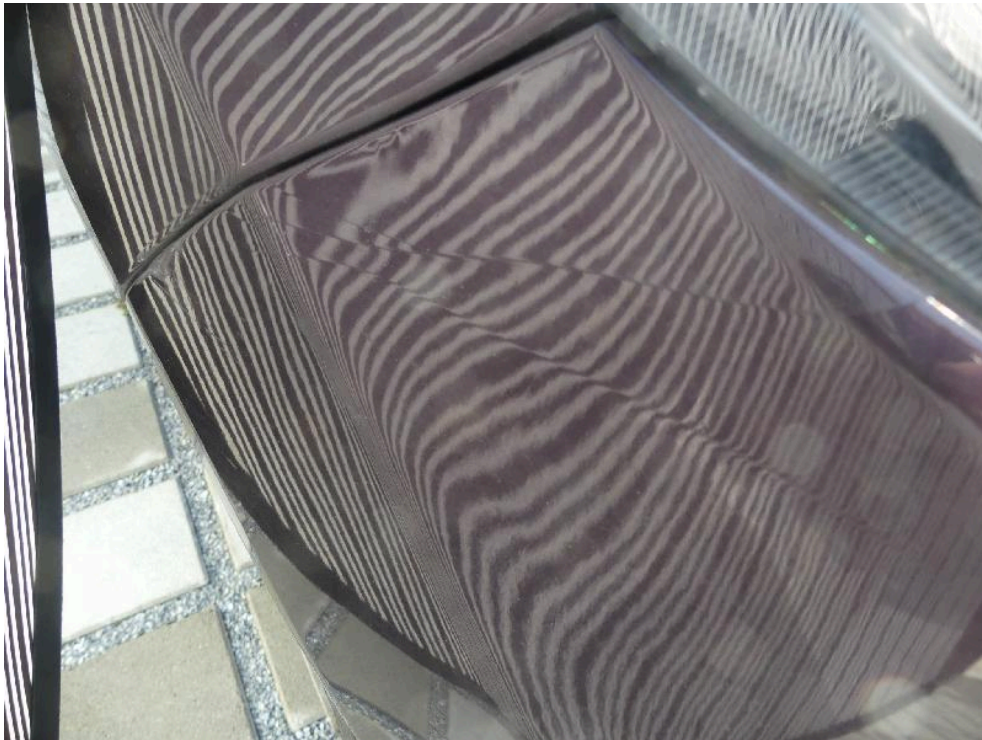
Bild: 47 ... der Lackaufbau ist signifikant gerissen.
