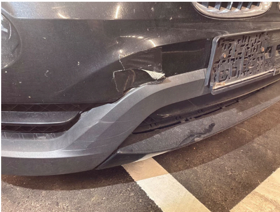
Bild: 59 Abdeckung Abschleppöse vorn rechts fehlt - abgedeckt mittels Klebeband. Zusätzlich ist der strukturierte Abschnitt beaufschlagt.
