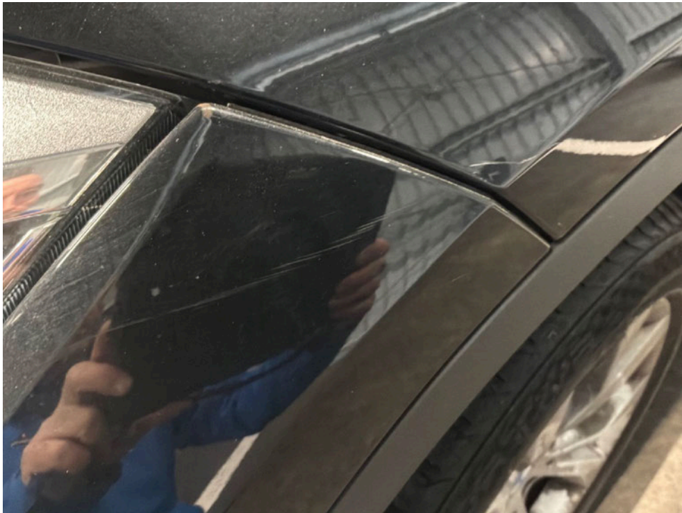
Bild: 60 Die Frontverkleidung ist linksseitig im Lackaufbau verkratzt.
