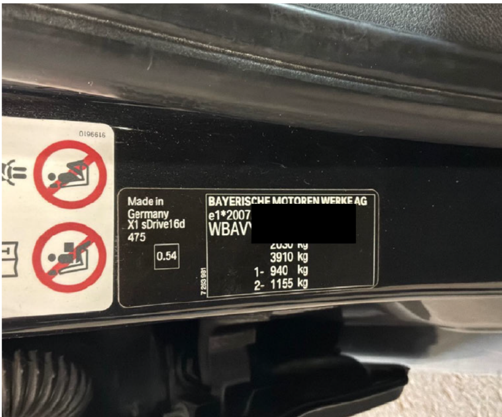
Bild: 32 Ausweisung Fahrzeugidentnummer mittels Kensschild
