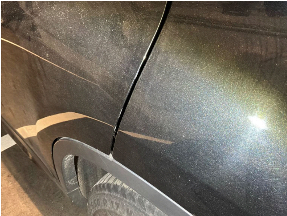
Bild: 66 Ansicht Fondtür links, die hintere Türfalzkante ist partiell im Lackaufbau abgetragen.
