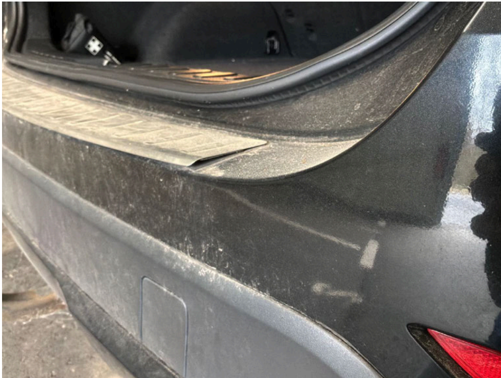
Bild: 70 Abdeckung Ladekante Heckverkleidung löst sich rechtsseitig partiell ab.
