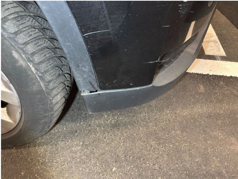
Bild: 56 Ansicht wie vor, veränderte Perspektive, Spoileransatz in der Einbaulage versetzt.
