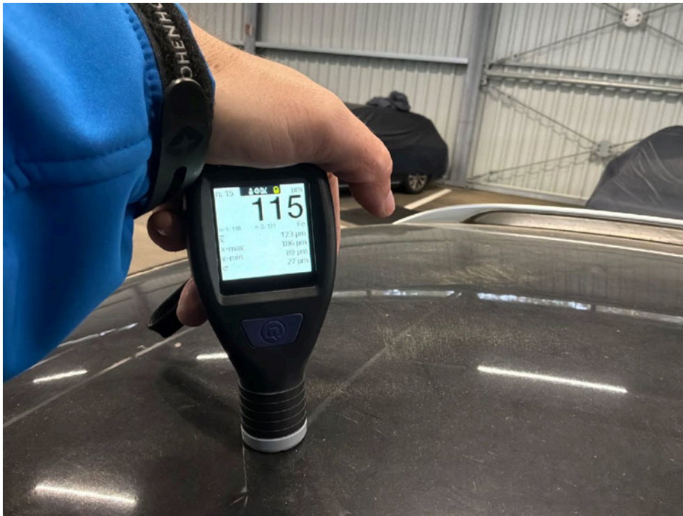
Bild: 14 Ausweisung Lackschichtdickenmessung vorgenommen, Messwerte dem beiliegenden Protokoll entnehmen.
