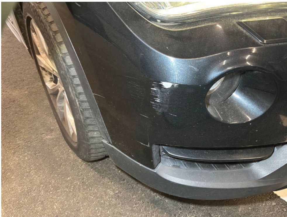
Bild: 55 Ansicht Frontverkleidung, diese ist rechtsseitig streifend beschädigt.
