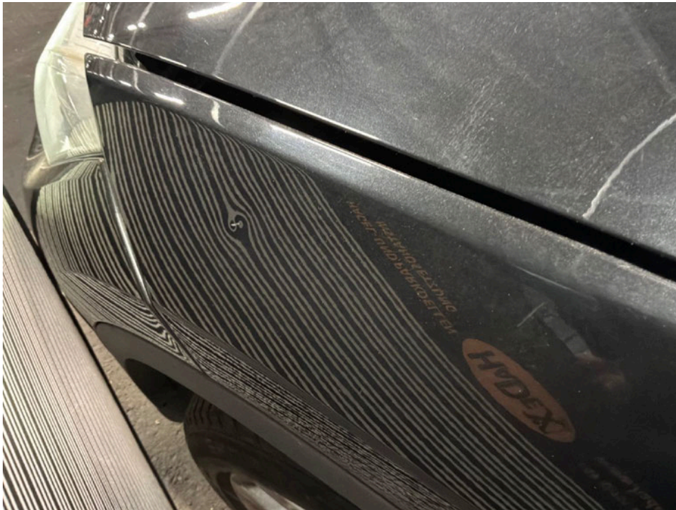
Bild: 62 Kotflügel vorn rechts punktuell gestaucht mit Beschädigung Lackaufbau.
