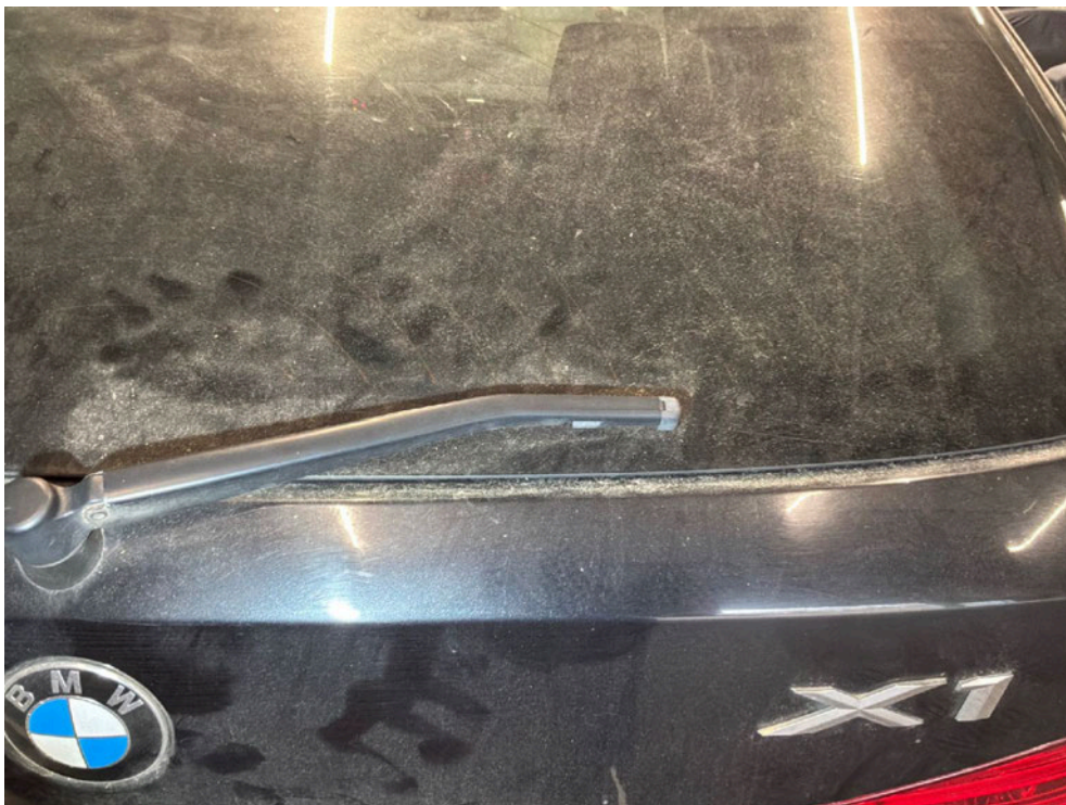
Bild: 69 Heckscheibenwischerblatt fehlt
