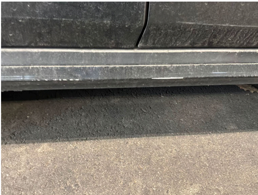
Bild: 77 ... die Abdeckung ist streifend markiert.
