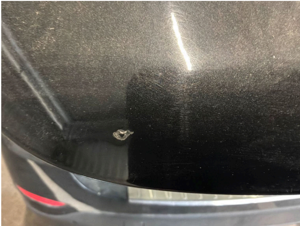
Bild: 68 Lackschaden Heckklappe linkseitig im unteren Segment.
