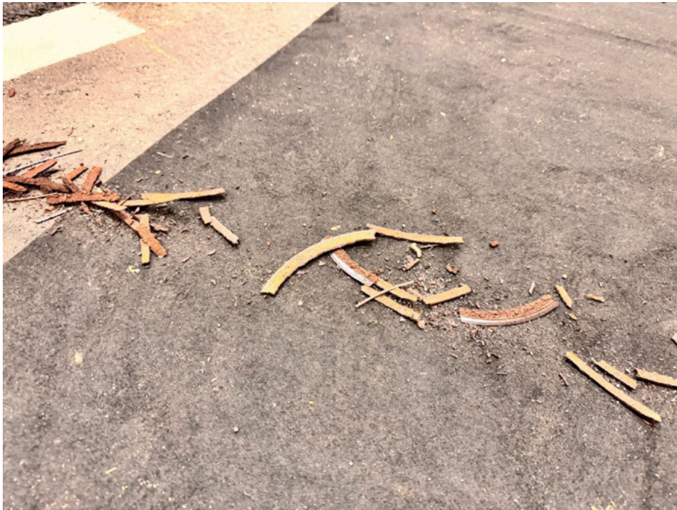
Bild: 25 Feststellbremse ist fest, im Versuch das Fahrzeug auszuparken, partiell Ablösung Material Bremsscheibe und Bremsbelag Hinterachse.
