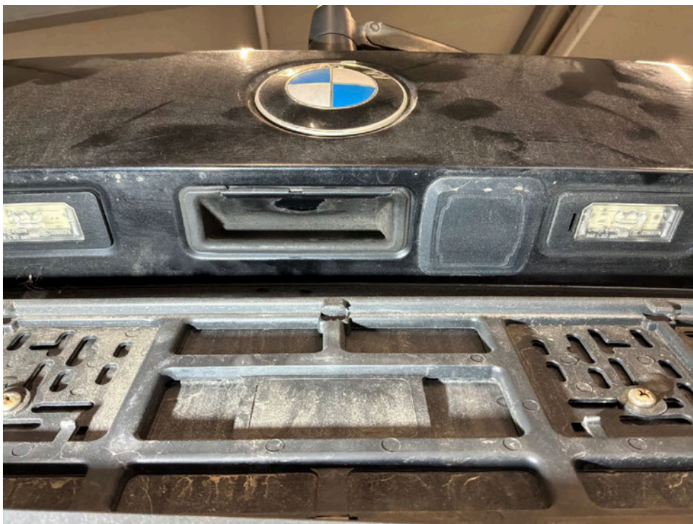
Bild: 67 Taster Heckklappe verschlissen
