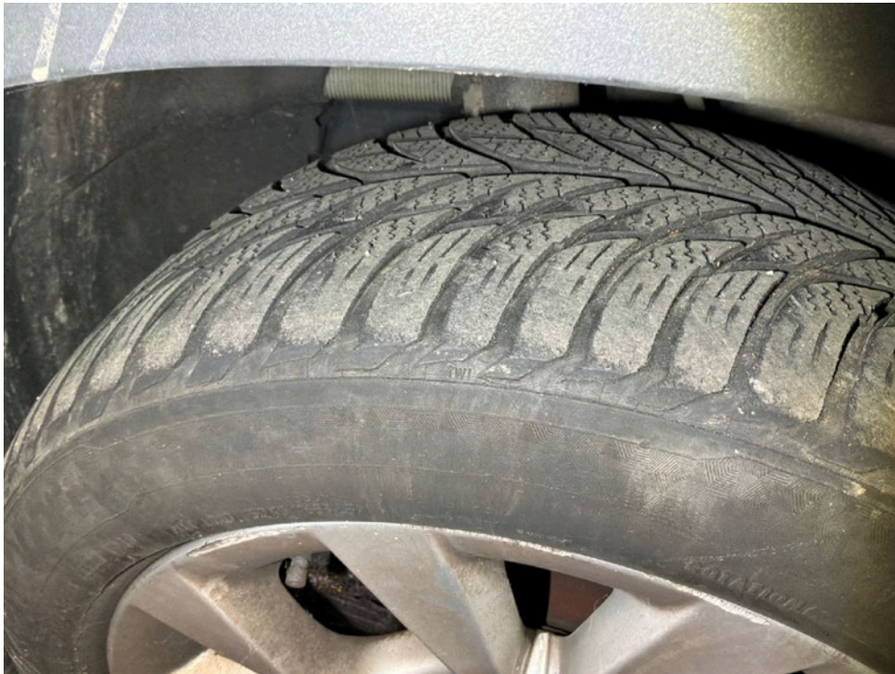
Bild: 21 Ansicht Reifen, diese sind sichtbar auf der Außenseite abgefahren.
