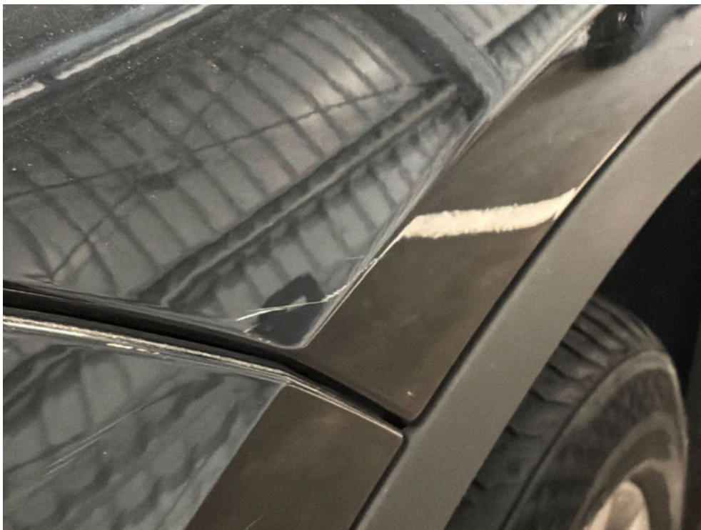
Bild: 61 Weiterführend ist ebenso der linke vordere Kotflügel im Lackaufbau markiert.
