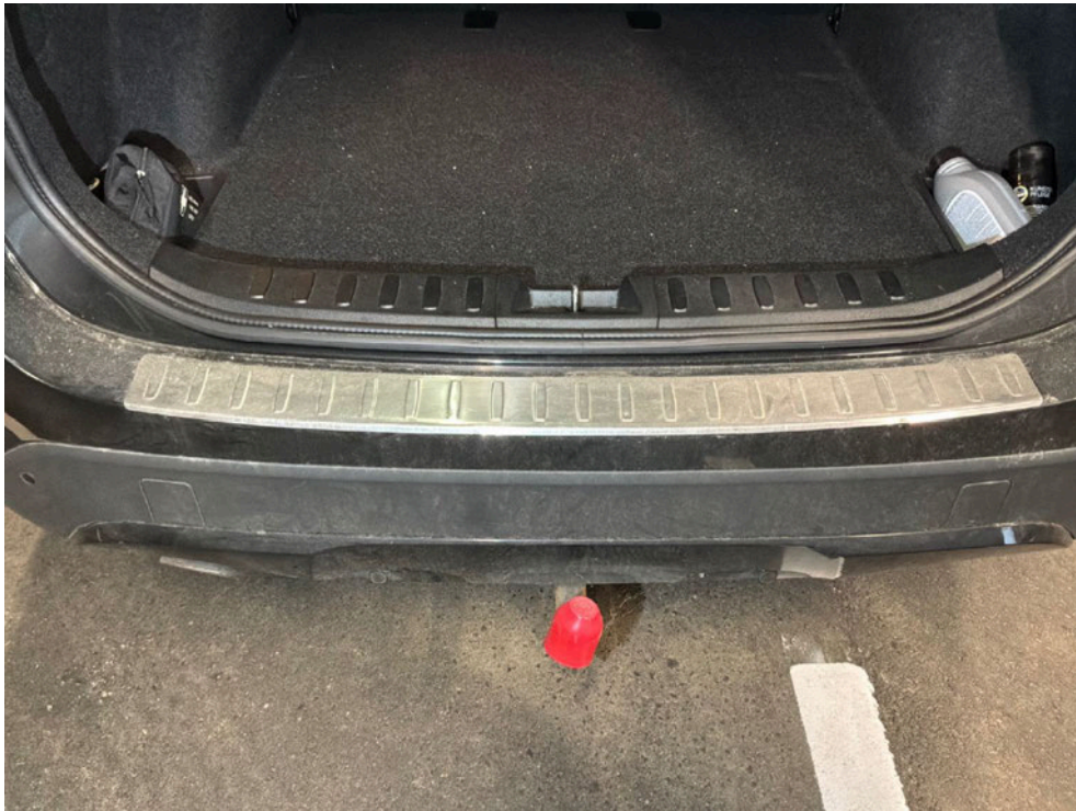
Bild: 39 Ladekantenschutz nachgerüstet.
