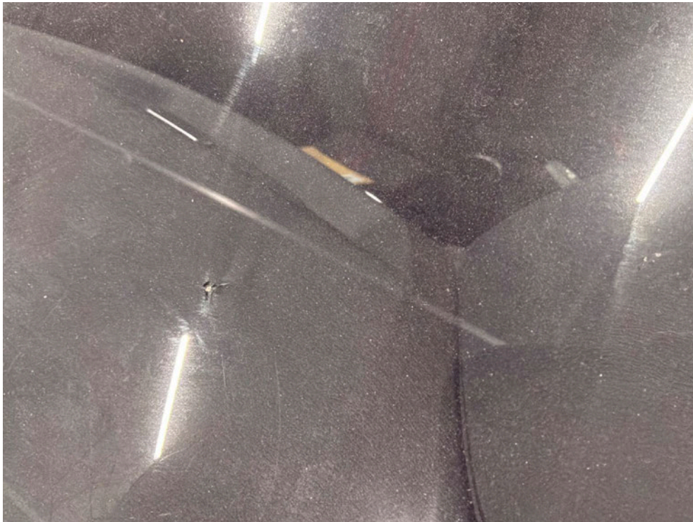
Bild: 64 ... Steinschlag im mittleren Bereich.
