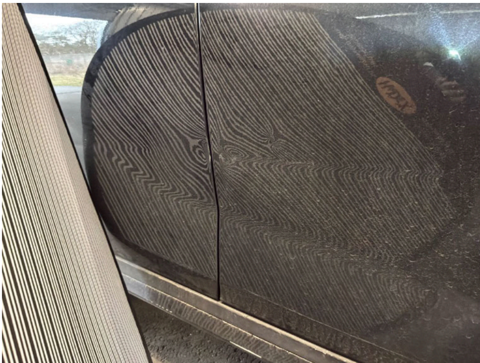
Bild: 73 Beide Fahrzeugtüren rechts deformiert.
