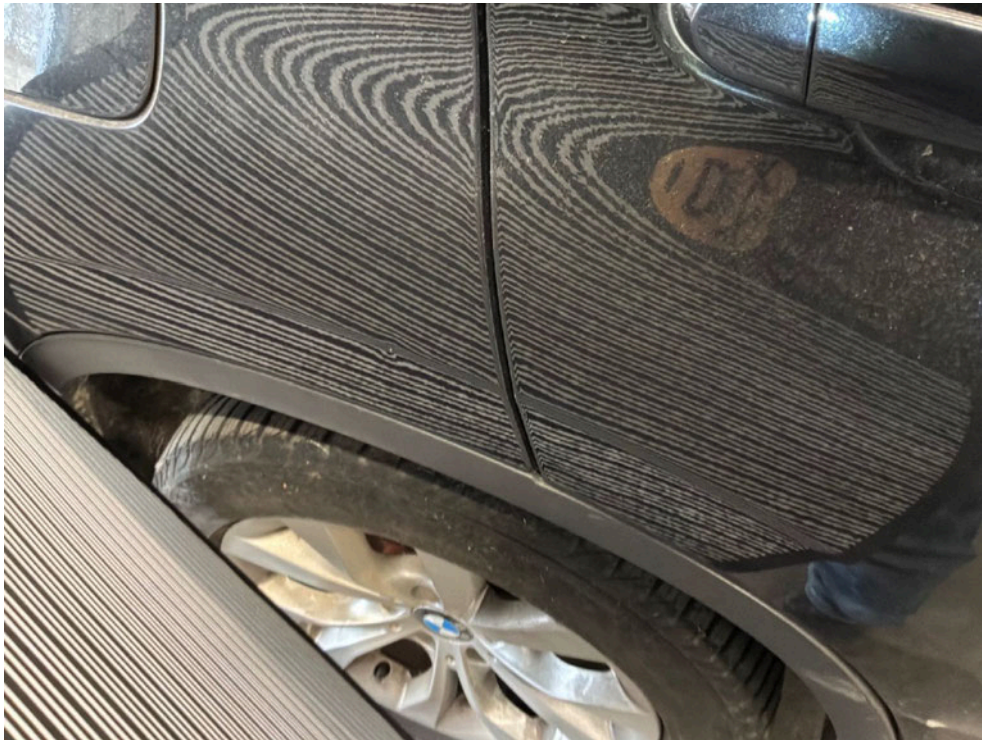
Bild: 74 Detailansicht Seitenwand, diese ist partiell im Übergang Seitenwand gestaucht.
