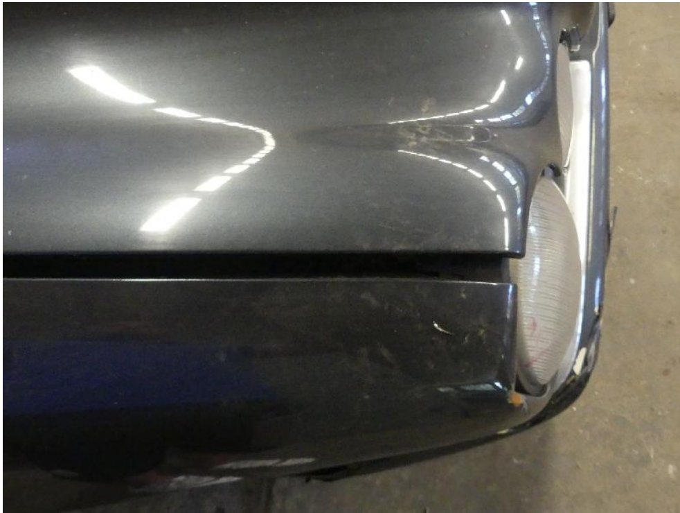
Bild: 41 Einbaulage Kotflügel nach außen versetzt.
