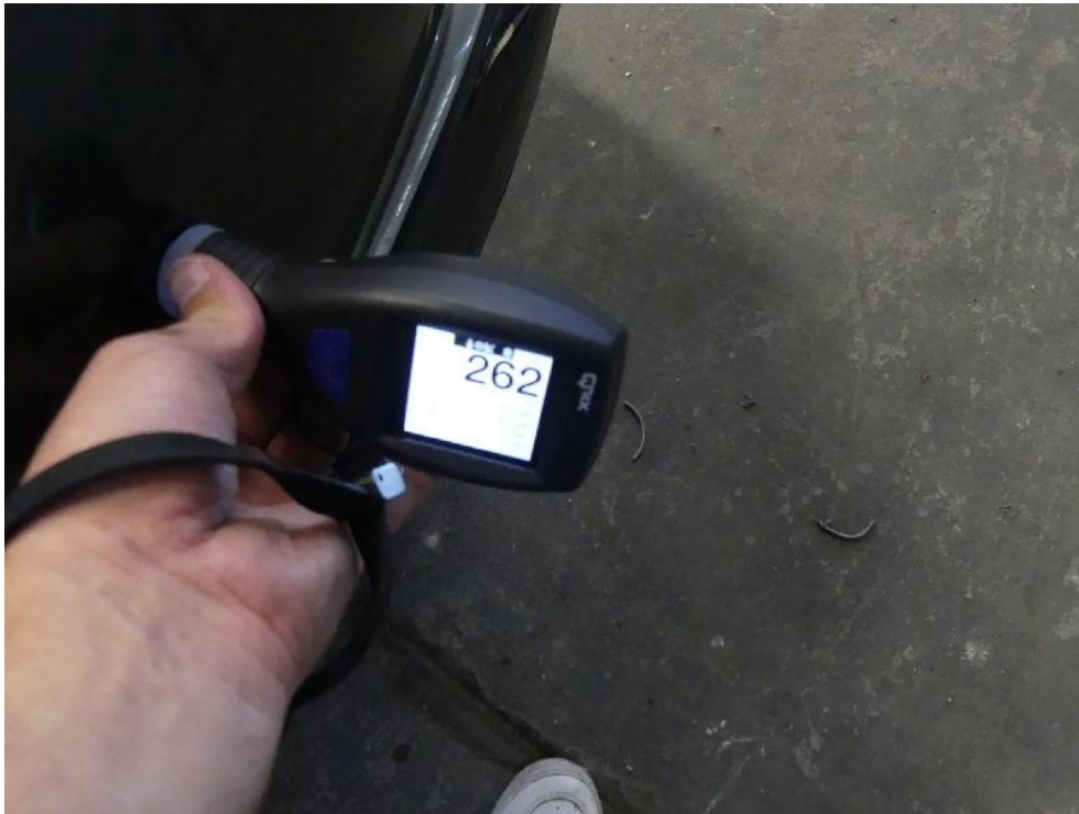
Bild: 45 Lackschichtdickenmessung vorgenommen, Protokoll ist in der Bewertung offengelegt.
