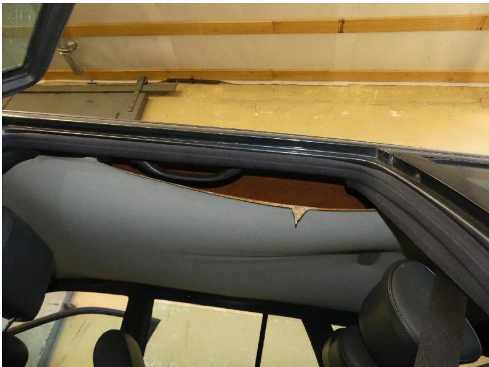
Bild: 32 Explizite Detailansicht Ablösung Innenhimmel
