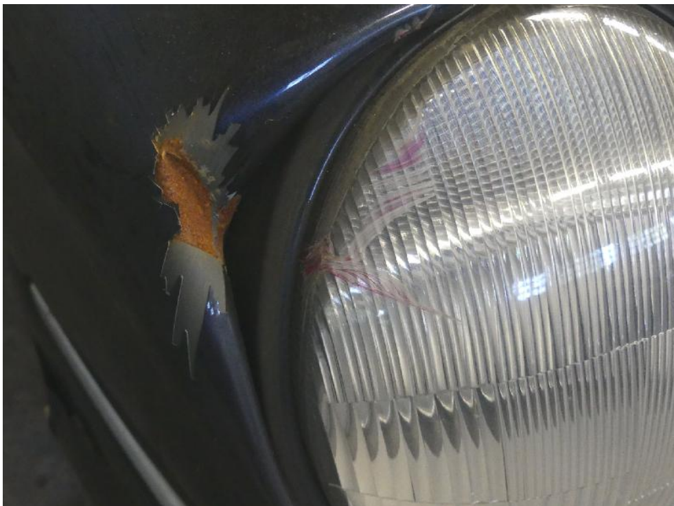
Bild: 40 Hauptscheinwerfer rechts in der Streuscheibe gebrochen.
