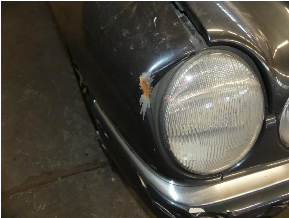
Bild: 39 Kotflügel vorn rechts deformiert.
