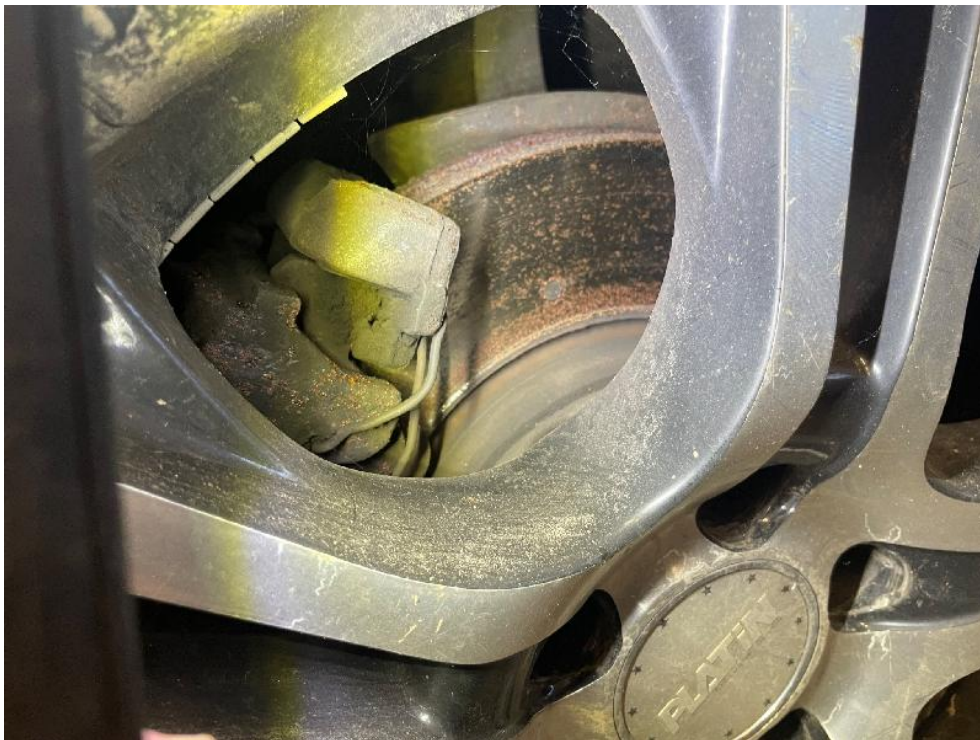
Bild: 46 Ansicht Bremsanlage, Standschäden sind erkennbar
