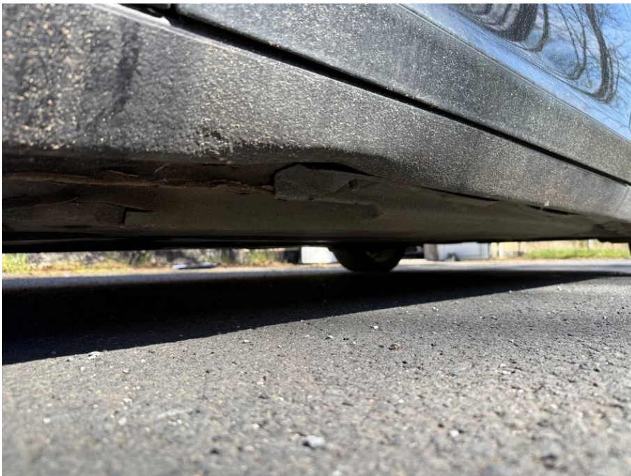
Linker Schweller eingedrückt
