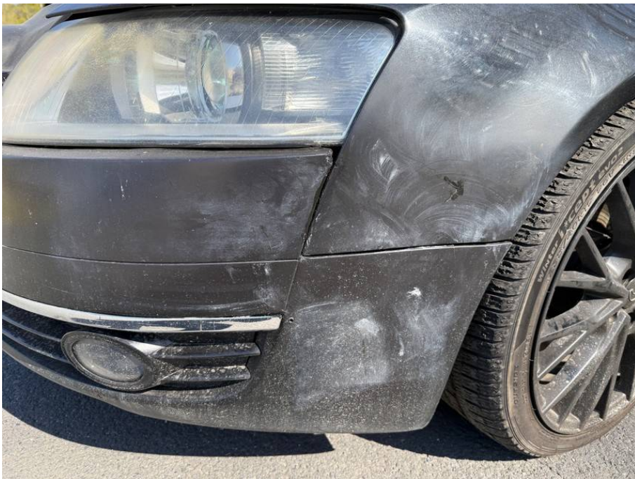
Frontverkleidung linksseitig gebrochen
