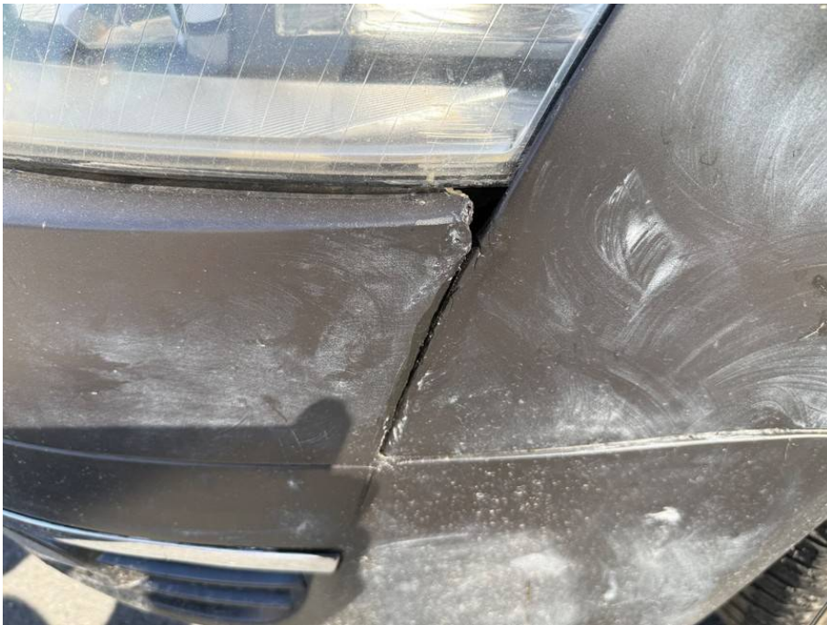
Frontverkleidung linksseitig gebrochen, Kotflügel beschädigt
