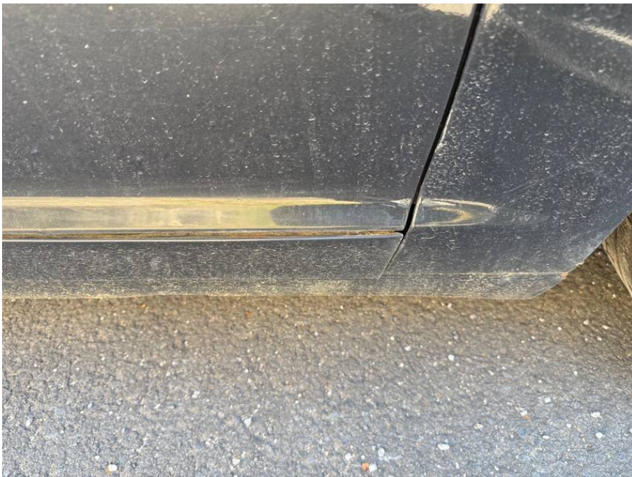
Stoßleiste unten Tür v.r. gelöst
