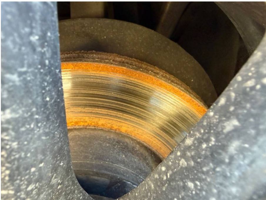
Bremsscheiben rundum stark korrodiert
