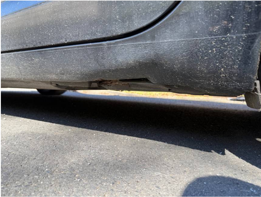
Linker Schweller eingedrückt
