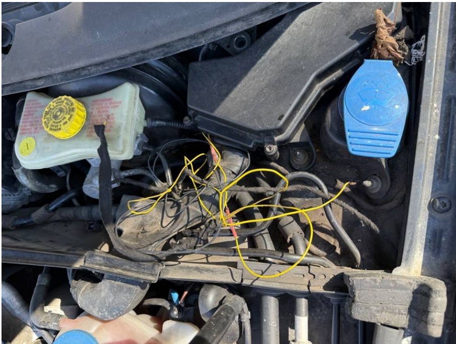
Kabel/Leitungen in Eigenbau zusätzlich angebracht, Funktion unklar
