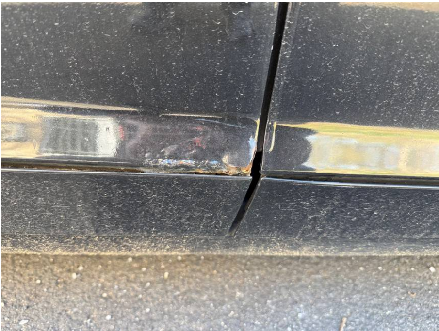
Korrosion Tür h.r.
