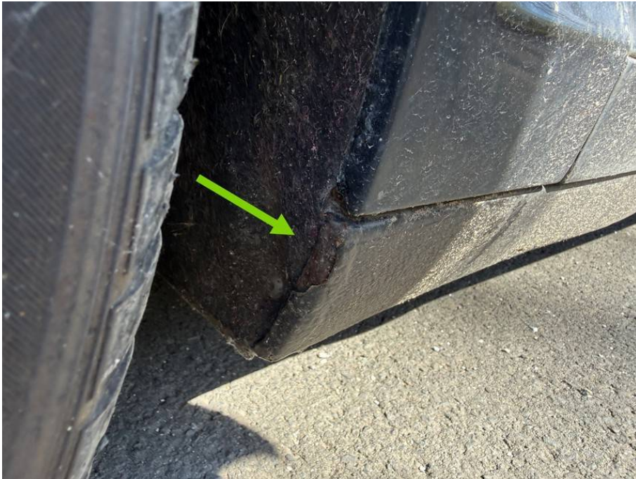
Korrosion Schweller links
