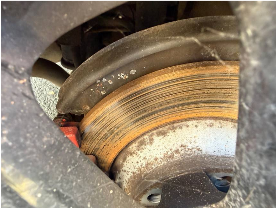
Bremsscheiben rundum stark korrodiert
