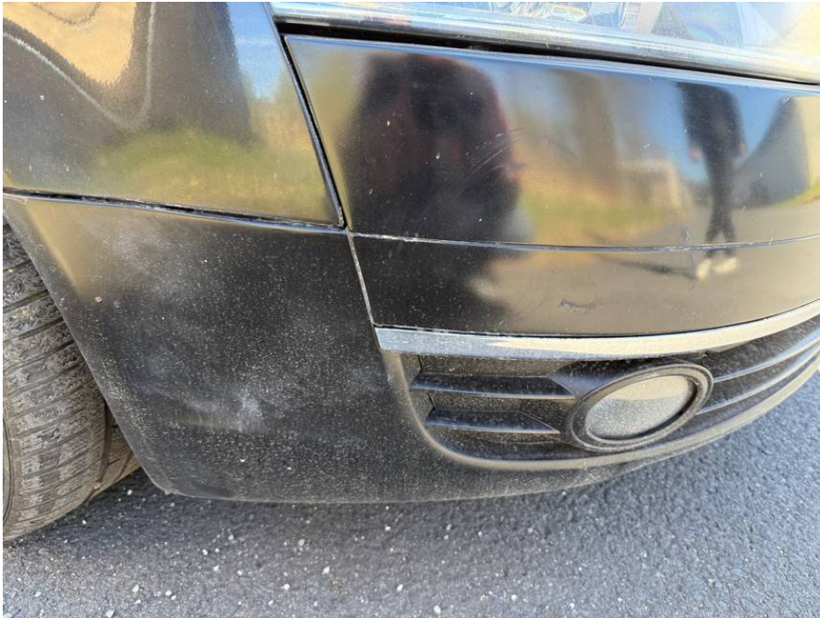
Frontverkleidung rechtsseitig beschädigt
