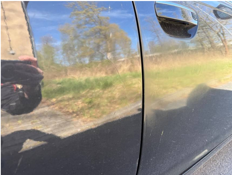
Türen rechts unsachgemäß überlackiert
