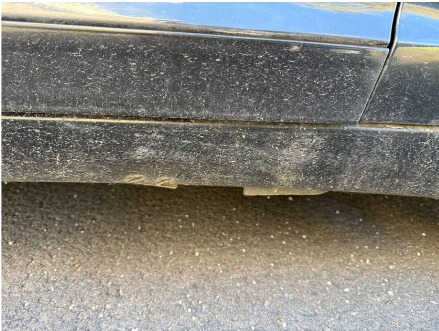
Schweller rechts eingedrückt
