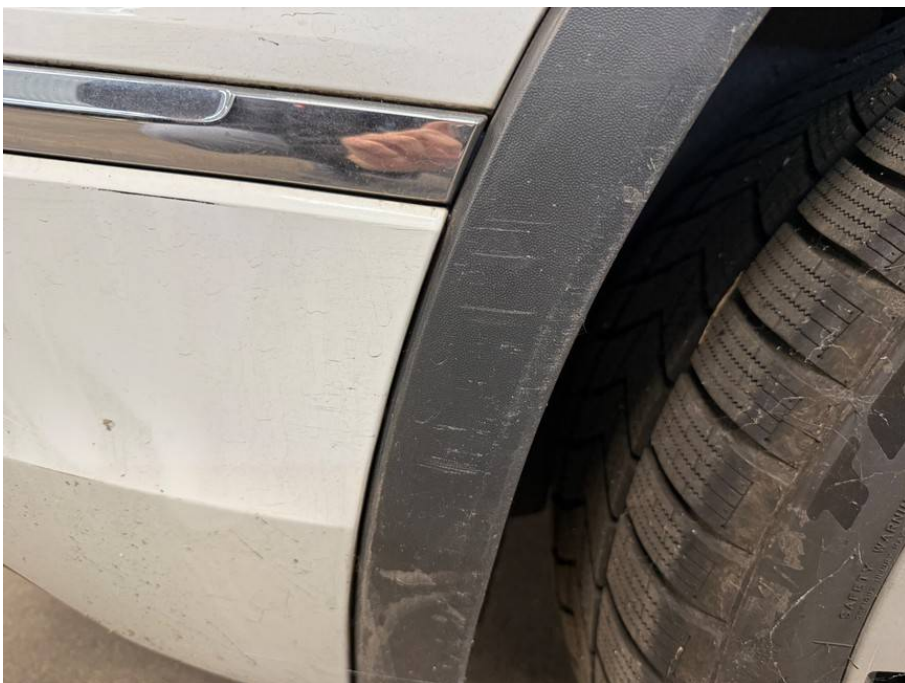
Radlaufverbreiterung h.r. verkratzt
