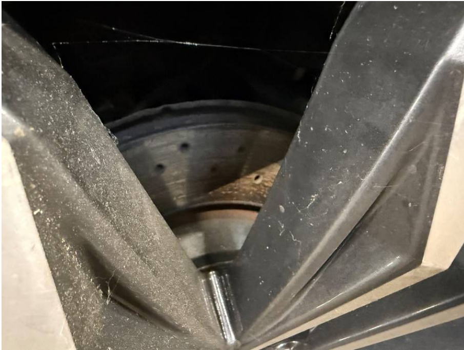
Leichte Korrosion Bremsscheiben
