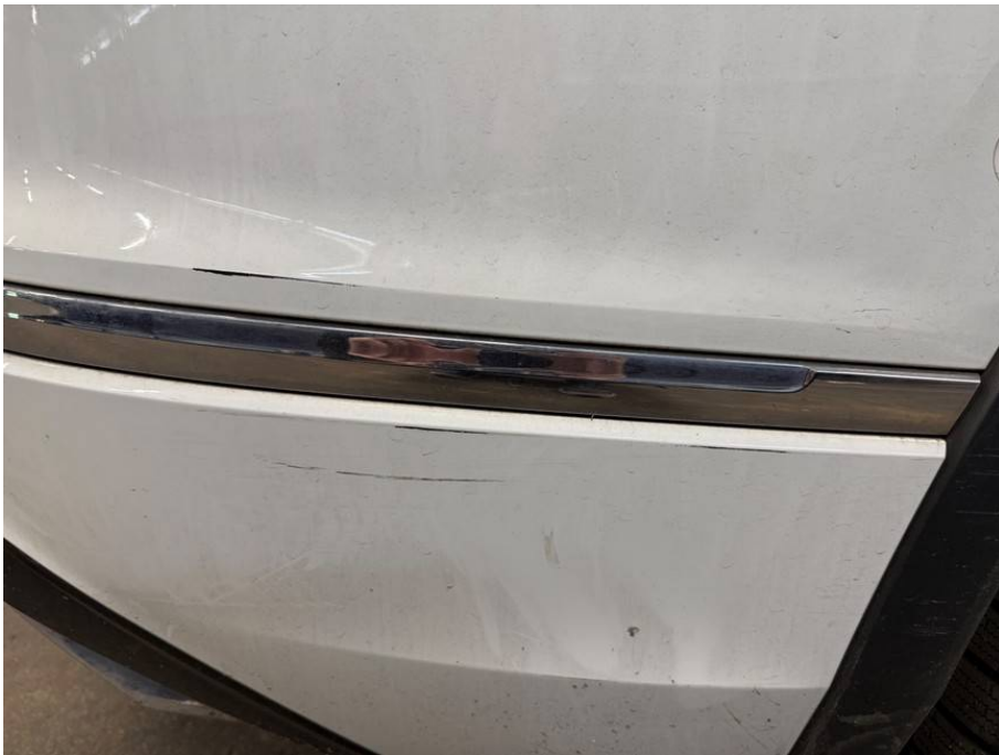
Heckverkleidung rechtsseitig verkratzt
