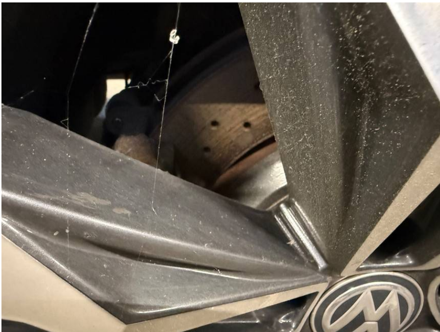
Leichte Korrosion Bremsscheiben
