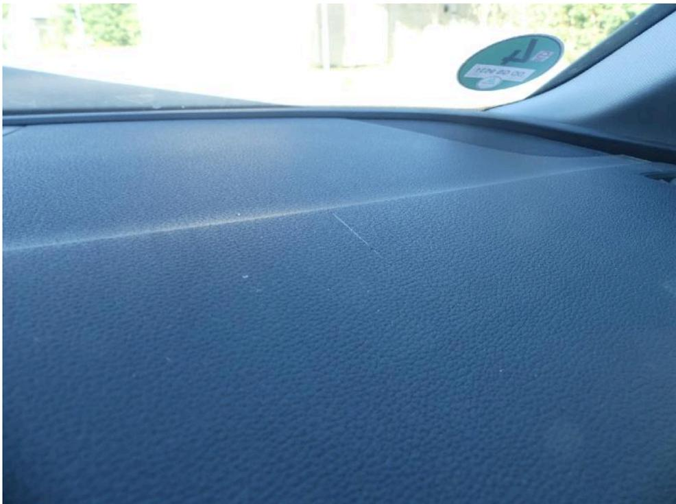
Bild: 16 Schalttafel partiell in der Oberfläche markiert.
