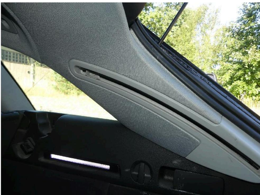
Bild: 32 D-Säulenverkleidung beschädigt.
