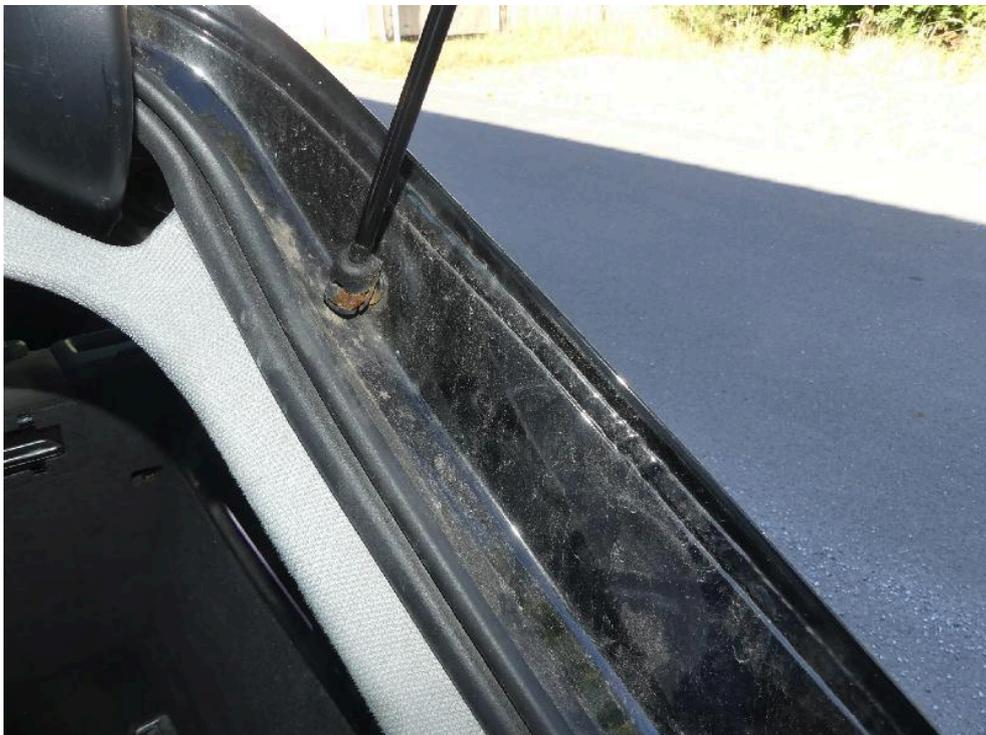
Bild: 64 Explizite Detailansicht, die Seitenwand rechts wurde ersetzt.
