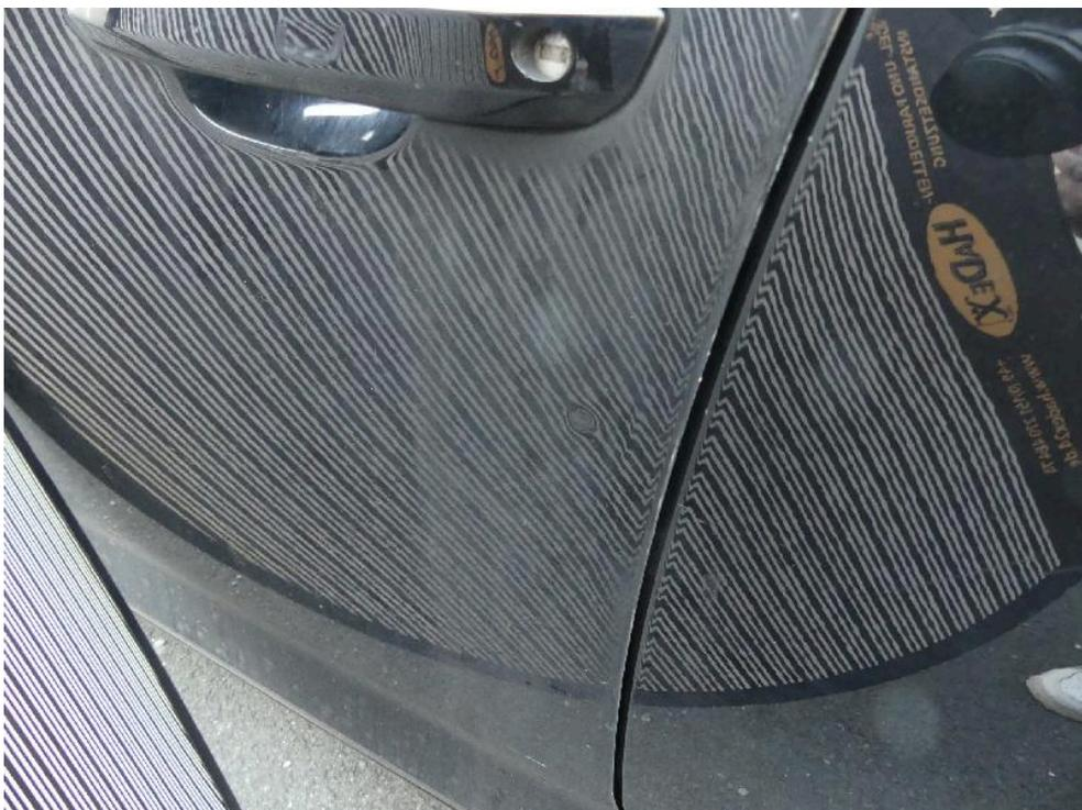
Bild: 58 Ansicht Fahrtür, diese ist im Bereich des Türfalzes verworfen, weiterhin ist eine punktuelle Eindellung vorhanden.
