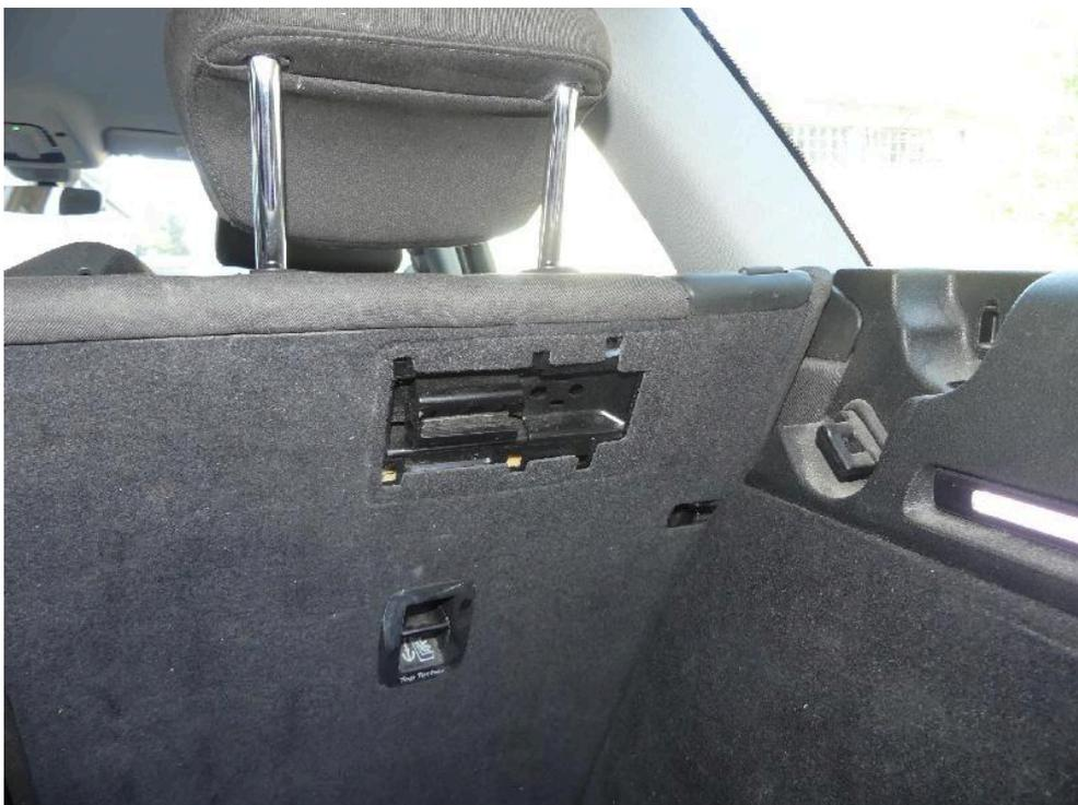
Bild: 30 Abdeckung Rückenlehne rechts hinten fehlt ...
