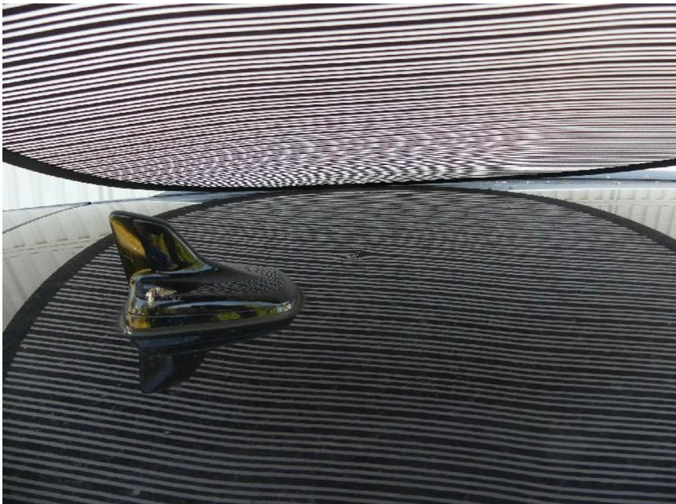
Bild: 60 Fahrzeugdach ist mehrfach punktuell gestaucht.
