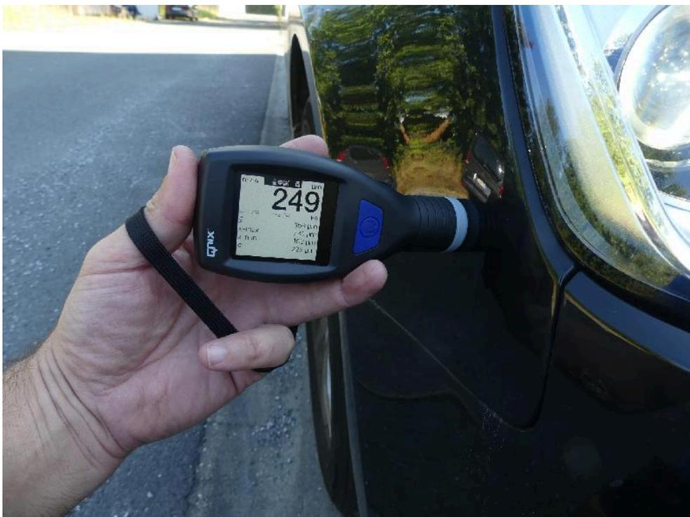
Bild: 50 Ausweisung Lackschichtdickenmessung vorgenommen, Messwerte dem beiliegenden Protokoll entnehmen.
