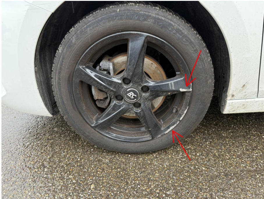
LM-Felge vorn links beschädigt
