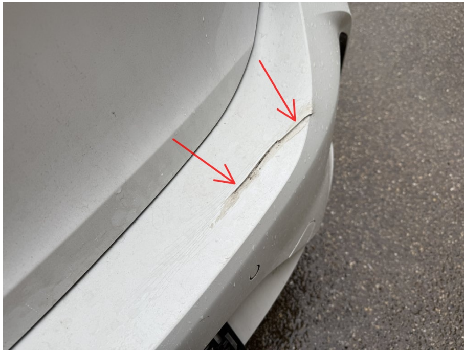
Stoßfänger hinten gebrochen
