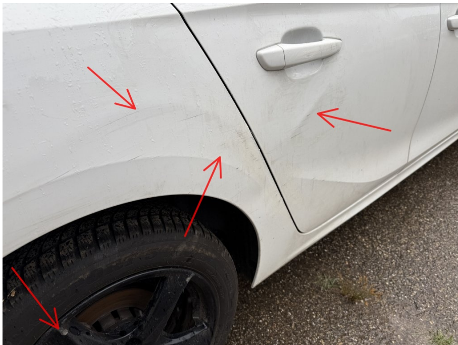
Tür hinten rechts und Seitenteil rechts verformt
