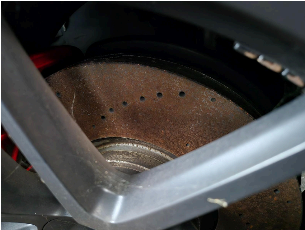
Bild: 13 Bremsscheiben, hier VR, großflächig angerostet, tw. stark
