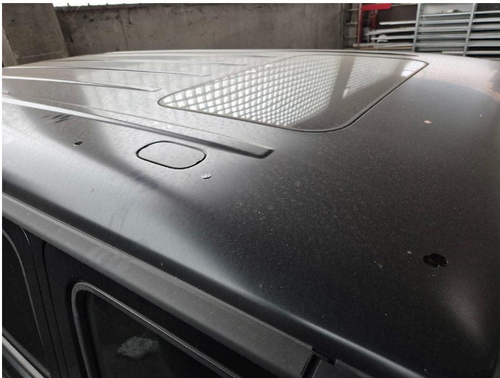
Bild: 26 Dach rechtsseitig mit div. Ölflecken
