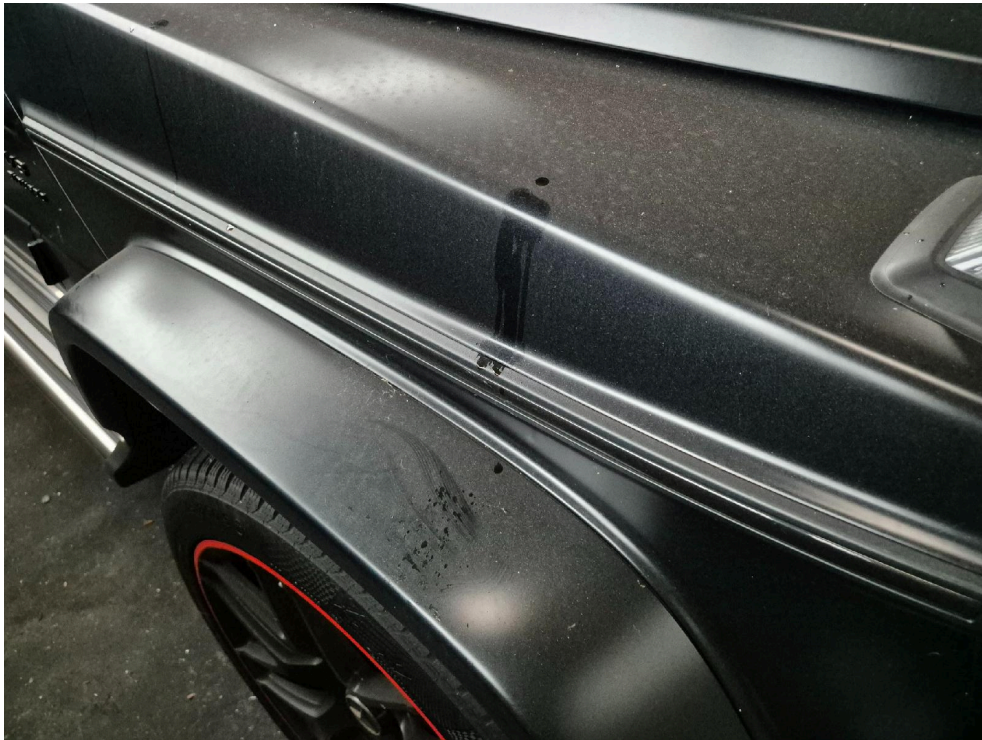
Bild: 21 Kotflügel + Verbreiterung VR mit Ölflecken
