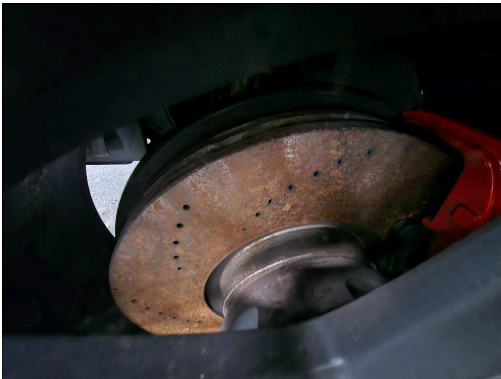
Bild: 12 Bremsscheiben, hier VL, großflächig angerostet, tw. stark
