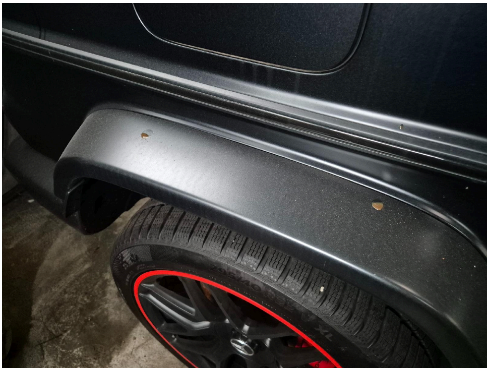
Bild: 22 Verbreiterung HR mit Ölflecken
