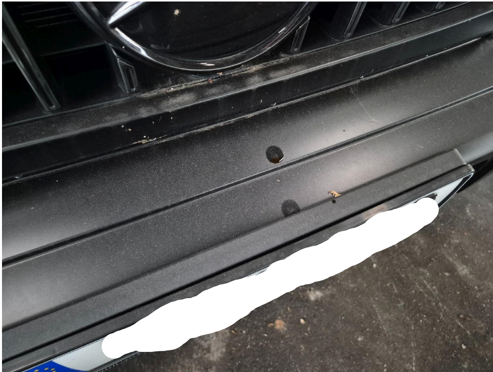
Bild: 19 Frontstoßfänger mit Ölflecken
