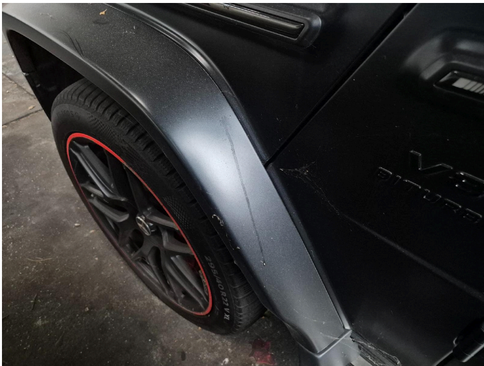
Bild: 16 Kotflügel + Verbreiterung mit Ölflecken
