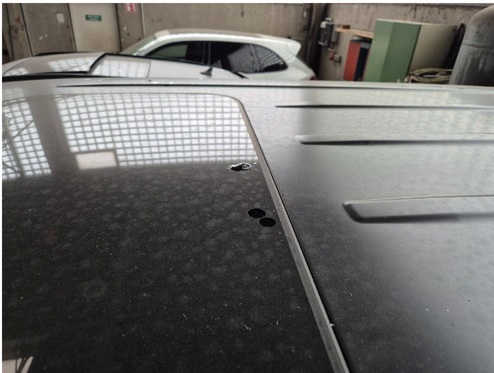
Bild: 18 Dach / Glasschiebe-/hubdach mit Ölflecken
