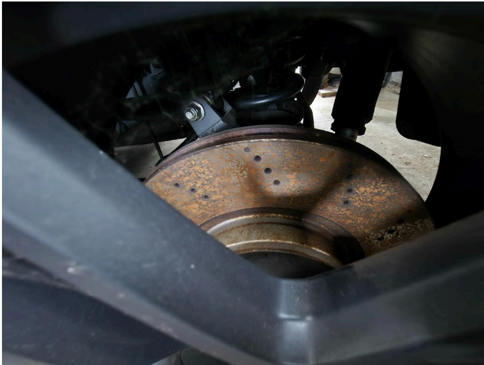
Bild: 11 Bremsscheiben, hier HL, großflächig angerostet, tw. stark
