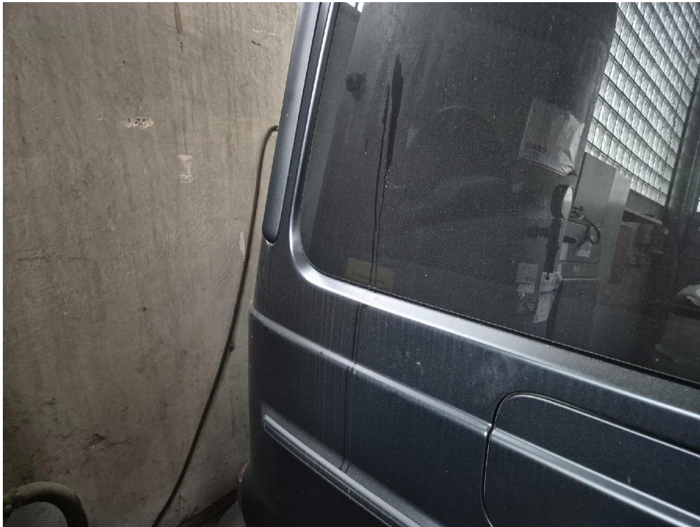
Bild: 23 Seitenteil + Seitenscheibe HR mit Ölflecken
