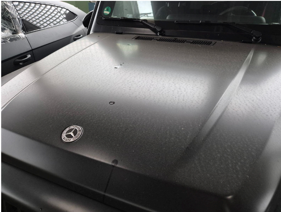
Bild: 15 Motorhaube mit diversen Ölflecken
