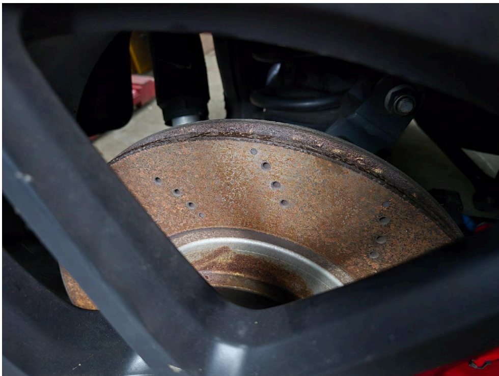
Bild: 14 Bremsscheiben, hier HR, großflächig angerostet, tw. stark
