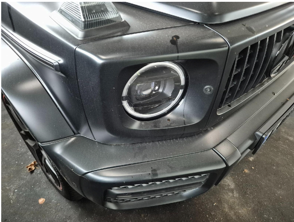
Bild: 20 Aufbauecke VR mit Ölflecken
