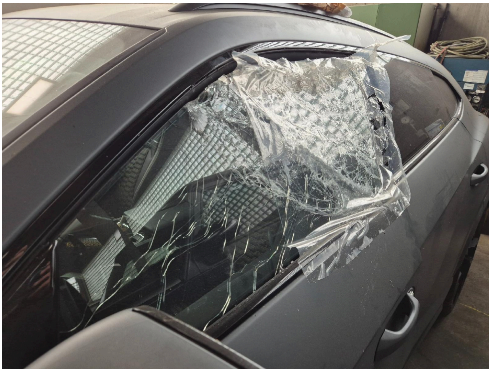
Bild: 17 Schaden: Fahrertürscheibe zerstört + prov. abgeklebt
