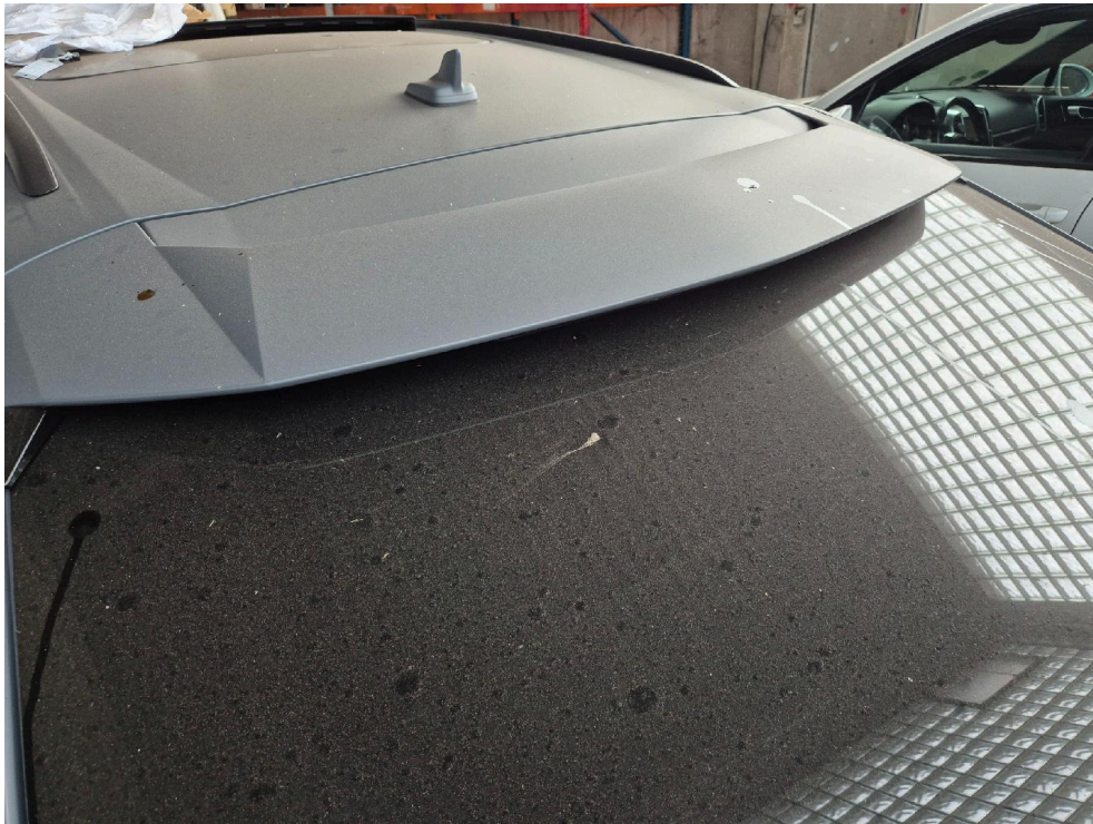
Bild: 22 Ölflecken im Heckbereich / Heckspoiler + Scheibe
