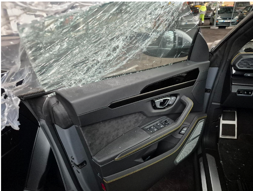
Bild: 13 Fahrertürscheibe zerstört (prov. abgeklebt) + Glassplitter an der Türinnenverkleidung u. Innenraumbereich
