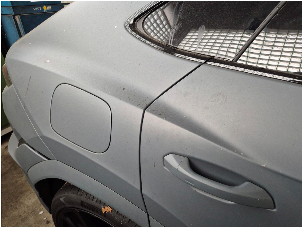
Bild: 24 Ölflecken HR (Seitenteil + Fondtür)
