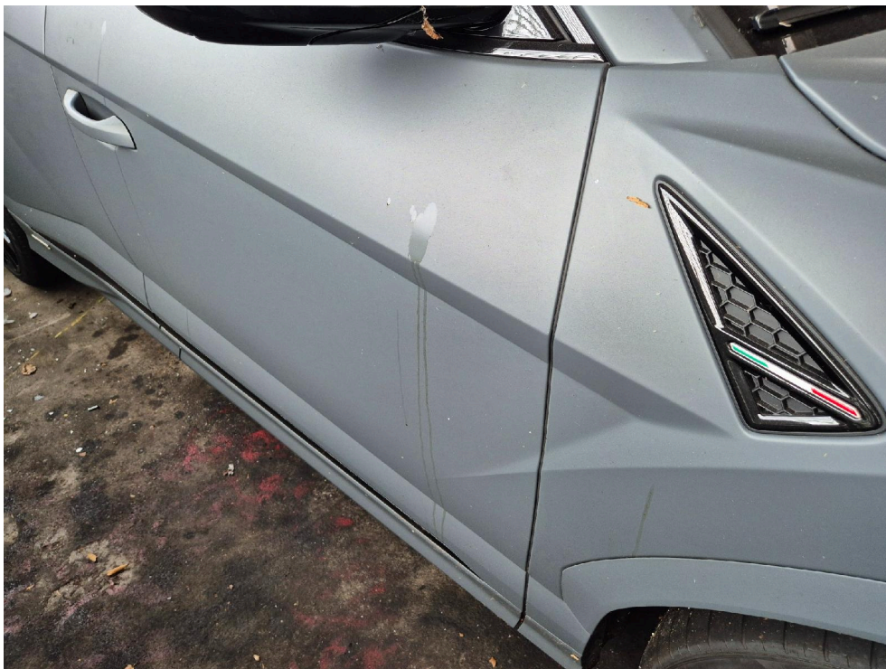
Bild: 25 Ölflecken Beifahrertür- und Kotflügelbereich VR
