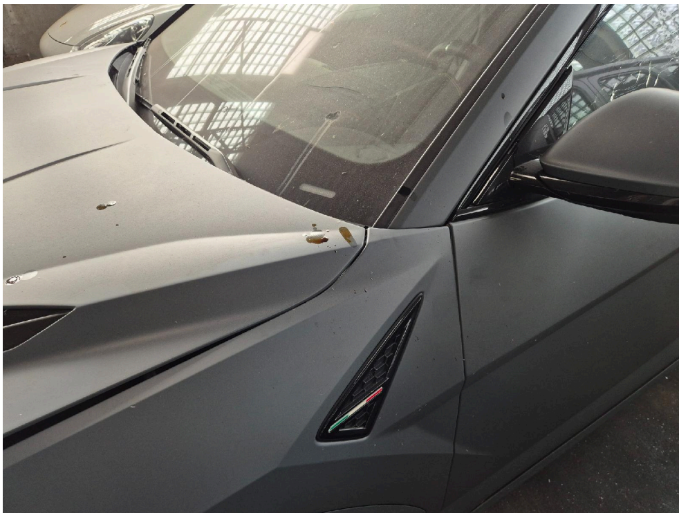
Bild: 19 Ölflecken im Bereich Motorhaube + Kotflügel VL + A-Säule
