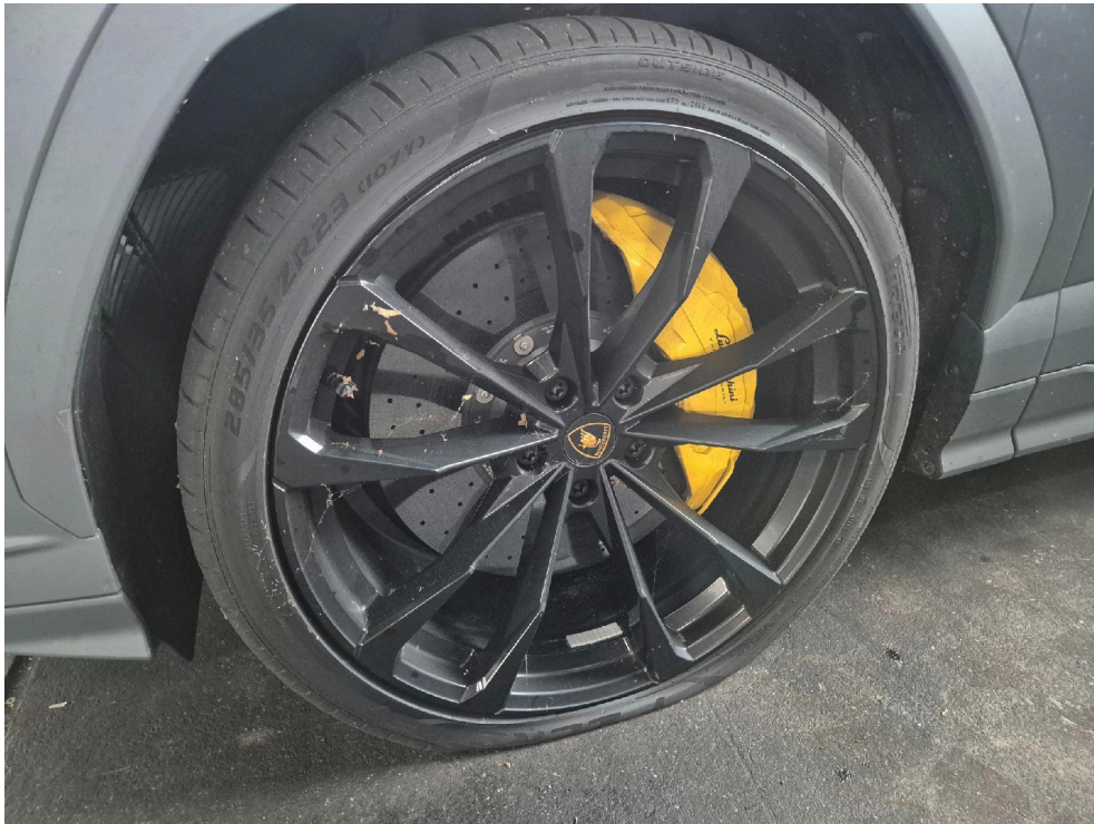
Bild: 18 Schaden: Rad / Reifen VL drucklos
