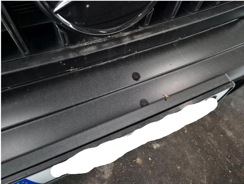
Bild: 19 Frontstoßfänger mit Ölflecken
