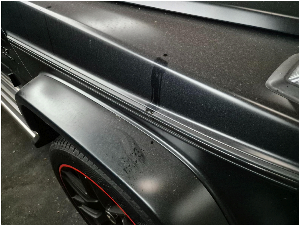
Bild: 21 Kotflügel + Verbreiterung VR mit Ölflecken
