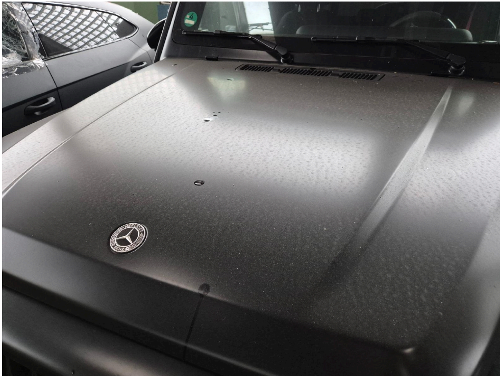
Bild: 15 Motorhaube mit diversen Ölflecken
