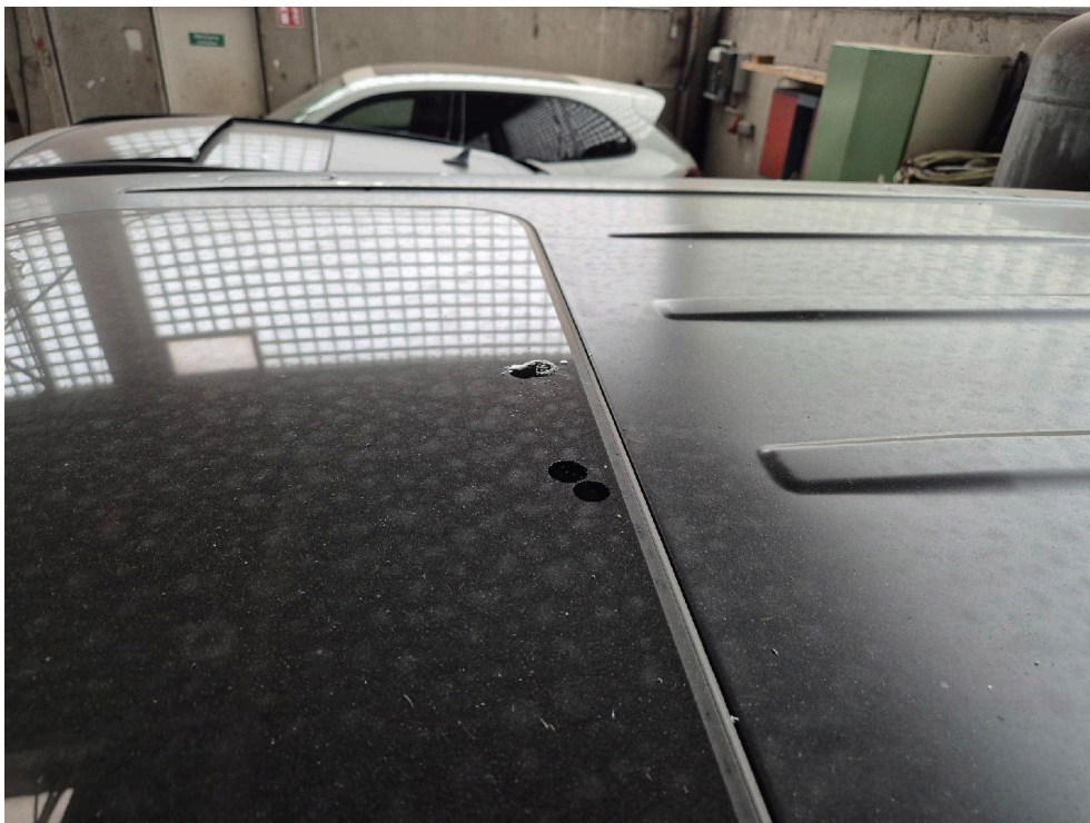
Bild: 18 Dach / Glasschiebe-/hubdach mit Ölflecken
