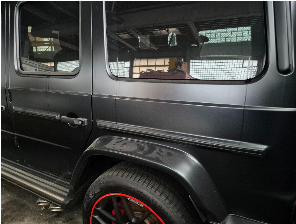
Bild: 17 Fondtür + Seitenteil links mit Ölflecken
