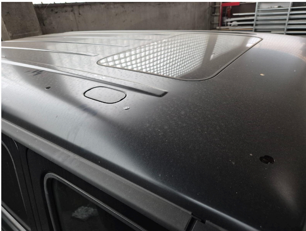
Bild: 26 Dach rechtsseitig mit div. Ölflecken
