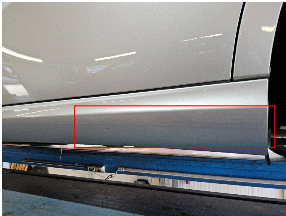
Bild 23 : Seitenschwellerverkleidung rechts verkratzt
