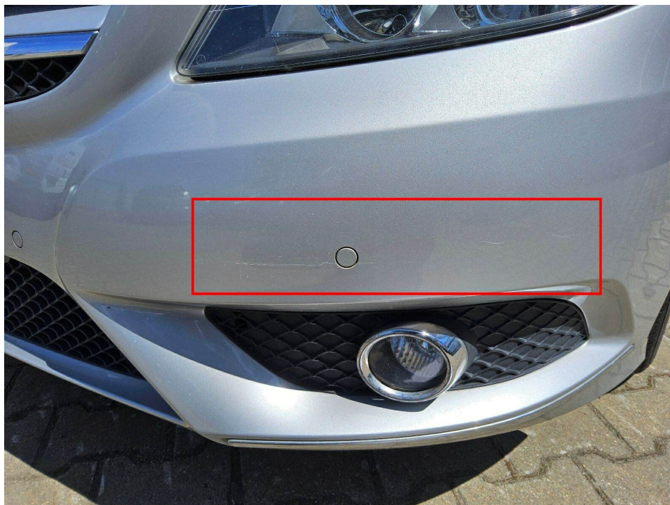
Bild 8 : Stoßfänger vorn verkratzt
