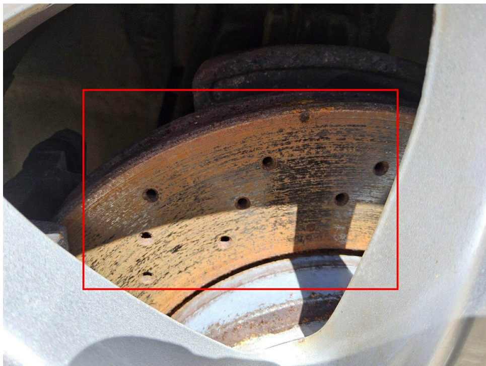
Bild 28 : 1. Achse Bremsscheiben korrodiert, mangelhaftes Tragbild
