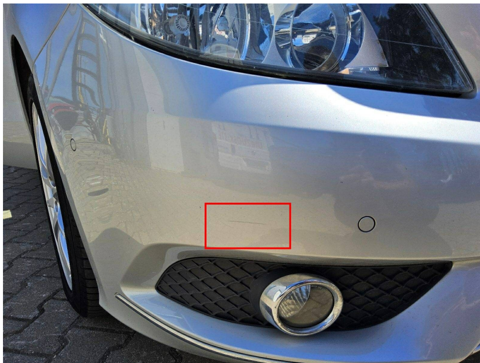
Bild 9 : Stoßfänger vorn verkratzt
