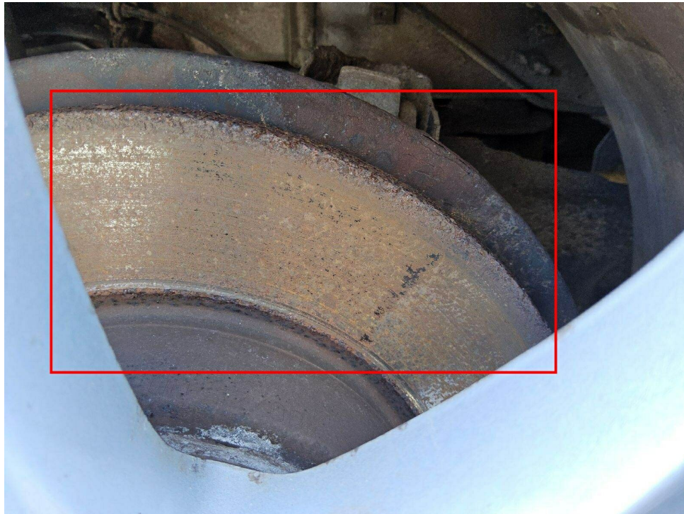
Bild 29 : 2. Achse Bremsscheiben korrodiert, mangelhaftes Tragbild
