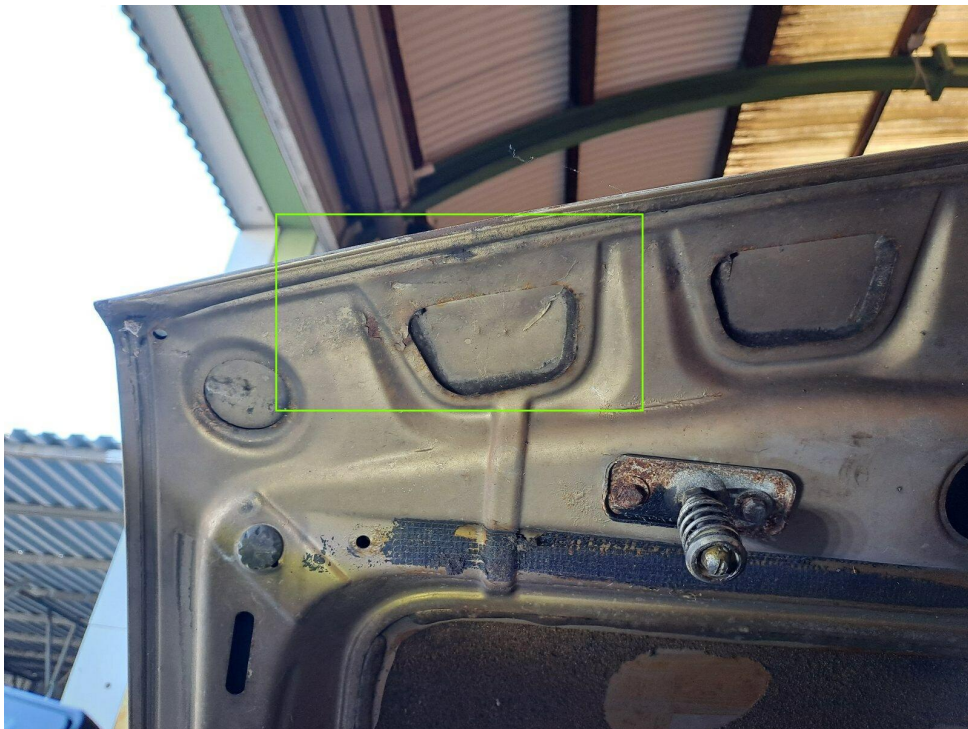
Bild 8 : Motorhaube im Inneren Korrosion
