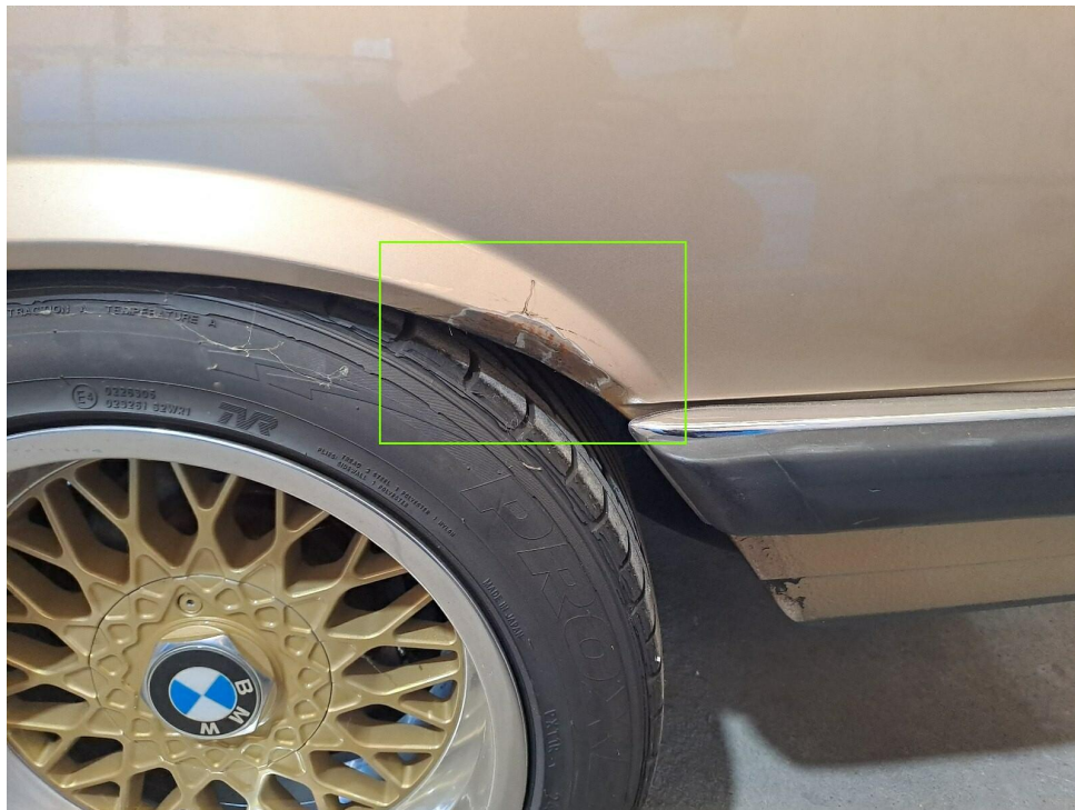
Bild 19 : Seitenwand hinten links Korrosion Reifen hinten schleifen
