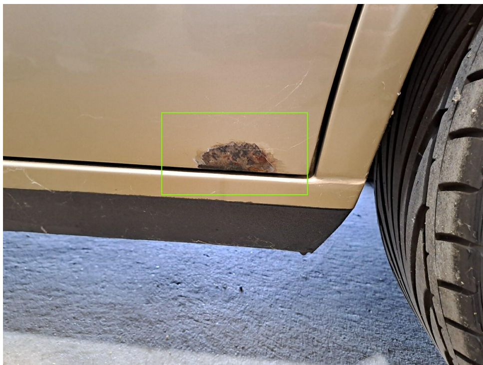
Bild 20 : Tür hinten links Korrosion
