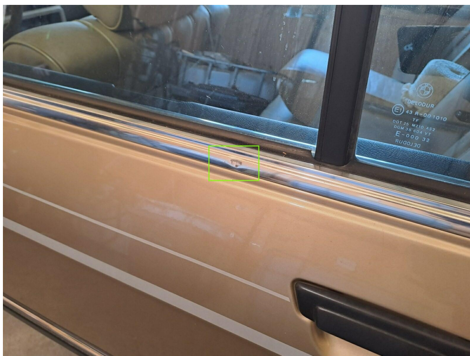
Bild 22 : Schachtzierleiste hinten links eingedellt
