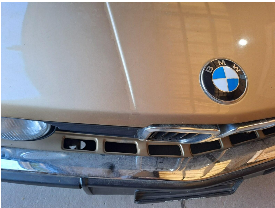
Bild 14 : Motorhaube teillackiert Instandsetzungsspuren
