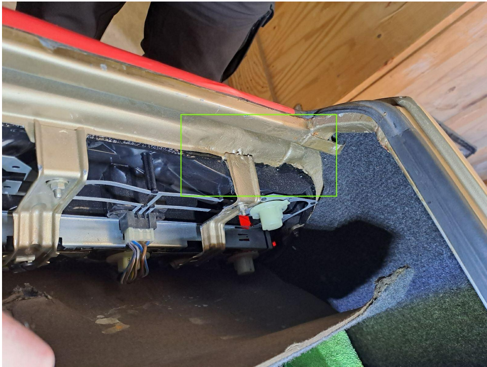
Bild 13 : Korrosion im Fahrzeugheckbereich (Rückleuchtaufnahmen) und Instandsetzungsspuren
