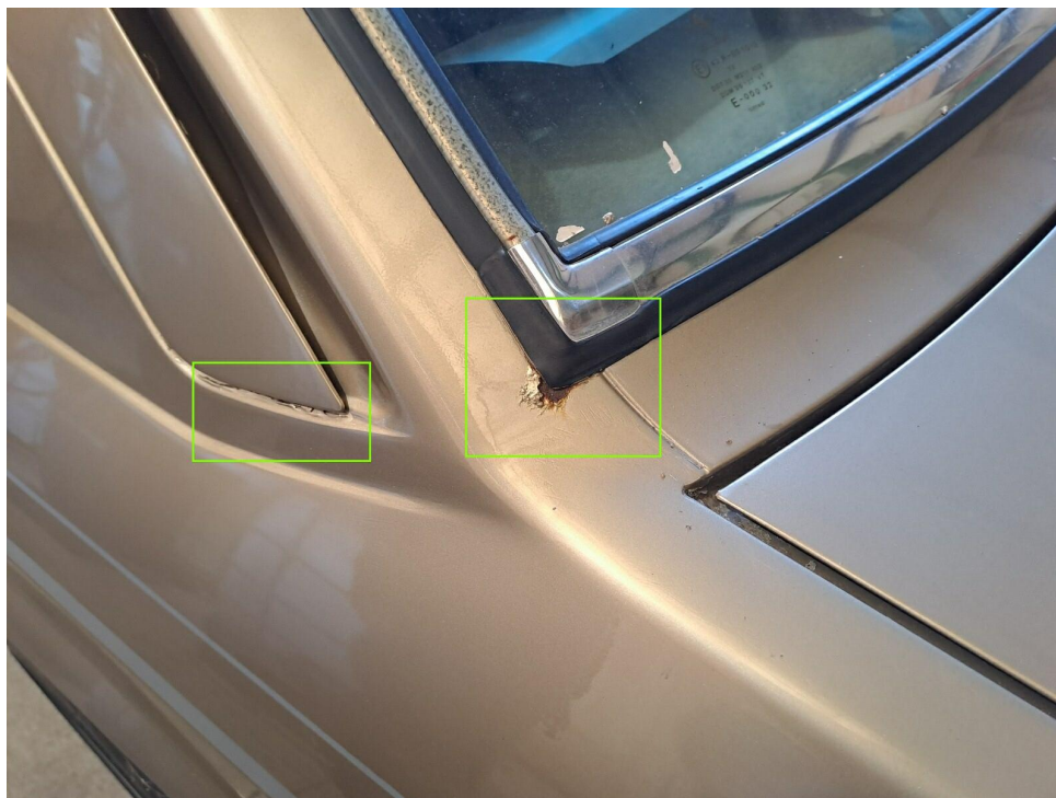
Bild 21 : Scheibenrahmen Heckscheibe unterhalb Korrosion und setlich Lackablösungen
