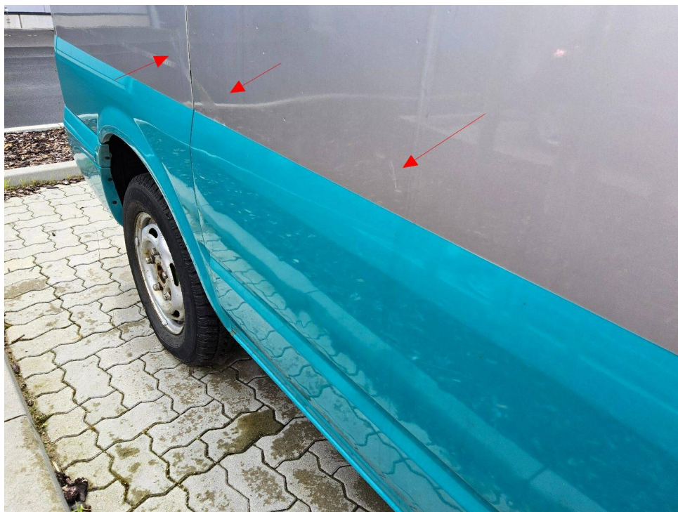
Bild 9 : rechte Seite eingedellt und verschrammt
