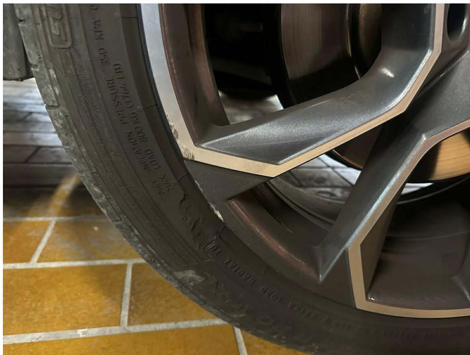
Bild 11 : LM Felge vorne rechts mit Materialabtragung > 1 mm (Hochglanzgedreht)
