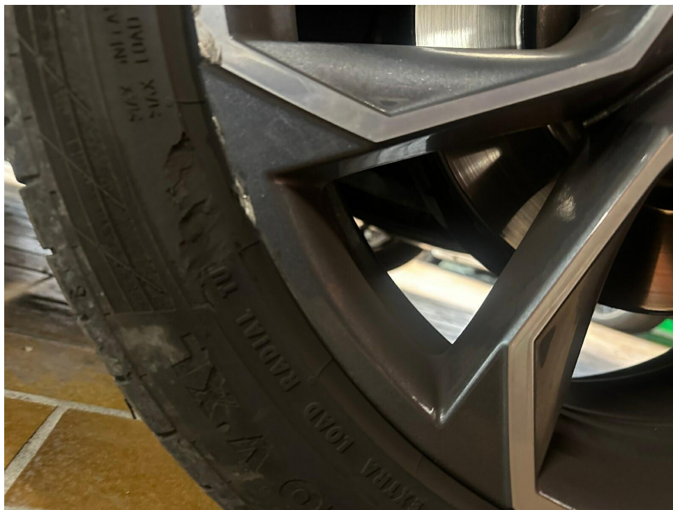
Bild 12 : Reifen vorne rechts eingeschnitten (Allrad)
