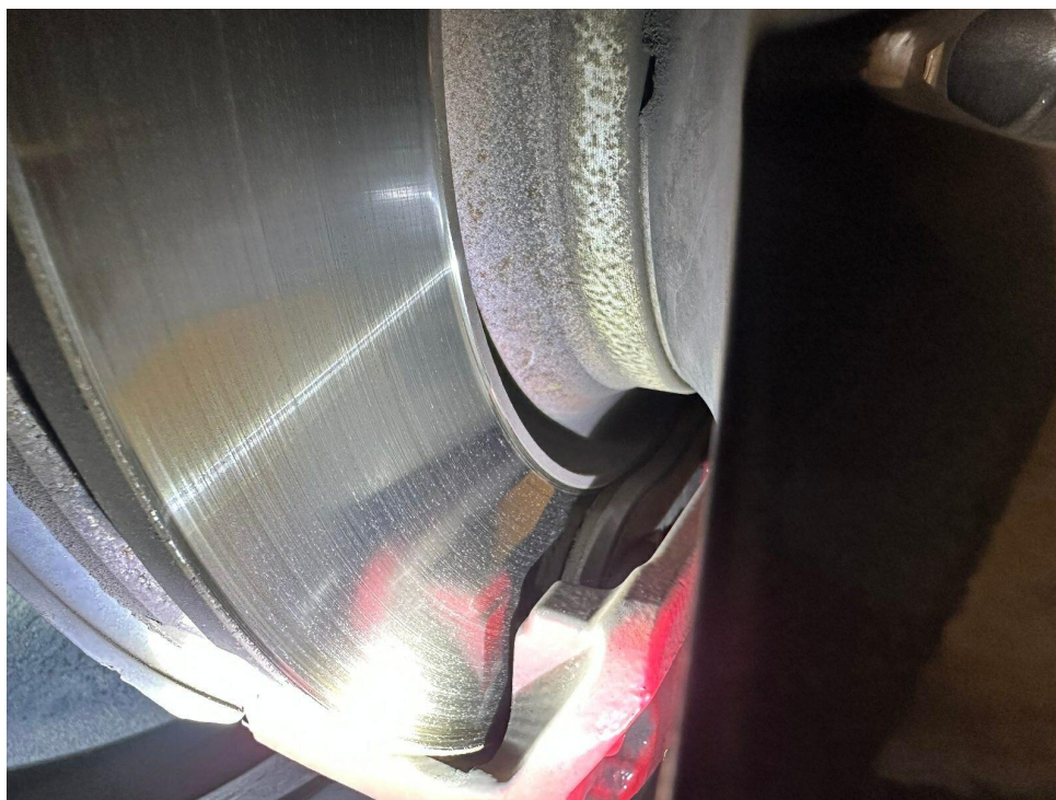
Bild 10 : Bremse vorne nahe Verschleißgrenze
