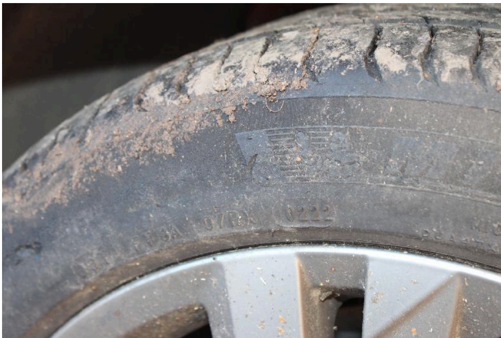
Bild: 11 ... porös und geschädigt.
