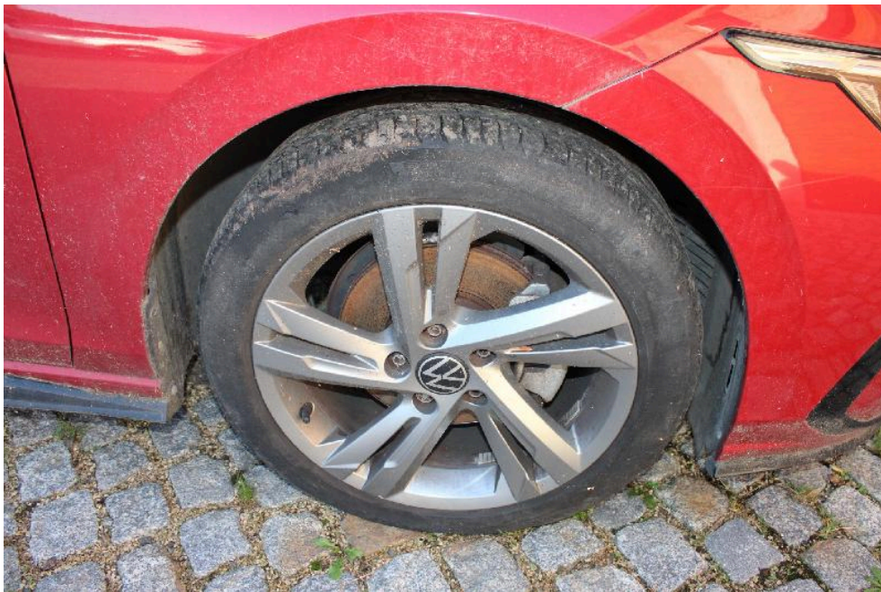
Bild: 10 Alle Reifen sind teilweise luftleer und witterungsbedingt ...
