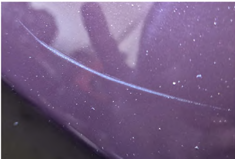
Bild 3, Beschädigung am hinteren Stoßfänger im Detail
