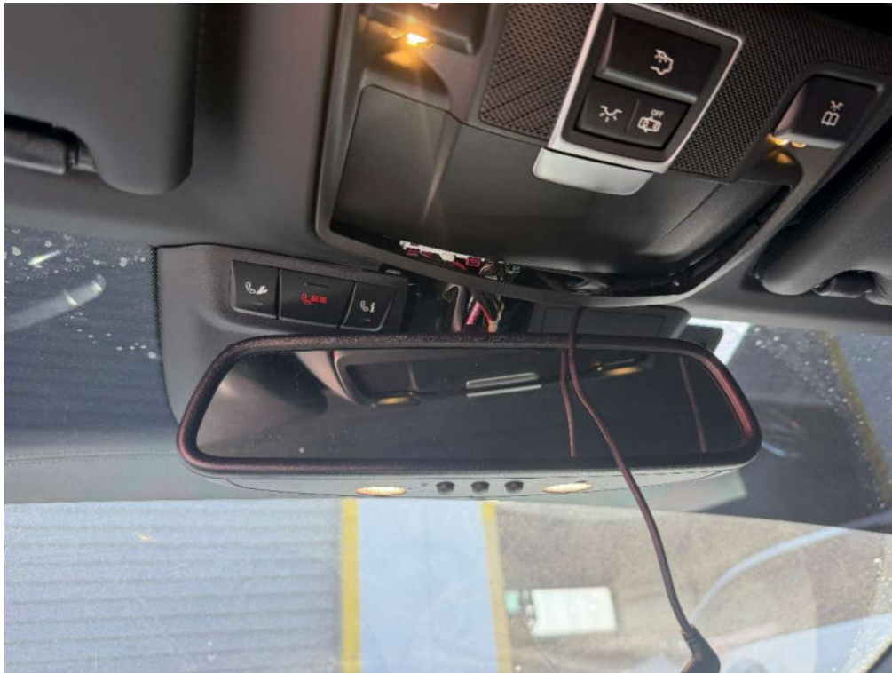
Bild 133 Bedieneinheit der Innenraumbeleuchtung beschädigt
