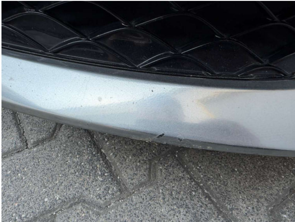
Bild 93 Detailaufnahme Chromzierleiste beschädigt
