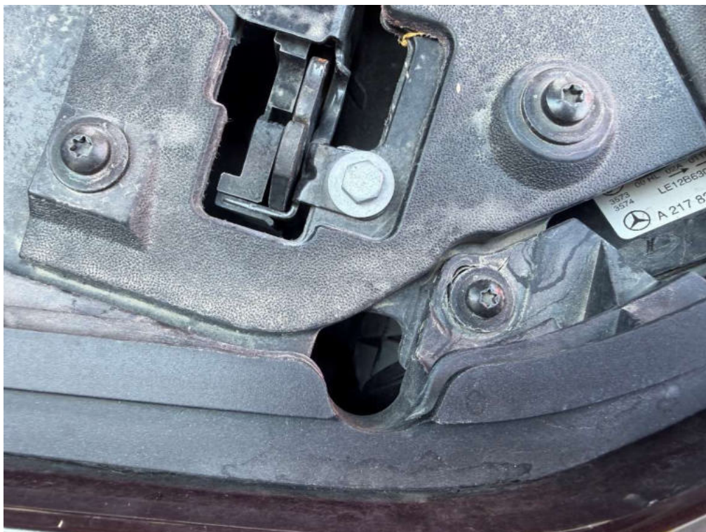
Bild 114 Detailaufnahme Motorraum Sand und Staubablagerungen
