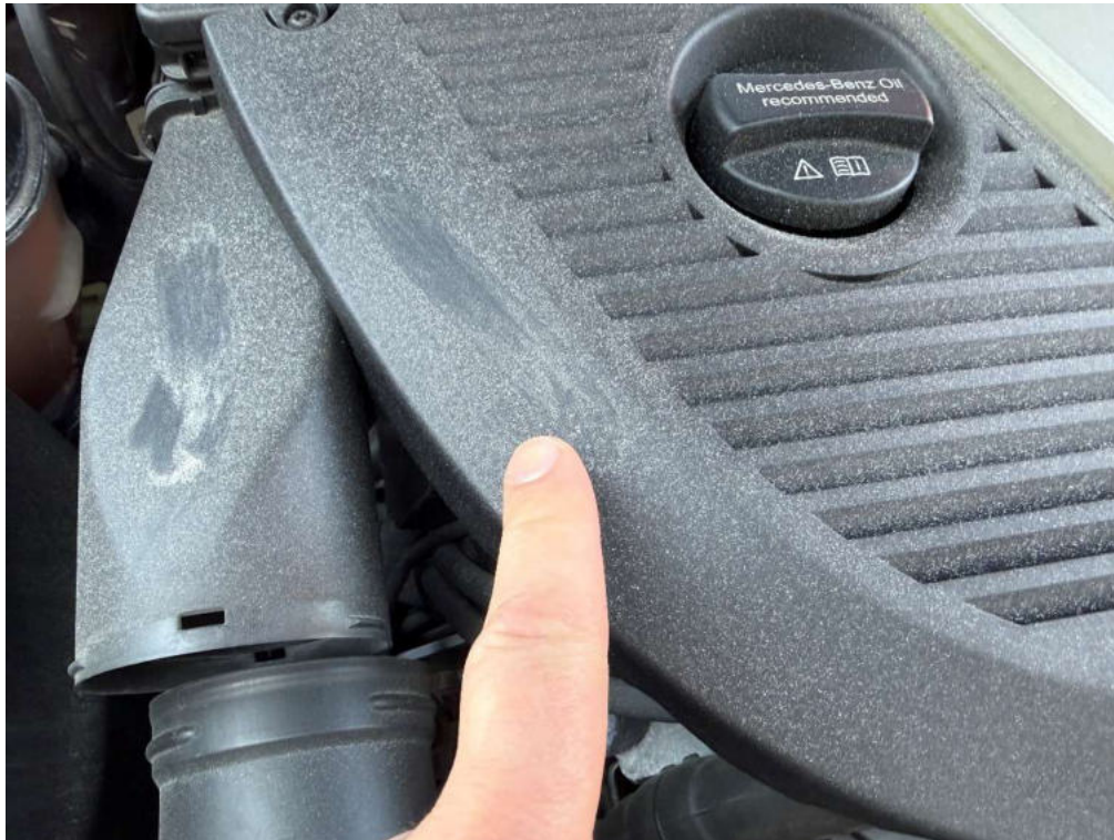
Bild 115 Detailaufnahme Motorraum Sand und Staubablagerungen
