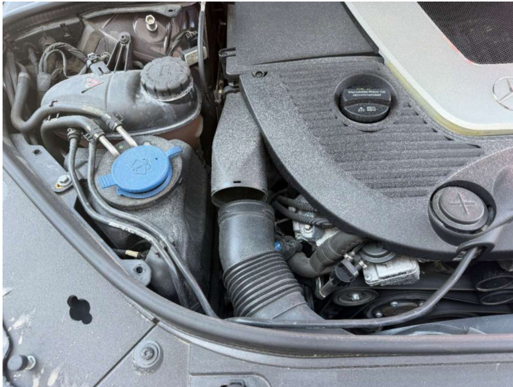
Bild 109 Detailaufnahme Motorraum Sand und Staubablagerungen
