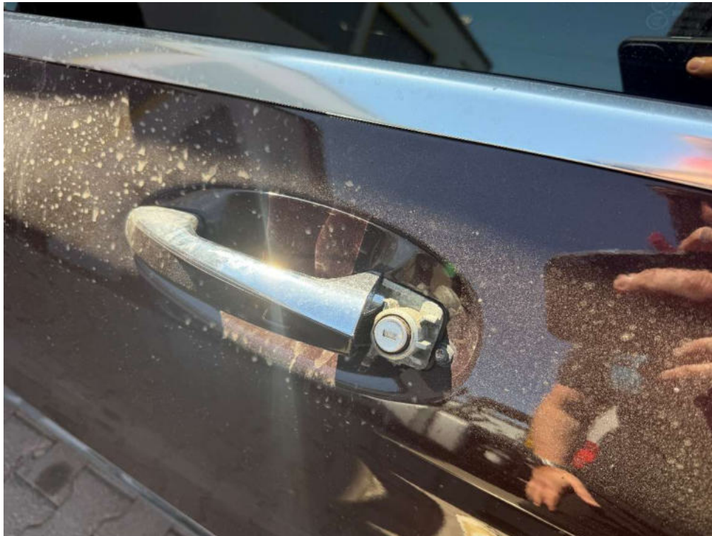
Bild 125 Detailaufnahme Abdeckung Türgriff demontiert
