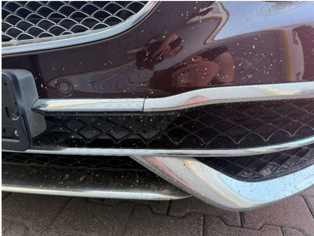
Bild 89 Detailaufnahme Chromzierleiste vorne beschädigt
