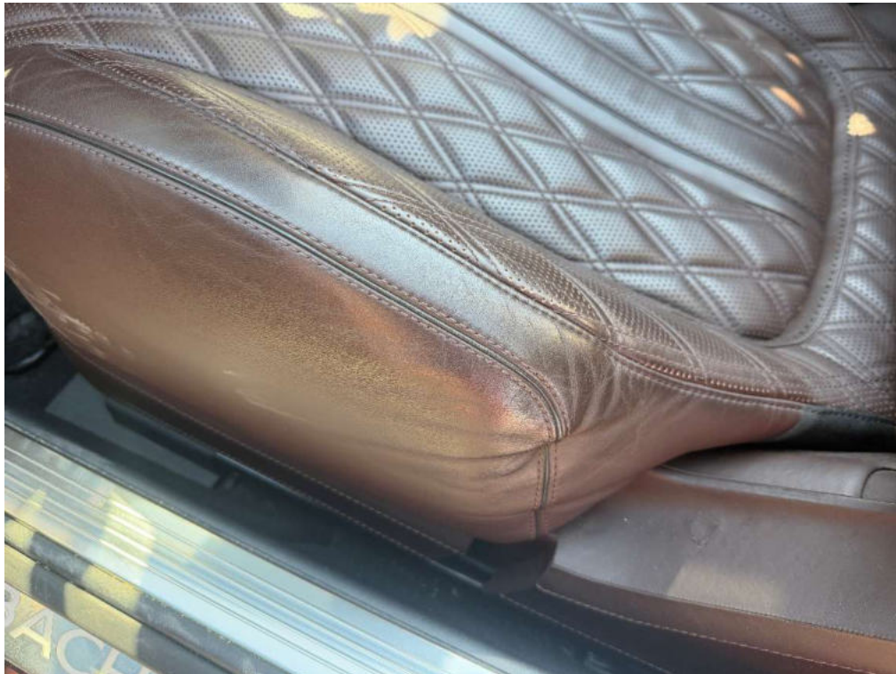
Bild 127 Fahrersitz Beschädigung im Leder
