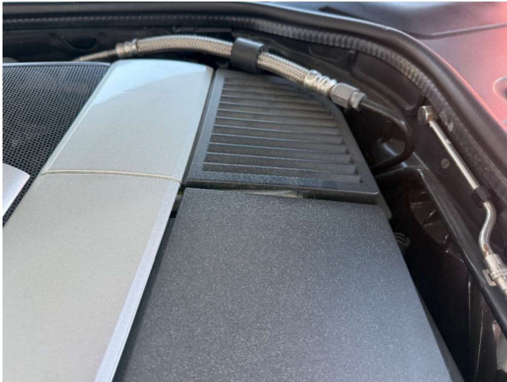
Bild 111 Detailaufnahme Motorraum Sand und Staubablagerungen
