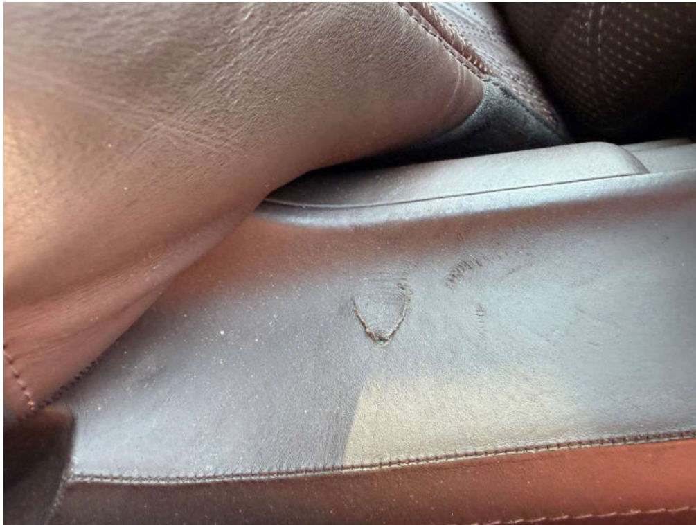
Bild 129 Fahrersitz Beschädigung im Leder
