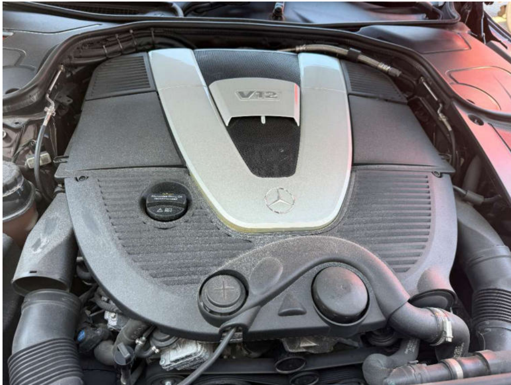
Bild 121 Detailaufnahme Motorraum Sand und Staubablagerungen
