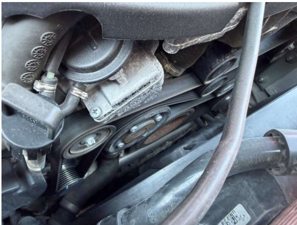
Bild 118 Detailaufnahme Ablagerungen an Nebenaggregaten
