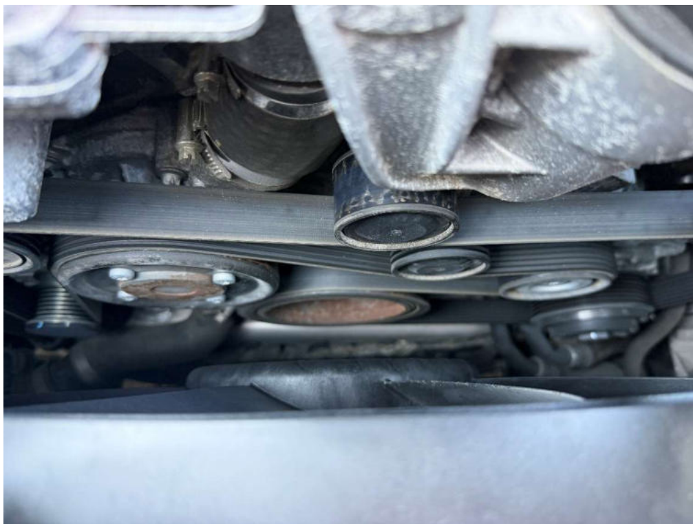
Bild 120 Detailaufnahme Ablagerungen an Nebenaggregaten
