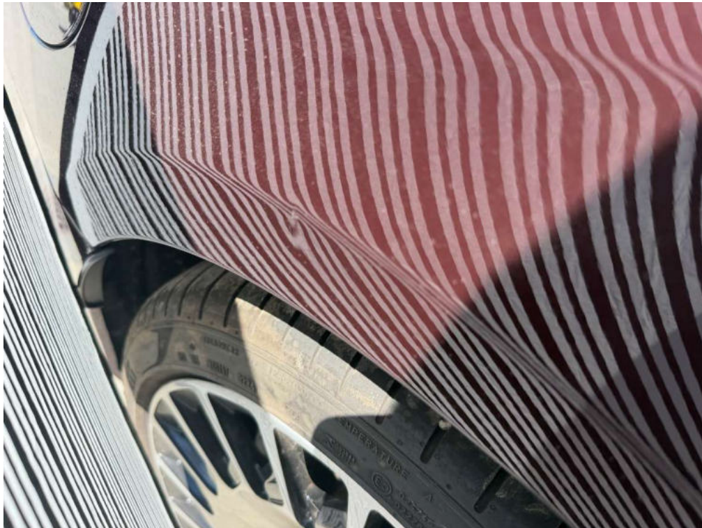
Bild 103 Detailaufnahme Seitenwand hinten rechts eingedellt
