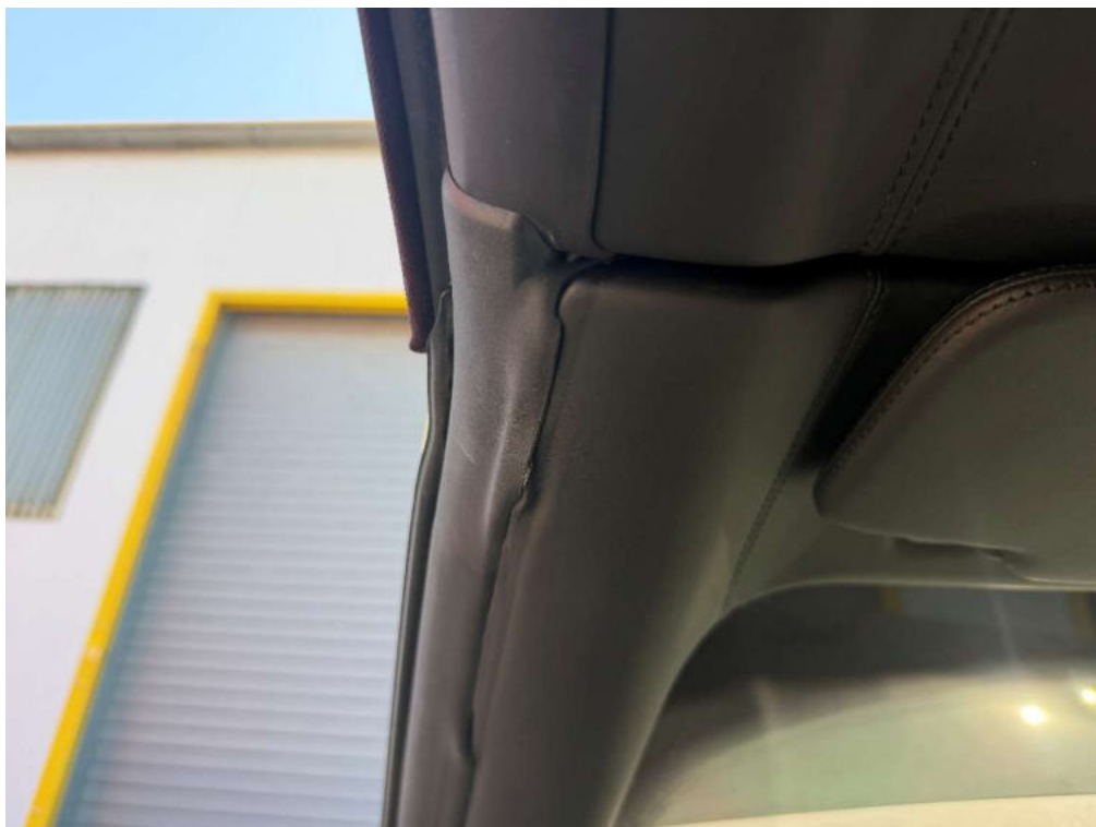
Bild 102 Detailaufnahme Verkleidung A-Säule und Dachhimmel beschädigt
