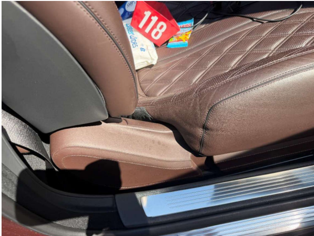
Bild 131 Beifahrersitz Leder abgenutzt
