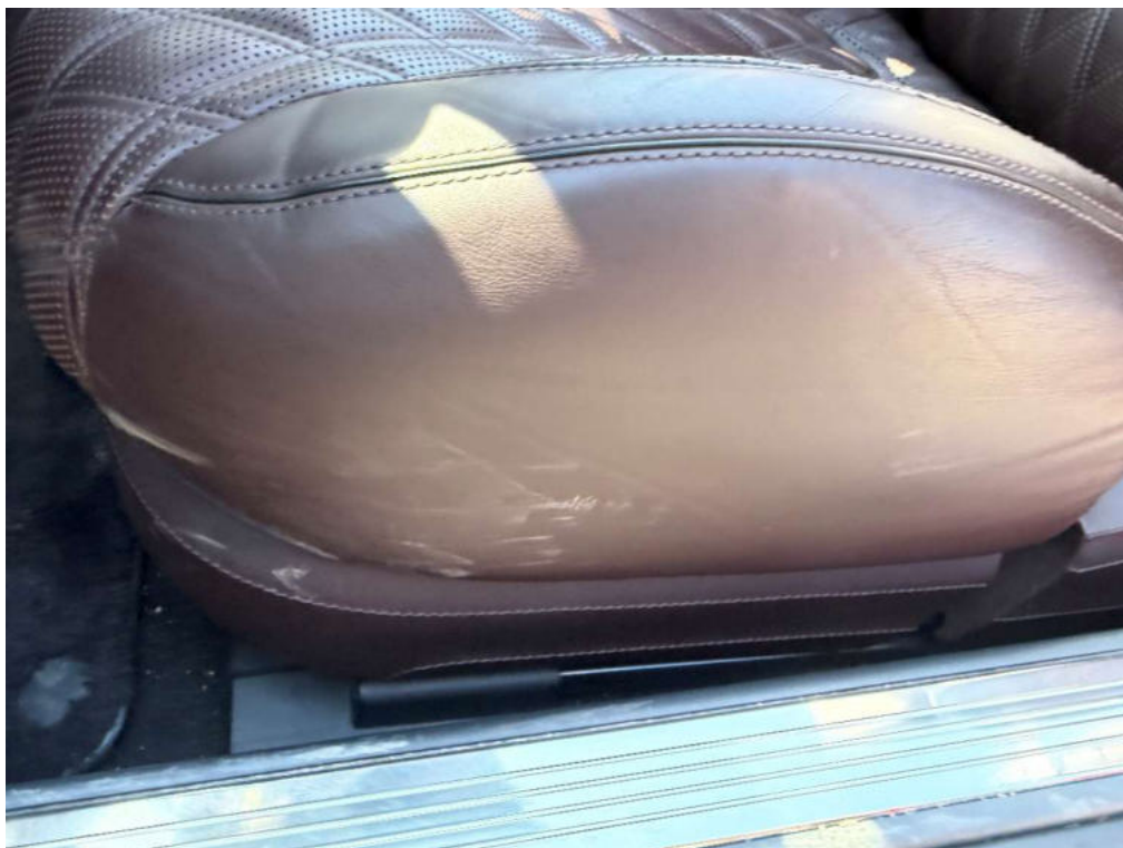
Bild 128 Fahrersitz Beschädigung im Leder
