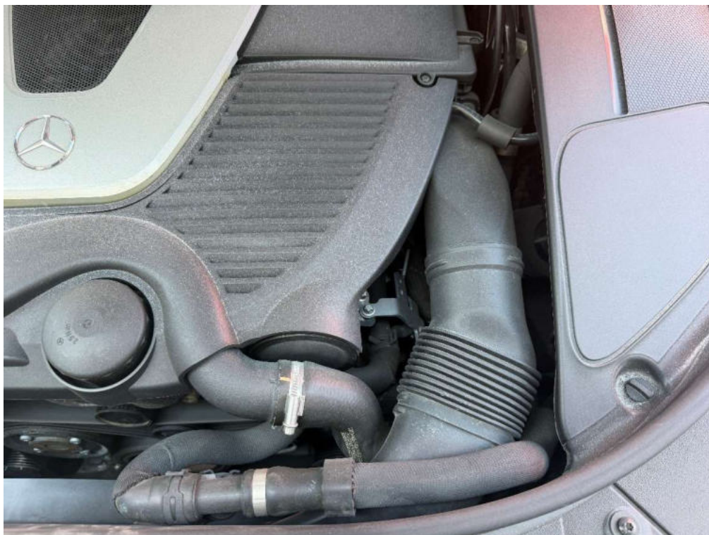
Bild 110 Detailaufnahme Motorraum Sand und Staubablagerungen
