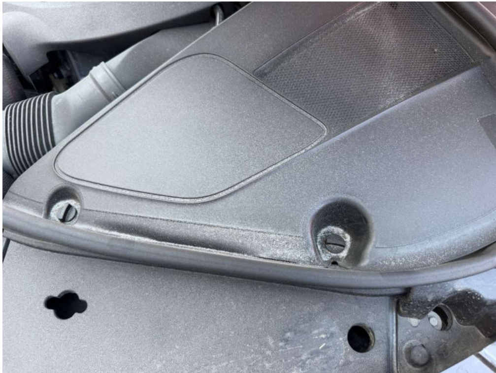
Bild 113 Detailaufnahme Motorraum Sand und Staubablagerungen
