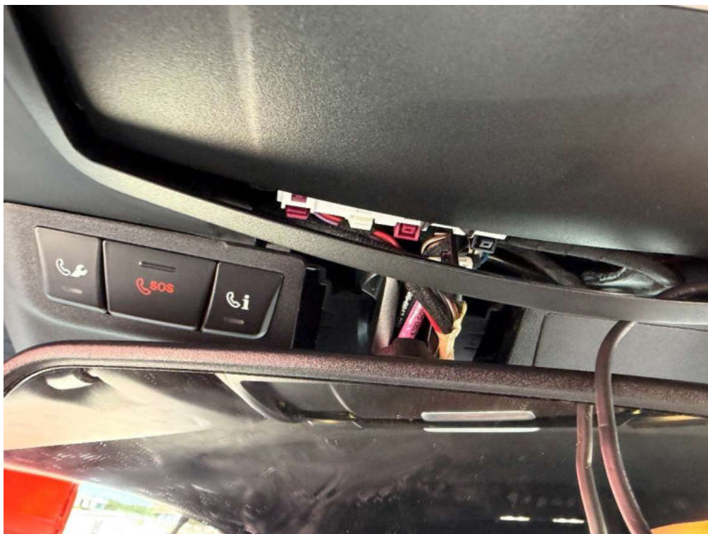
Bild 136 Bedieneinheit der Innenraumbeleuchtung beschädigt
