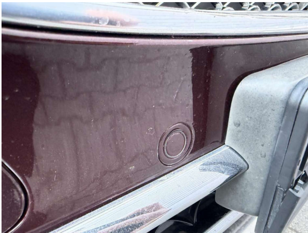
Bild 94 Detailaufnahme Folie beschädigt
