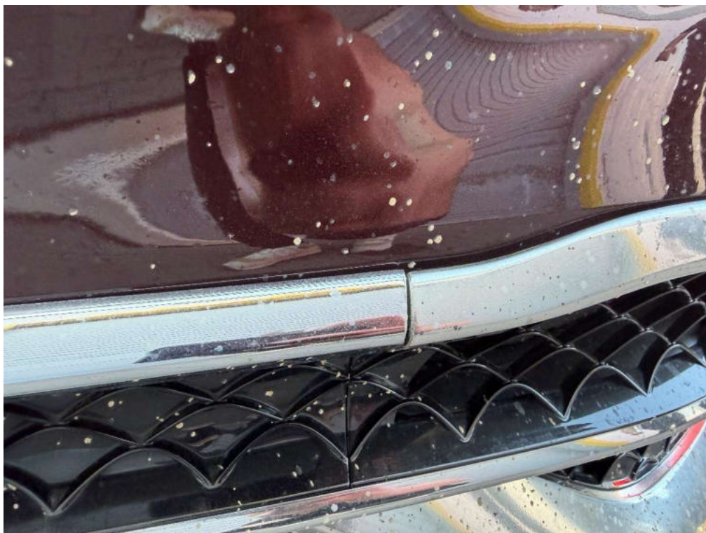
Bild 90 Detailaufnahme Chromzierleiste vorne beschädigt
