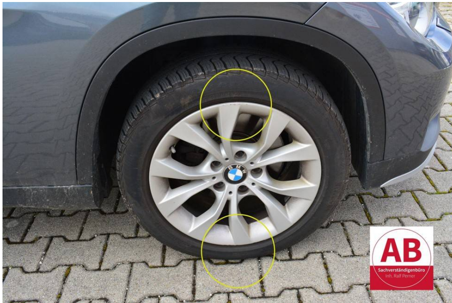
Leichtmetallfelge vorne rechts verschrammt.
