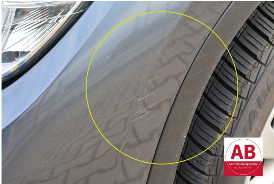
Stoßfänger und Radlaufblende vorne links sind verschrammt.
