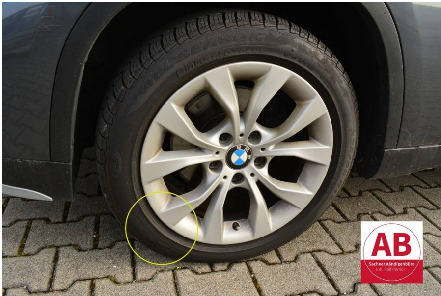
Leichtmetallfelge vorne links verschrammt.
