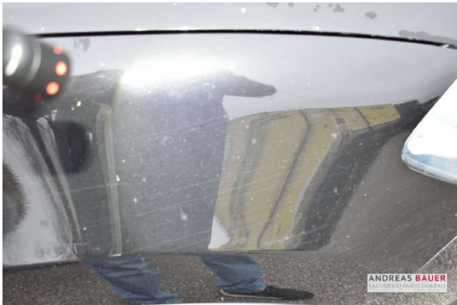
rechter Kotflügel verschrammt
