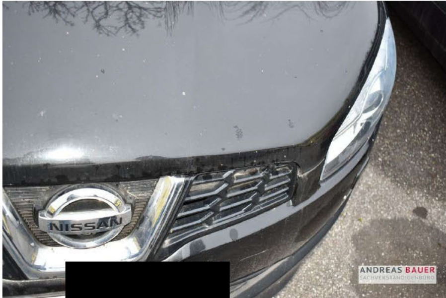
deutlicher Steinschlag an der Motorhaube
