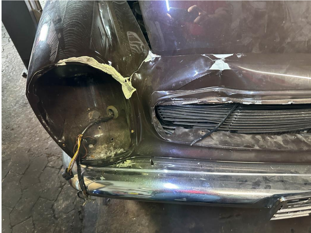
Das Frontblech und der Kotflügel vorne rechts sind stark gestaucht
