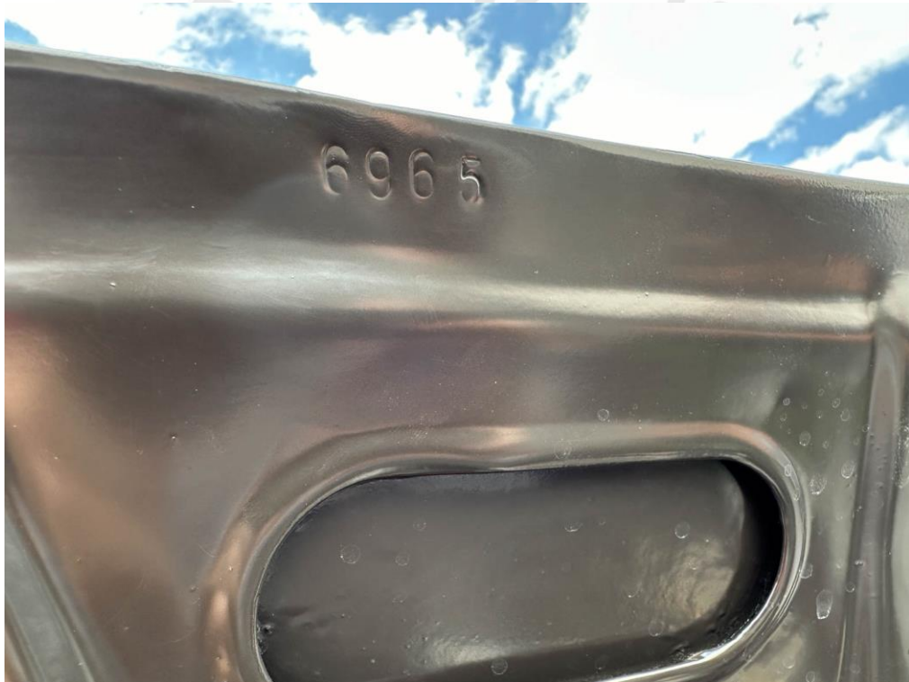
Motordeckel 6965 die Prägung entspricht dem Eintrag in der Datenkarte für die Aufbau- nummer
