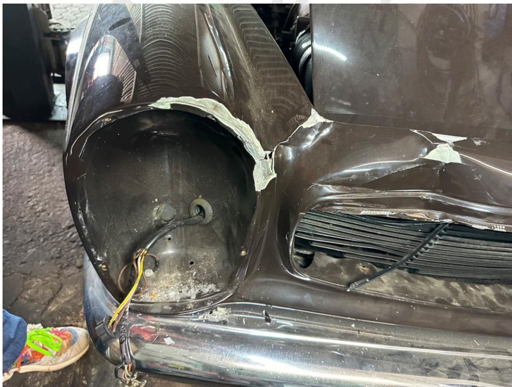
Die Scheinwerferaufnahme ist gestaucht
