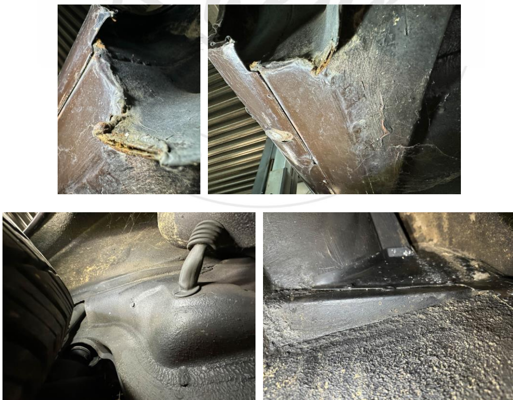
Rahmen / Bodengruppe Korrosionsansatz
