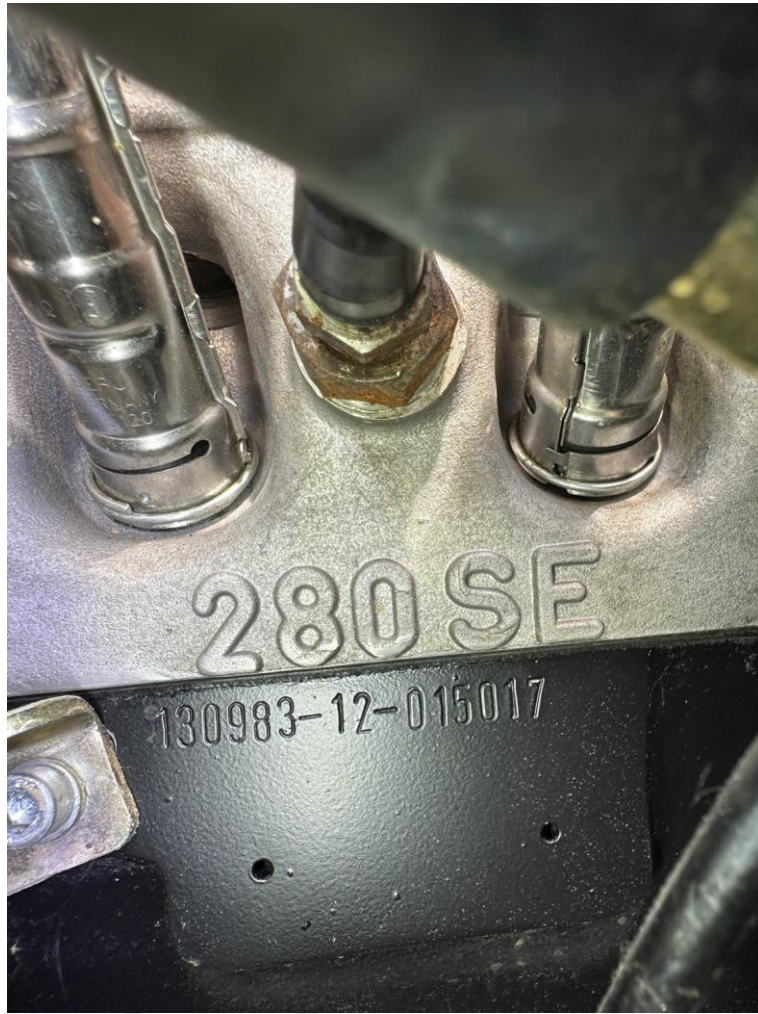
Prägekennzeichnung der Motornummer 130 983-12-015017 die Prägung entspricht dem Eintrag in der Datenkarte für die Motornummer
