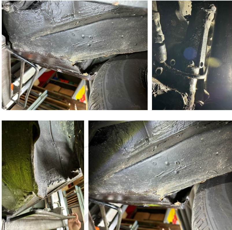
Rahmen / Bodengruppe Korrosionsansatz
