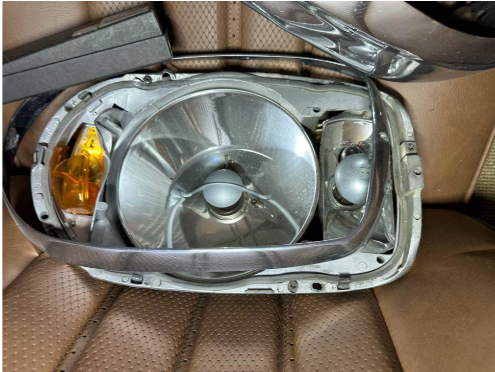
Der Scheinwerfer ist zerstört
