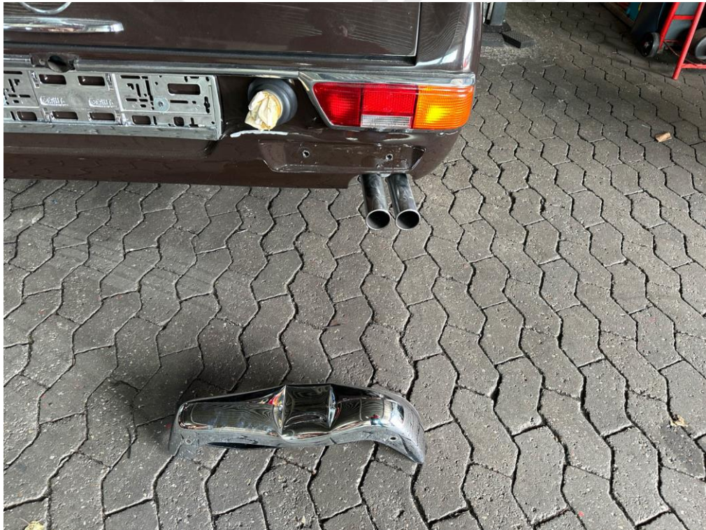
Das Heckblech ist rechtsseitig eingedrückt und beschädigt
