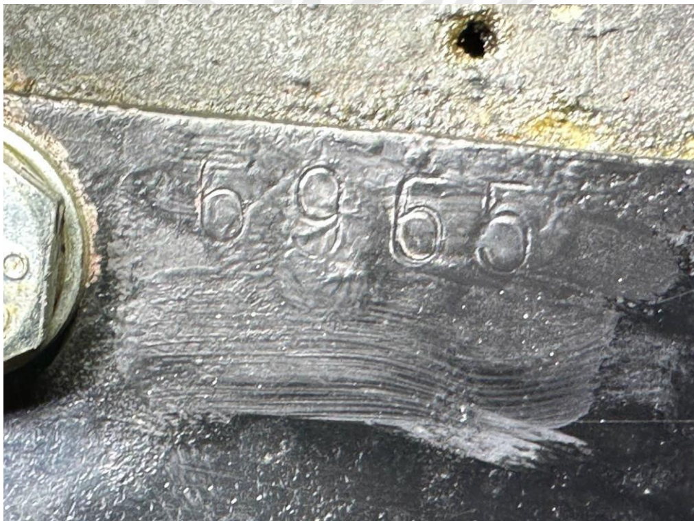
Getriebeverstärkung 6965 die Prägung entspricht dem Eintrag in der Datenkarte für die Aufbaunummer
