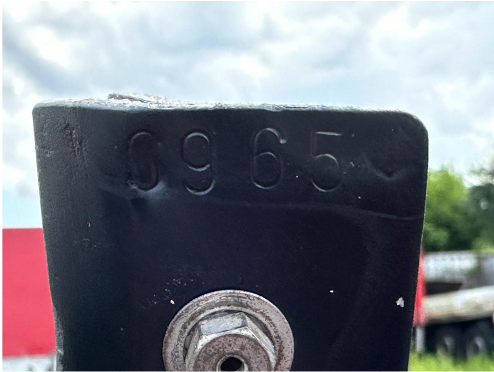
Prägekennzeichnung Karosserienummer Verdeckkastendeckel 6965
