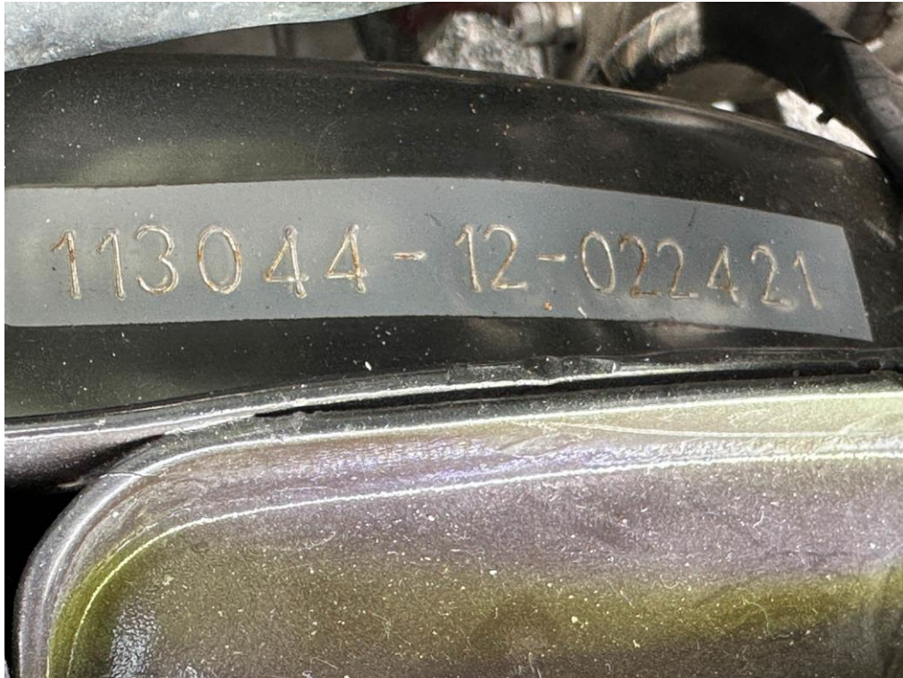
Prägekennzeichnung der Fahrgestellnummer 113.044-12-022421
