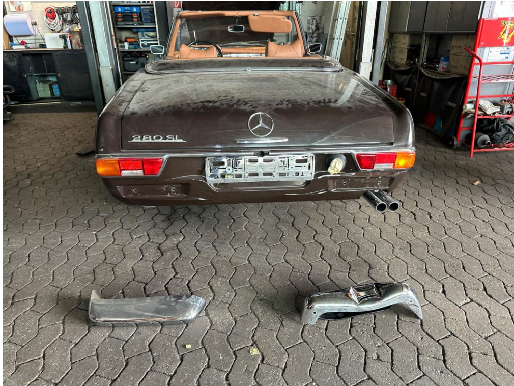
Die Stoßfängerheckpartie sind demontiert
