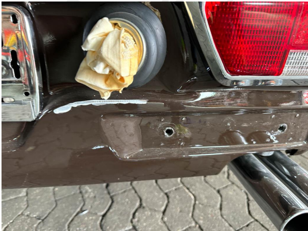
Der Tankverschluss fehlt
