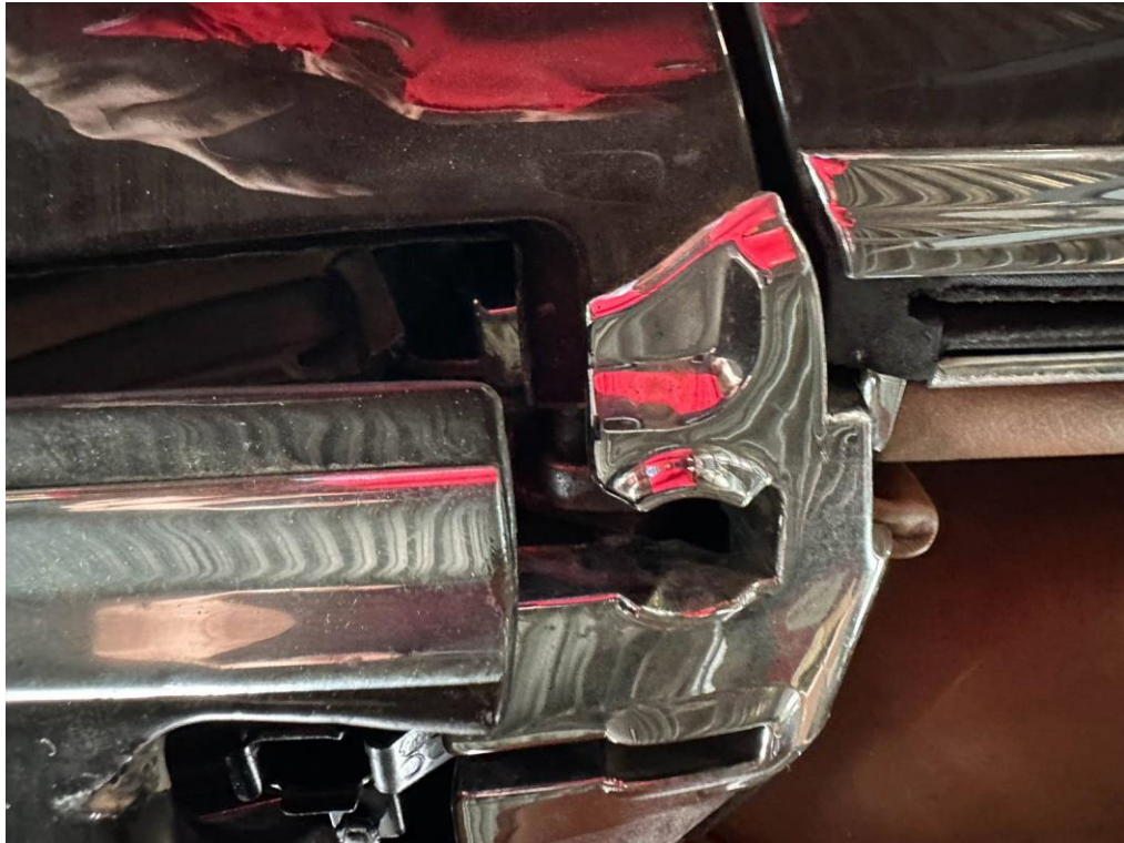
Frontblech und Motorhabenkante sind stark eingedrückt
