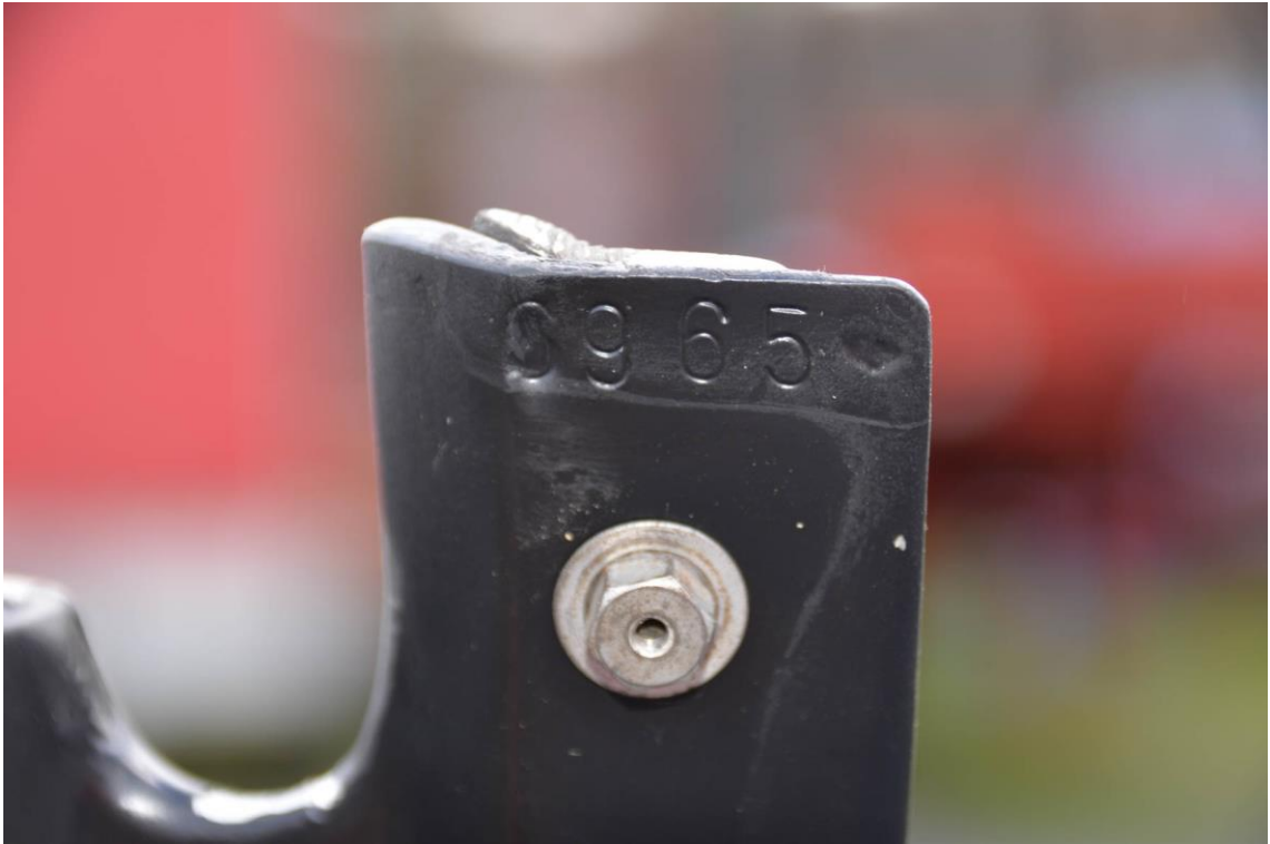
Verdeckkasten 6965 die Prägung entspricht dem Eintrag in der Datenkarte für die Aufbau- nummer
