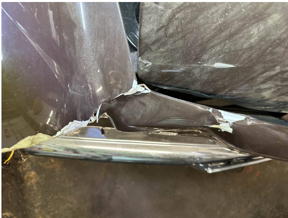
Die Motorhaubenecke ist beschädigt
