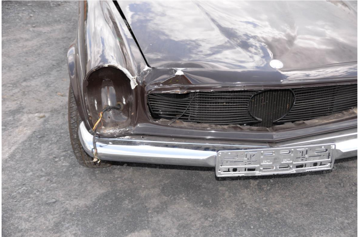
Die Frontpartie rechtsseitig ist stark eingedrückt und verformt
