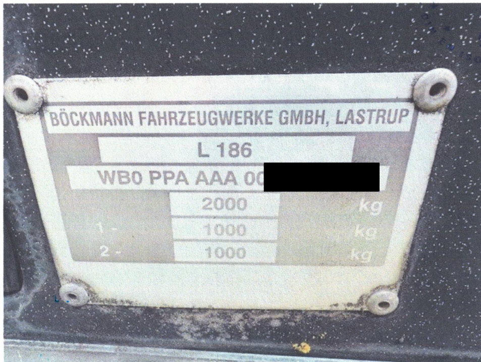
Bild 7 Fahrgestellnummer laut Typenschild
