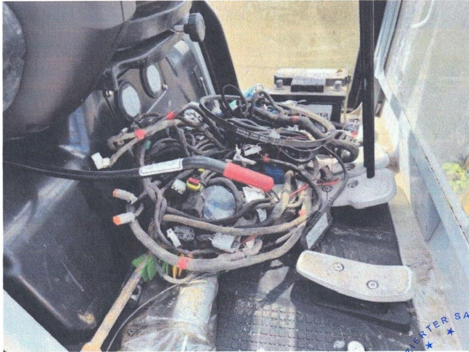
Defekter Kabelbaum im Fahrgastraum
