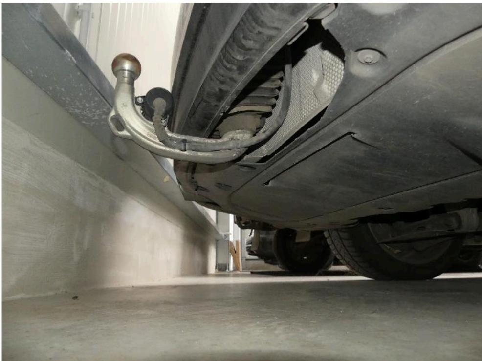
Bild: 36 Ausweisung schwenkbare AHZV.
