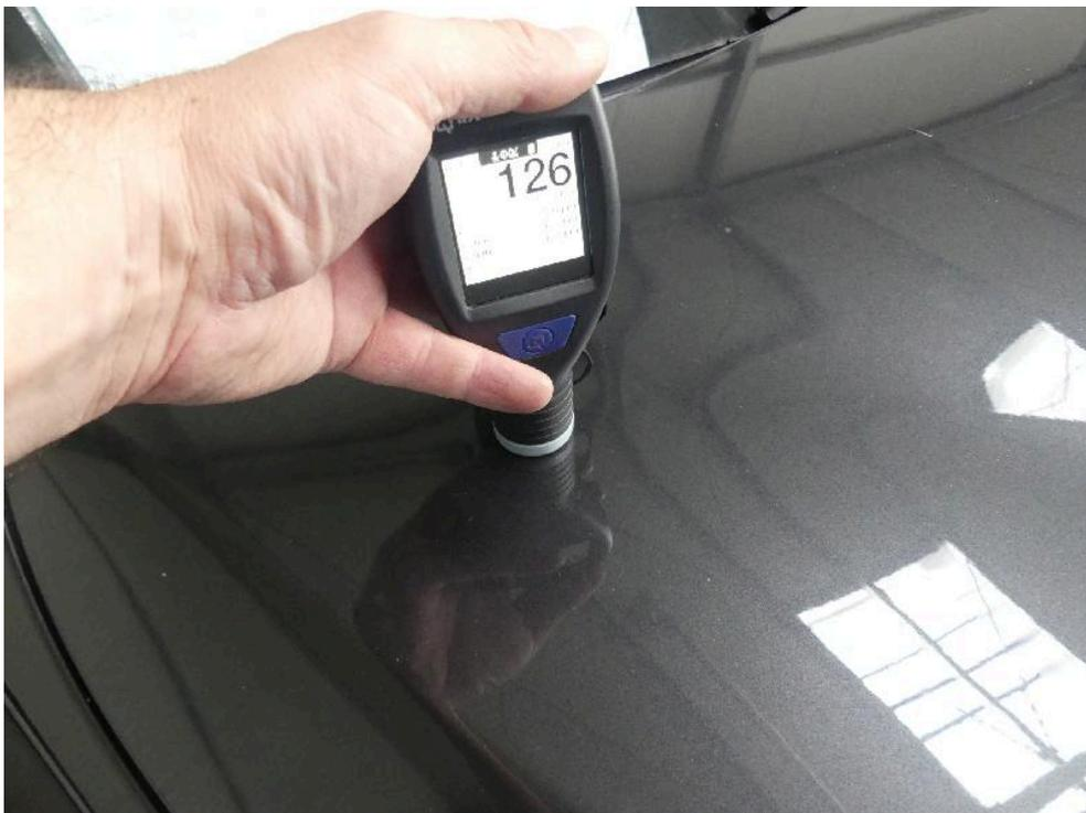
Bild: 40 Ausweisung Lackschichtdickenmessung vorgenommen, Messwerte dem beiliegenden Protokoll entnehmen.
