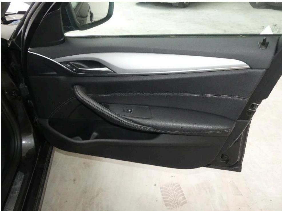
Bild: 32 Ansicht Türverkleidung vorn rechts
