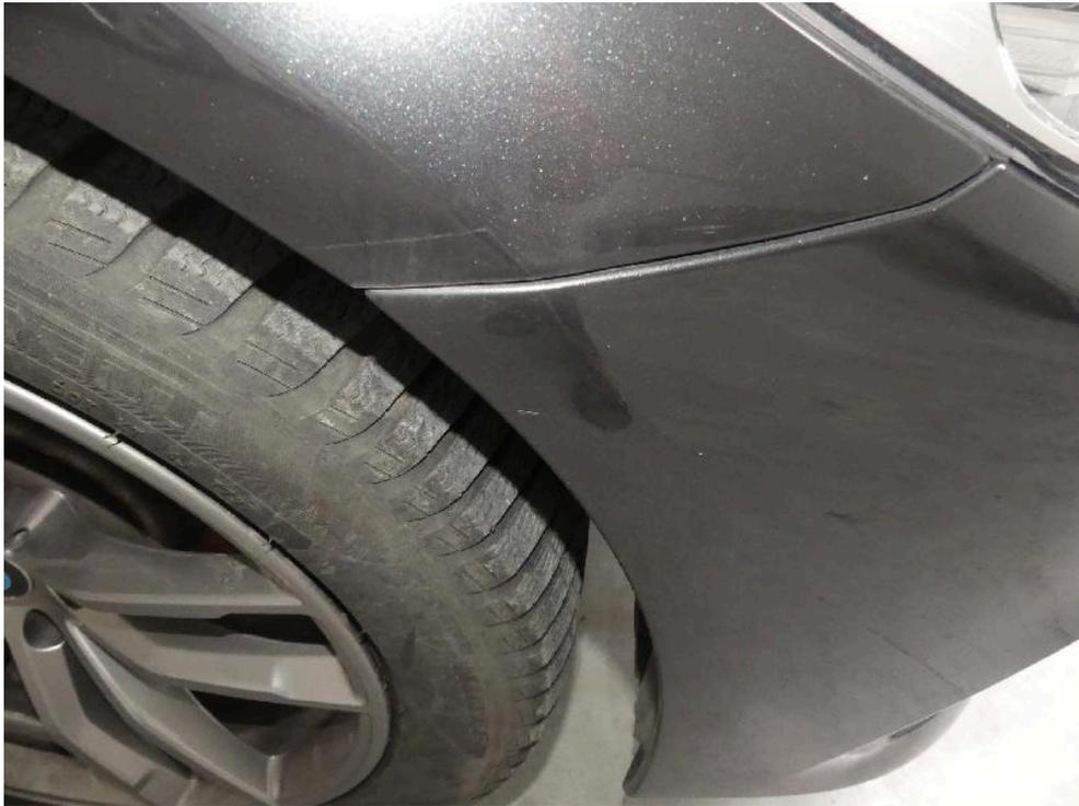
Bild: 41 Kotflügel vorn rechts + Frontverkleidung partiell im Lackaufbau markiert.
