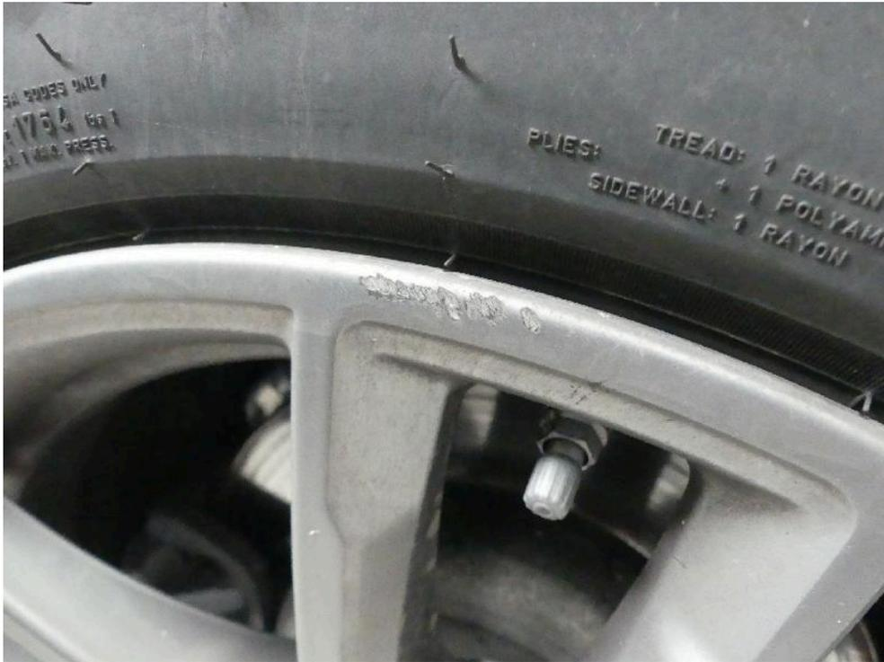
Bild: 15 LM-Felge hinten links beschädigt.
