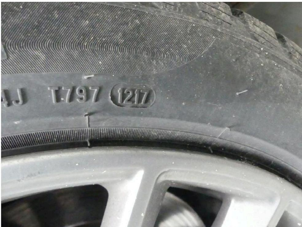
Bild: 16 Ausweisung der DOT Nummer der Radialreifen
