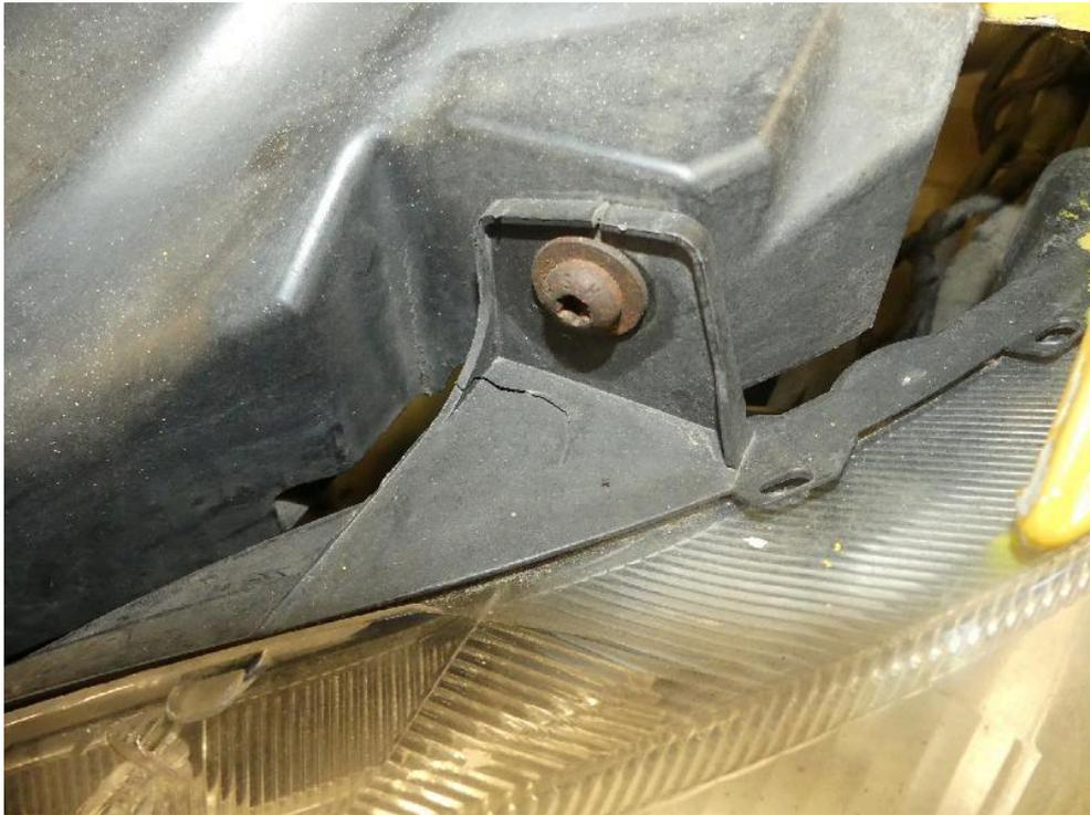
Bild: 40 Hauptscheinwerfer links im Befestigungspunkt angebrochen.
