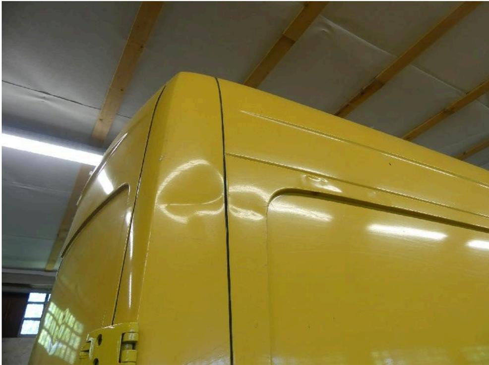
Bild: 68 D-Säule mit Seitenwand rechts gestaucht.
