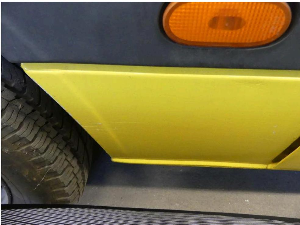
Bild: 67 Seitenwand vorn rechts unterhalb streifend beschädigt.
