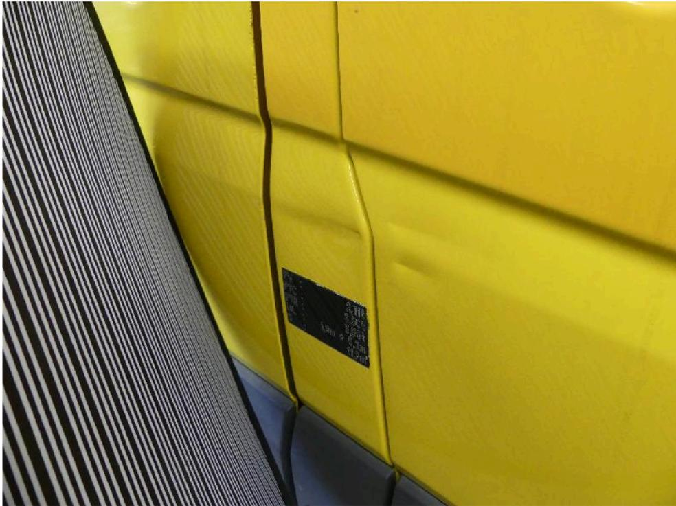
Bild: 66 Beifahrertür und B-Säule deformiert.
