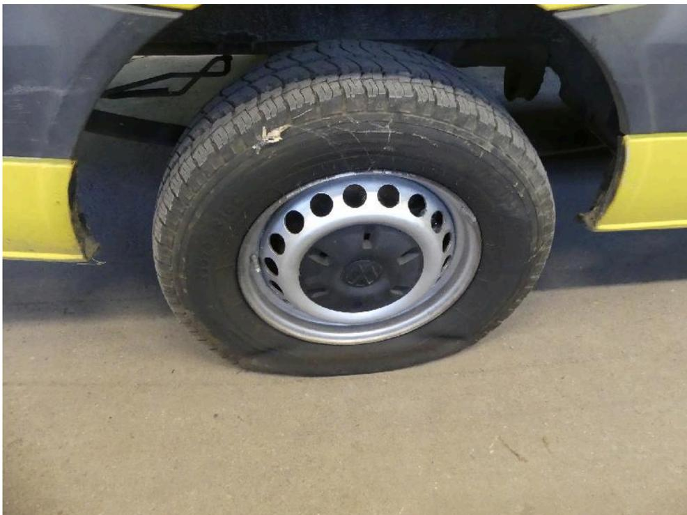
Bild: 59 Ansicht Rad/Reifenkombination hinten rechts, diese ist drucklos.
