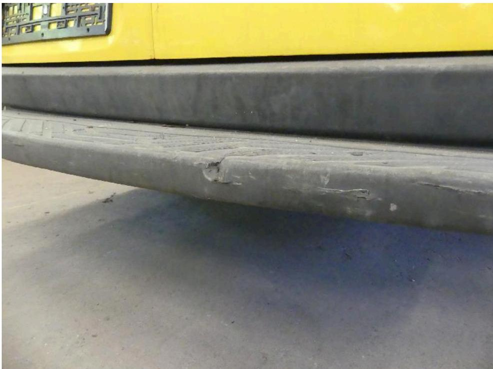
Bild: 45 Trittstufe hinten mehrfach beschädigt.
