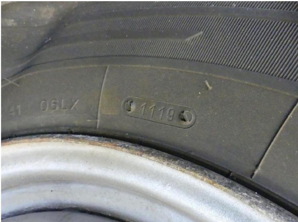
Bild: 63 Ausweisung der DOT Nummer der Radialreifen
