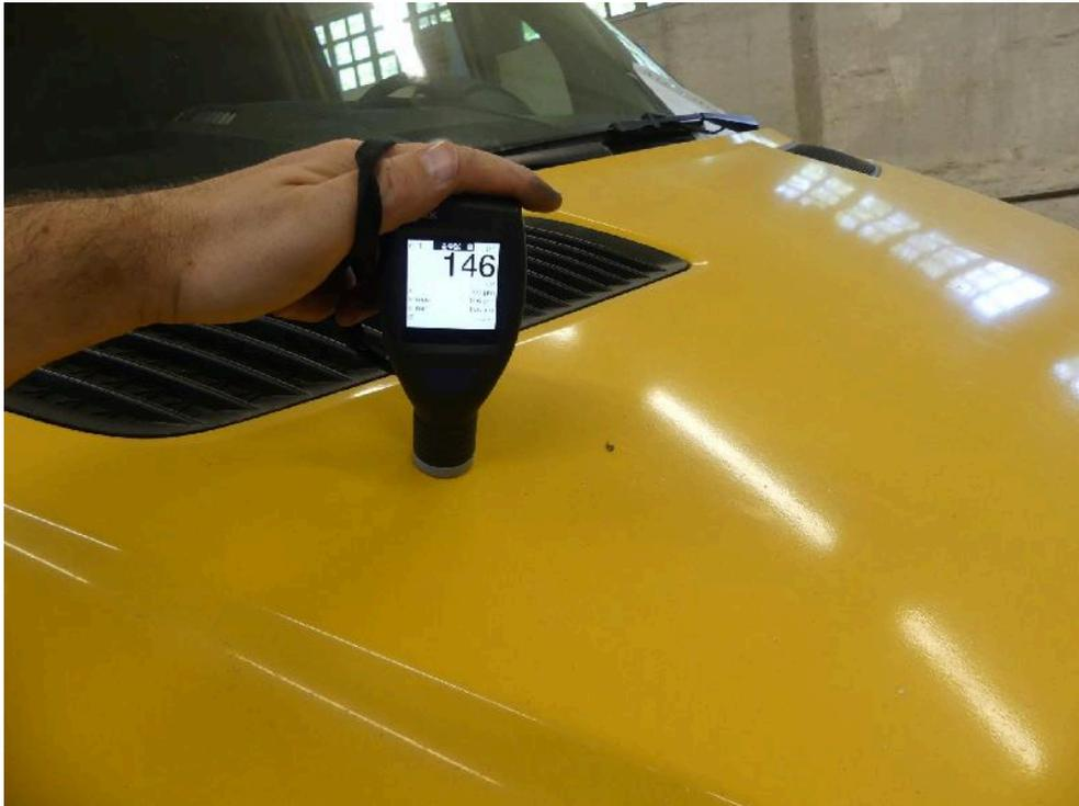
Bild: 64 Ausweisung Lackschichtdickenmessung vorgenommen, Messwerte dem beiliegenden Protokoll entnehmen.
