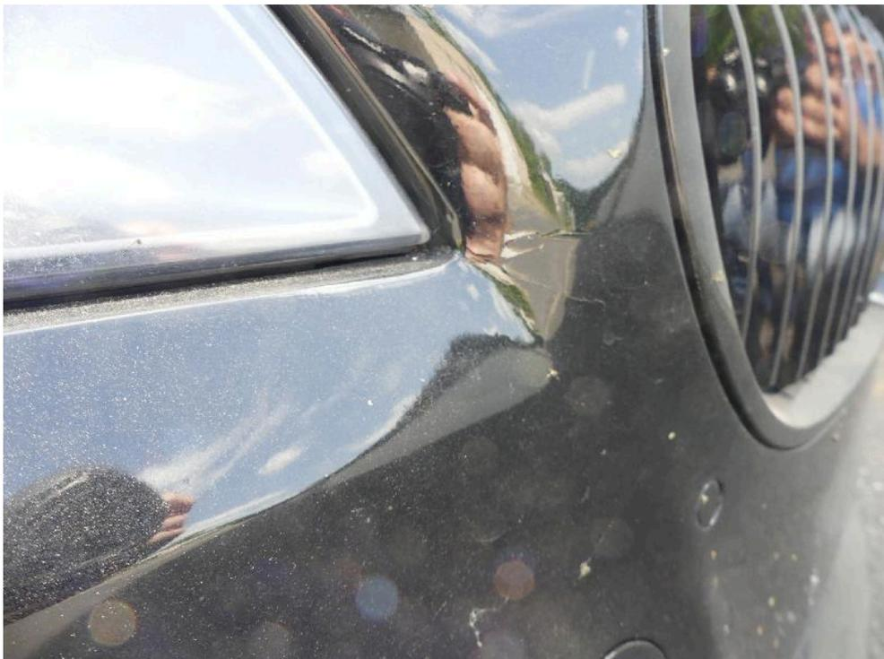
Bild: 50 Weitere Ausweisung Frontverkleidung Materialbruch im Bereich der rechts Hauptscheinwerfers.
