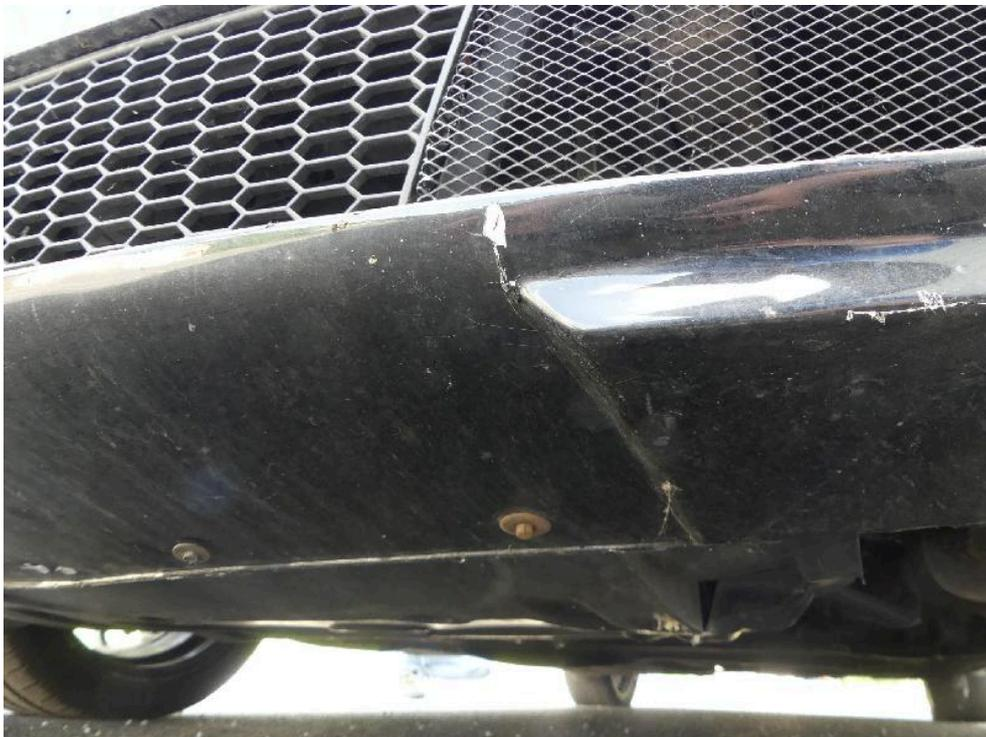
Bild: 46 Weitere Darstellung mit Ausweisung Beschädigung Frontverkleidung.
