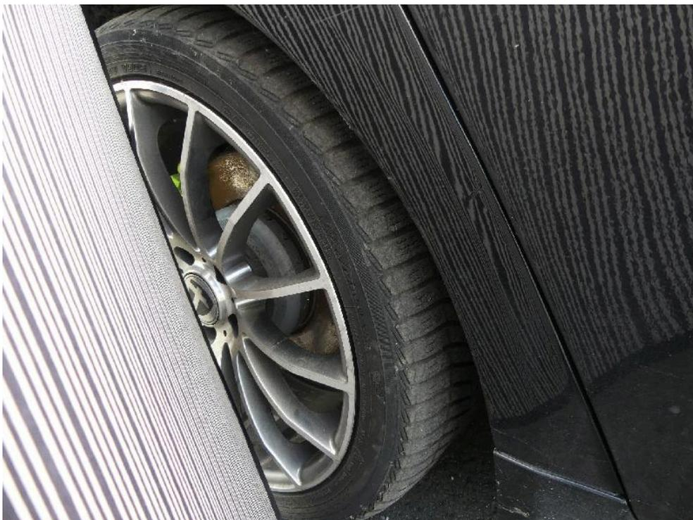
Bild: 61 Detailansicht Radlaufbogen, dieser ist noch sichtbar verworfen.
