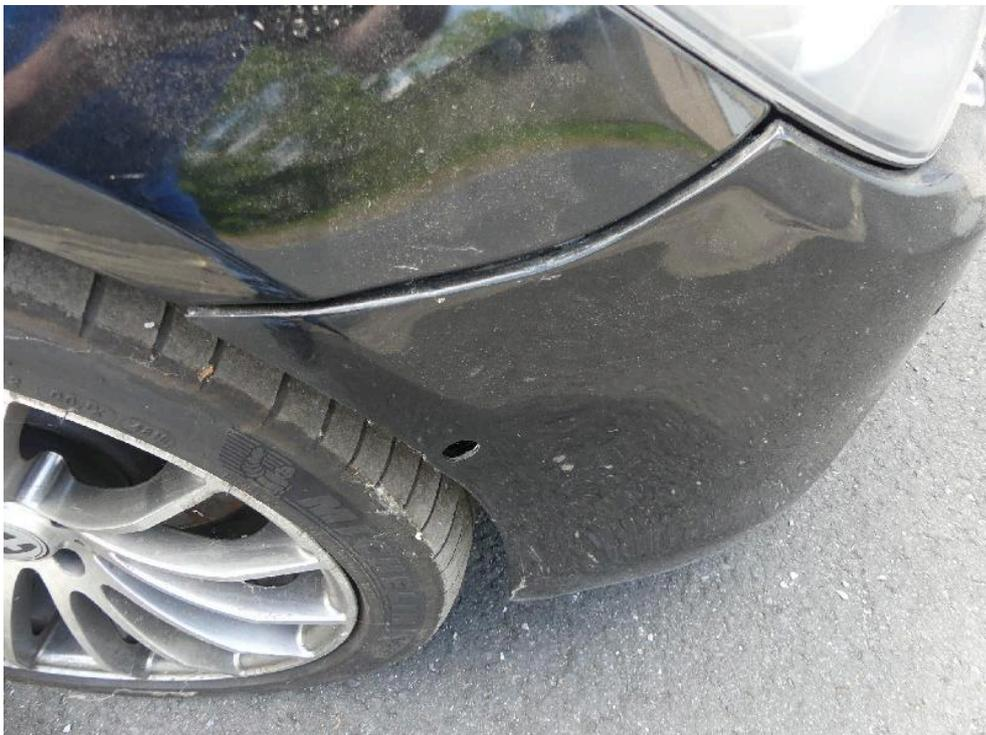
Bild: 52 Einbaulage Frontverkleidung rechts versetzt.
