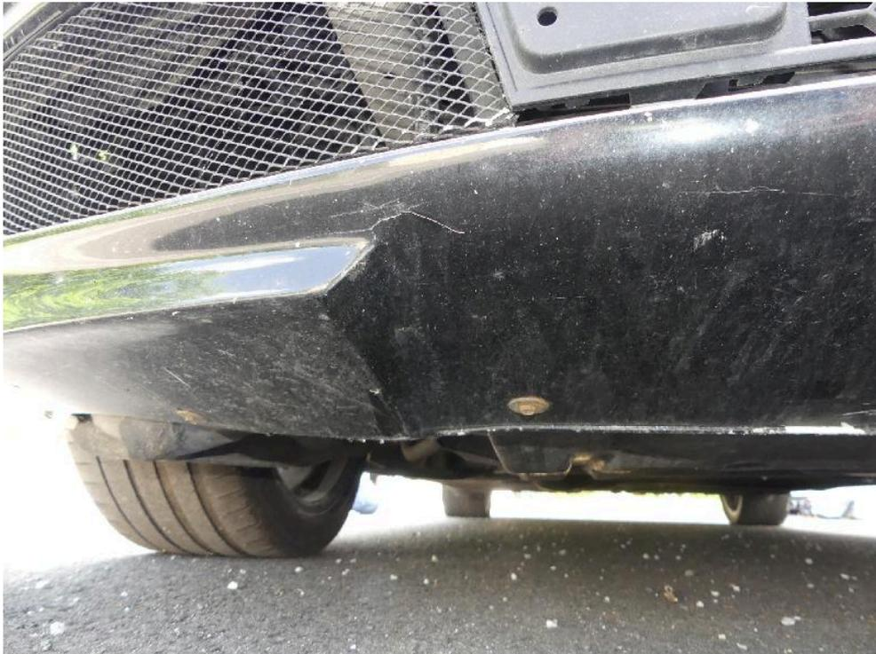
Bild: 47 Ansicht Frontverkleidung, rechtsseitig ist das Grundmaterial gerissen / gebrochen.
