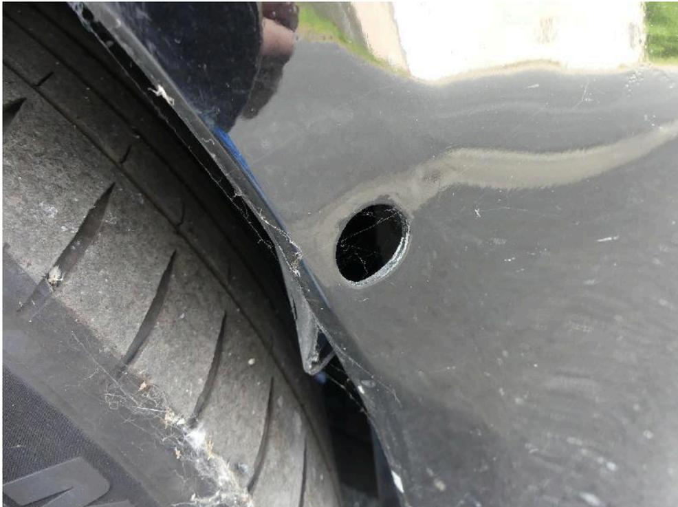
Bild: 53 Sensor Frontverkleidung außen rechts fehlt.
