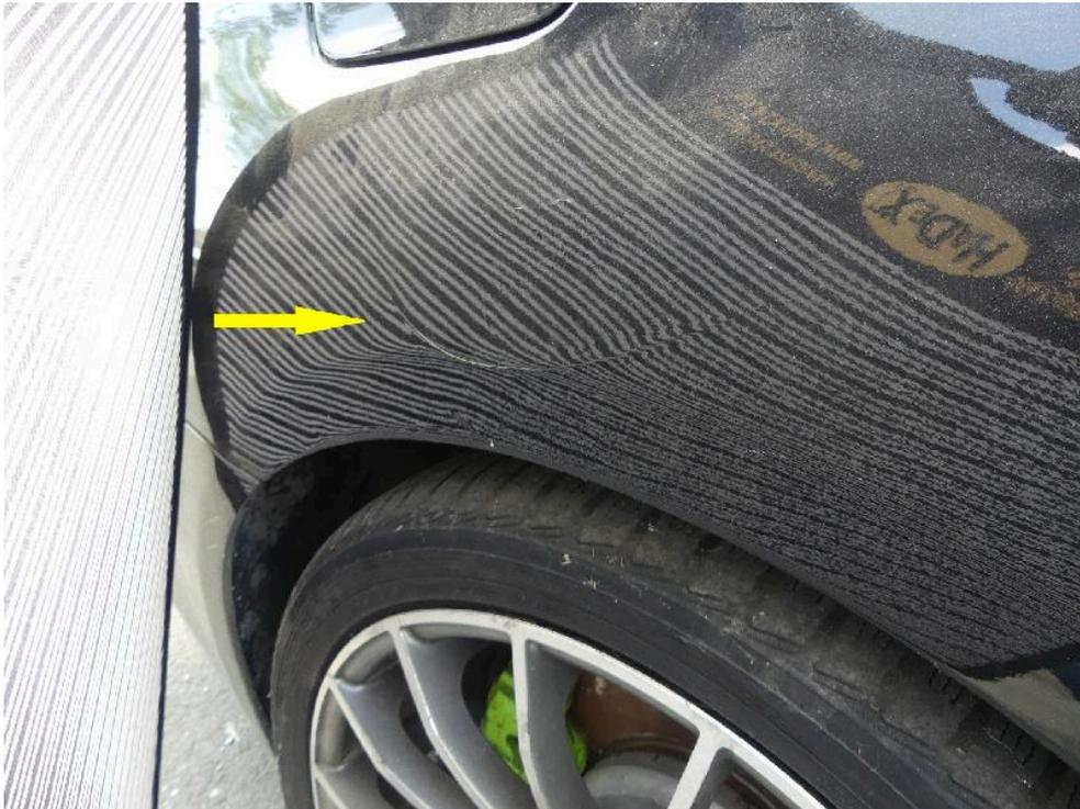
Bild: 59 .... Aufgrund der Instandsetzung, ist der Kunststoffspachtel gerissen.
