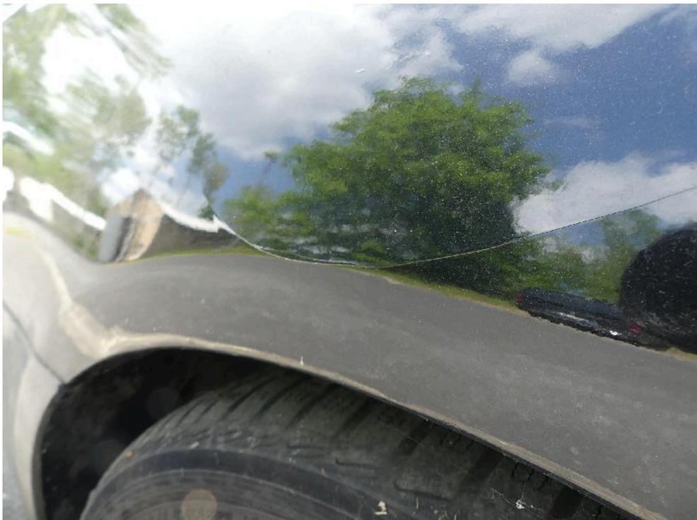
Bild: 60 Detailansicht Seitenwand rechts, hierbei ist der Kunststoffspachtel gerissen.
