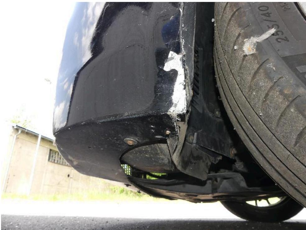
Bild: 41 ... partiell ist die Frontverkleidung im unteren Segment gestaucht.
