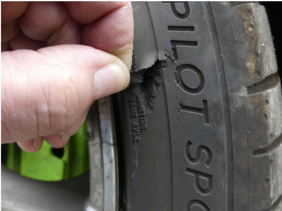
Bild: 37 Reifenflanke sichtbar beschädigt.
