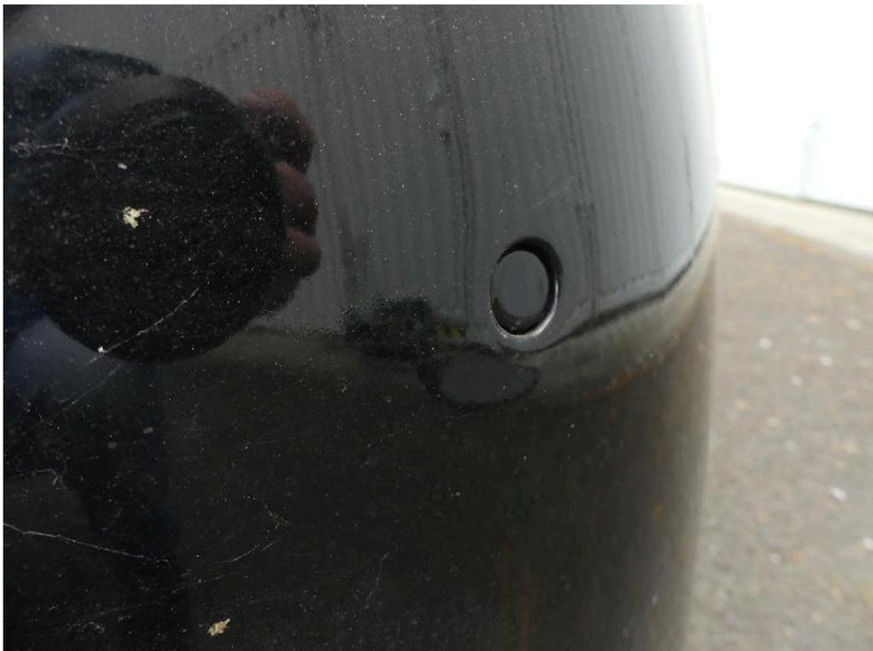
Bild: 44 Einbaulage PDC-Sensor außen links verändert.
