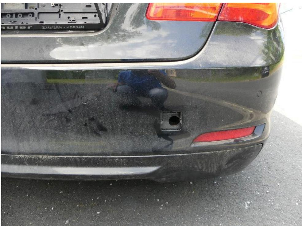
Bild: 62 Detailansicht Heckverkleidung, Abdeckung Abschleppöse fehlt.
