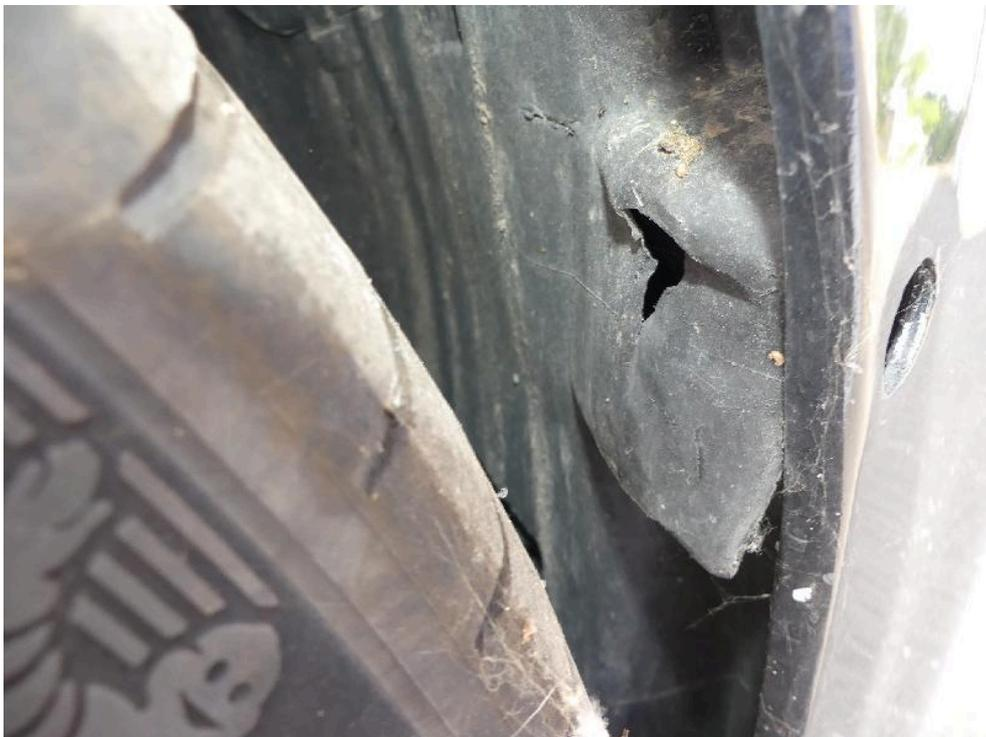
Bild: 54 Weiterführend ist die Radhausverkleidung rechts beschädigt.
