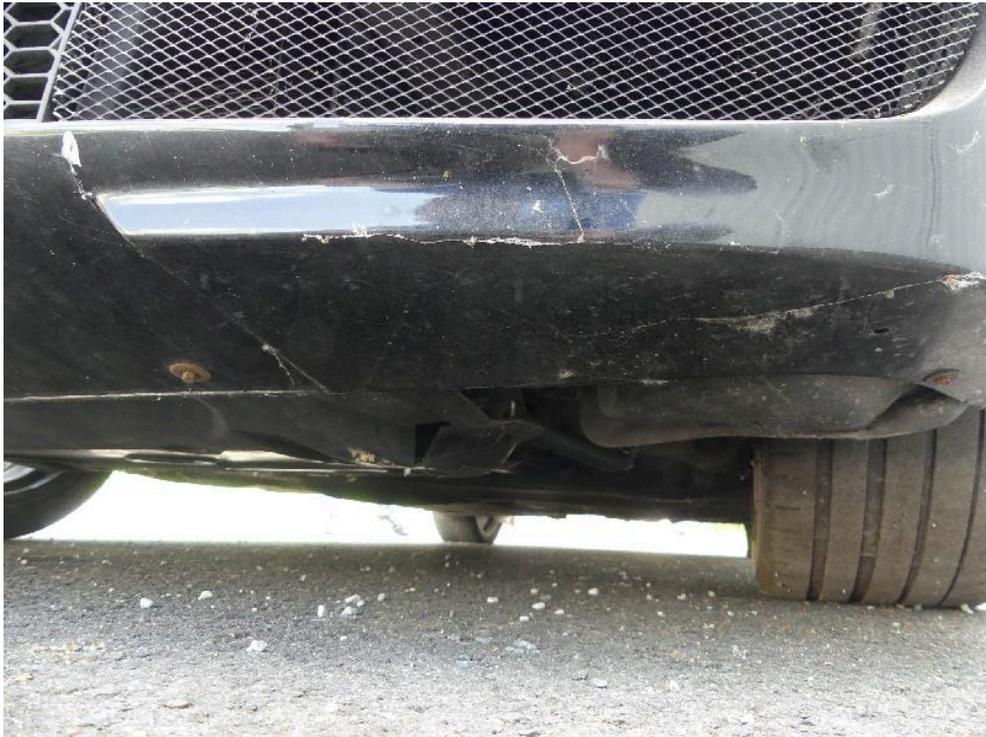
Bild: 45 Weitere Ansicht Frontverkleidung, diese ist im unteren linken Segment beschädigt.
