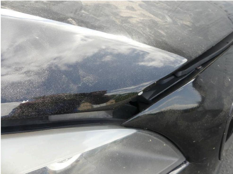
Bild: 57 Der Lackaufbau der Motorhaube ist partiell abgetragen.
