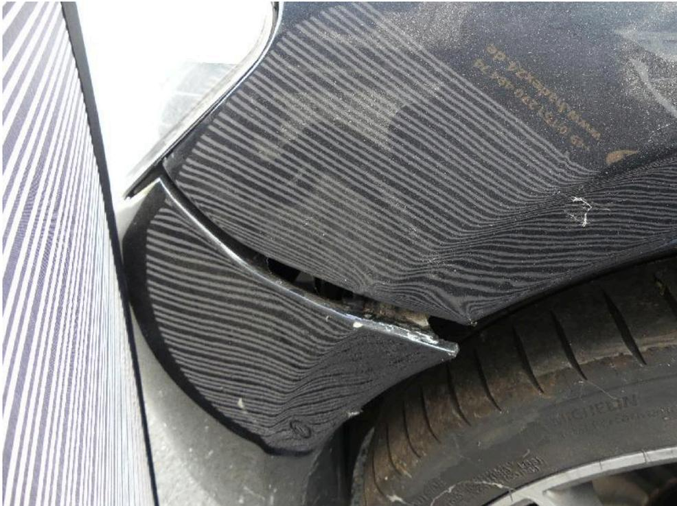
Bild: 43 Weiterführend ist der Kotflügel in deformiert und bleibend verworfen.
