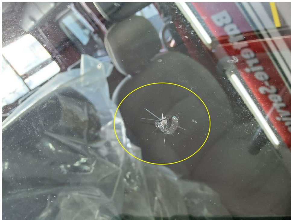
Bild 13 : Windschutzscheibe - Steinschlag mit Rissbildung
