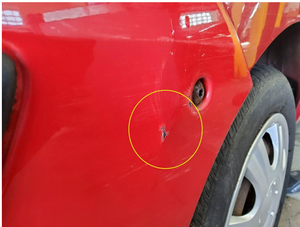
Bild 17 : Stoßfänger hinten verschrammt mit Materialabtrag
