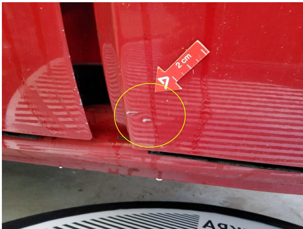
Bild 21 : Türe hinten links mehrfach eingedellt
