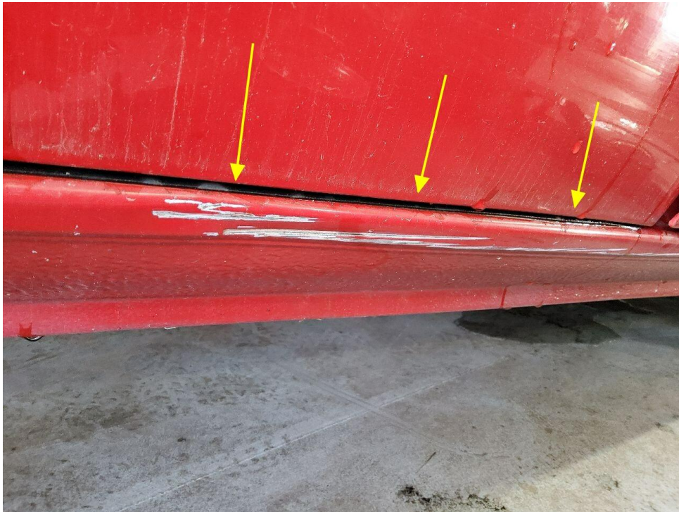
Bild 15 : Schweller rechts eingedrückt und verschrammt
