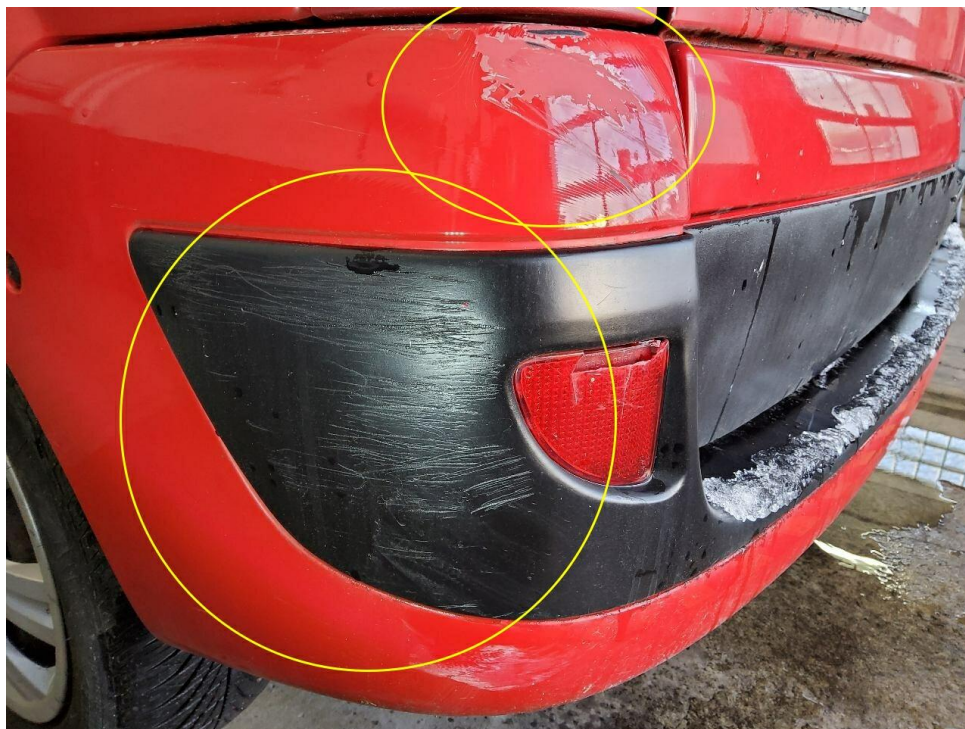
Bild 19 : Stoßfänger hinten verschrammt mit Materialabtrag
