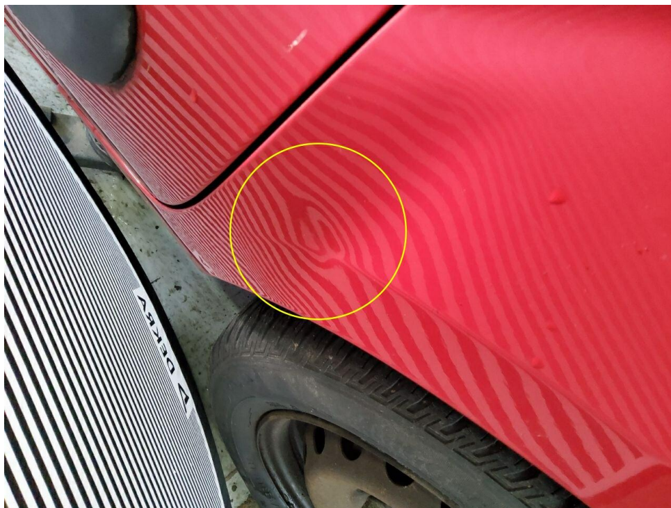
Bild 14 : Kotflügel rechts eingedellt
