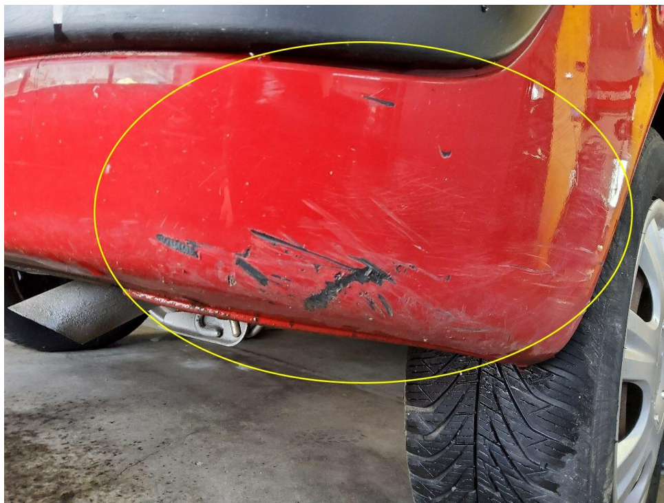
Bild 18 : Stoßfänger hinten verschrammt mit Materialabtrag
