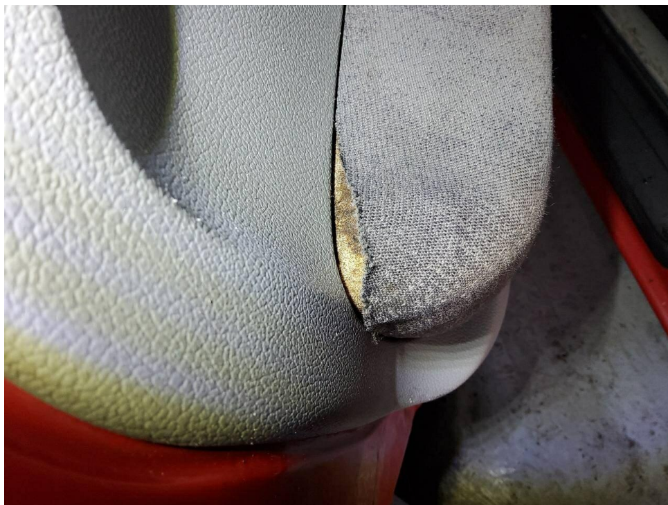
Bild 5 : Türverkleidung vorne rechts gerissen
