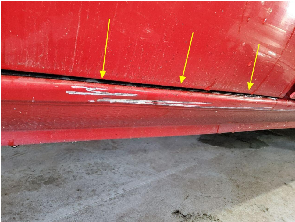
Bild 15 : Schweller rechts eingedrückt und verschrammt
