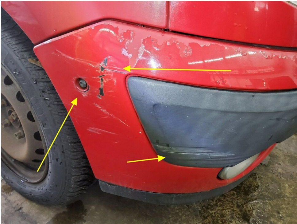
Bild 11 : Vordere Stoßfänger rundrum verschrammt und teils gebrochen
