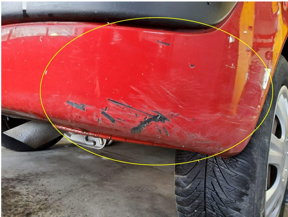
Bild 18 : Stoßfänger hinten verschrammt mit Materialabtrag
