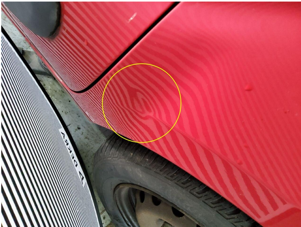
Bild 14 : Kotflügel rechts eingedellt
