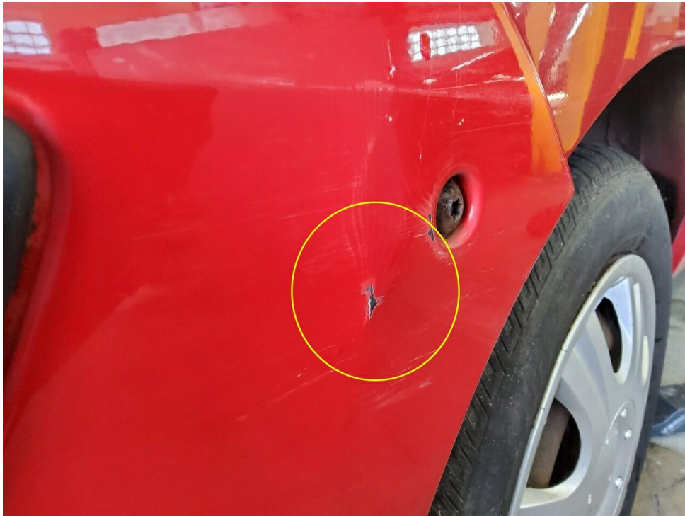
Bild 17 : Stoßfänger hinten verschrammt mit Materialabtrag
