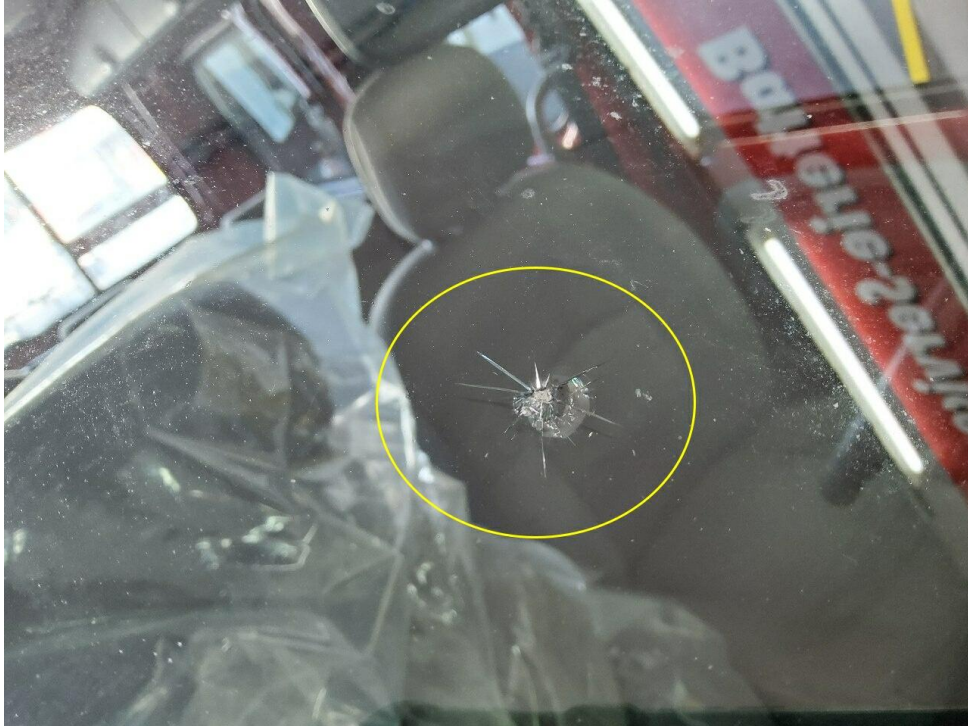
Bild 13 : Windschutzscheibe - Steinschlag mit Rissbildung
