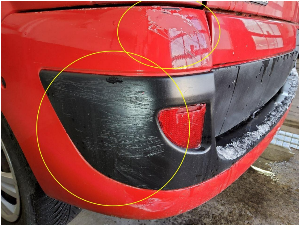
Bild 19 : Stoßfänger hinten verschrammt mit Materialabtrag
