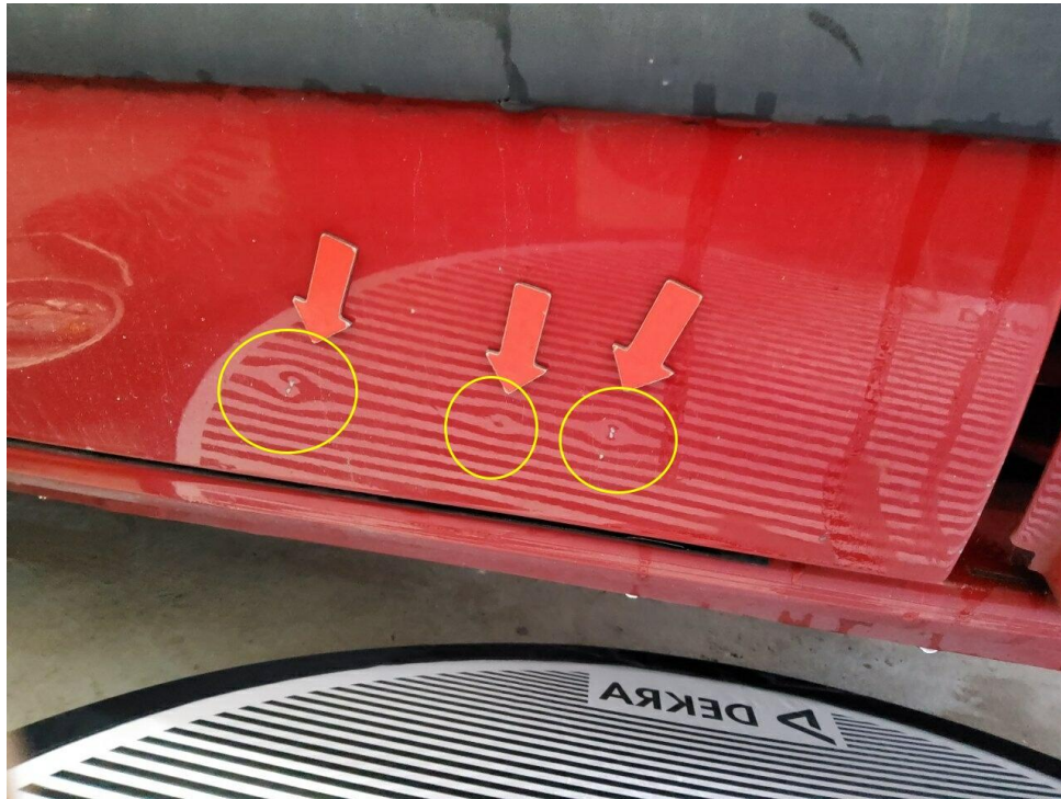
Bild 7 : Türe vorne links mehrfach eingedellt
