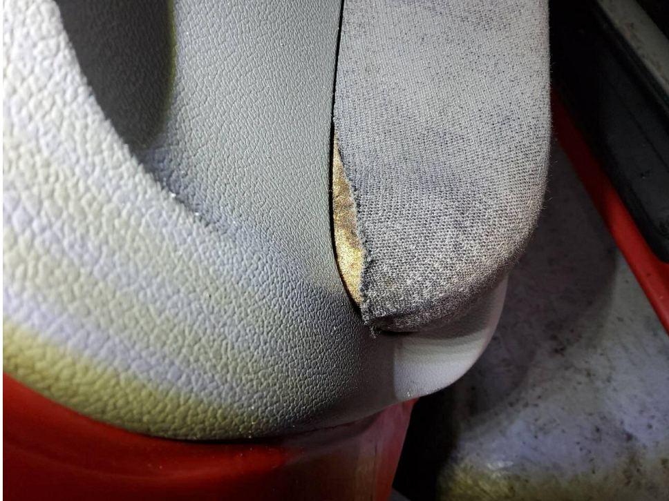
Bild 5 : Türverkleidung vorne rechts gerissen
