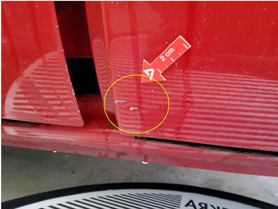
Bild 21 : Türe hinten links mehrfach eingedellt
