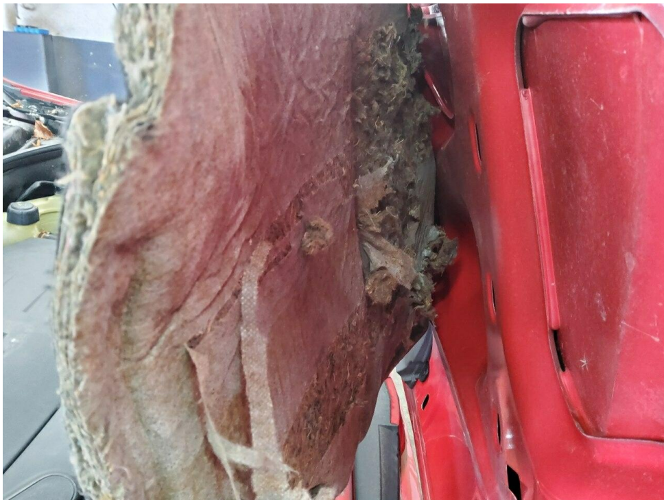
Bild 12 : Motorhaubendämmung lose bzw. eingerissen
