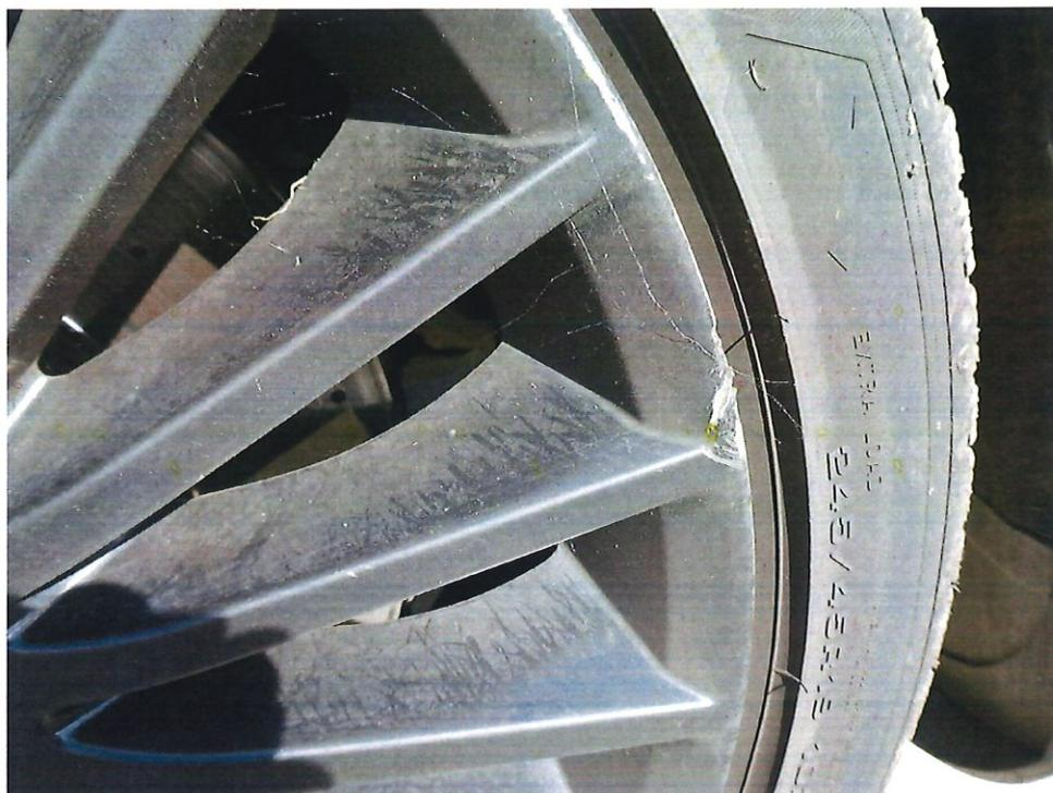
Bild 7 : LM-Felge vo. rechts beschädigt , Substartverlust am Felgenhorn
