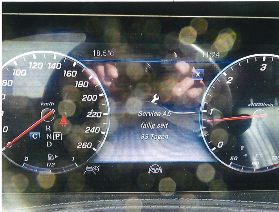
Bild 5 : Wartungsnachweis Service A 5 lt. dynamischer Anzeige fällig
