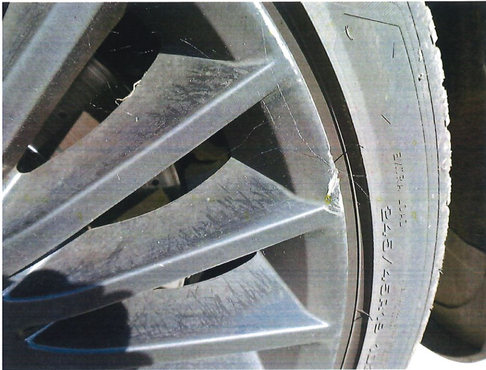
Bild 7 : LM-Felge vo. rechts beschädigt , Substartverlust am Felgenhorn
