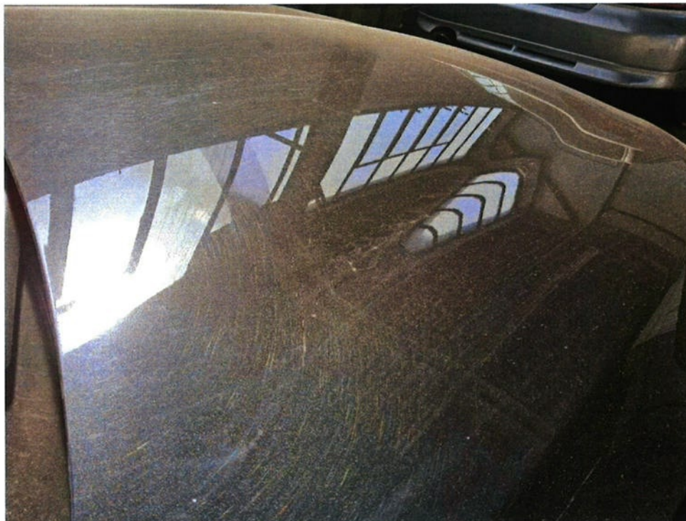
Bild 8 : Lackierung teilweise verkratzt
